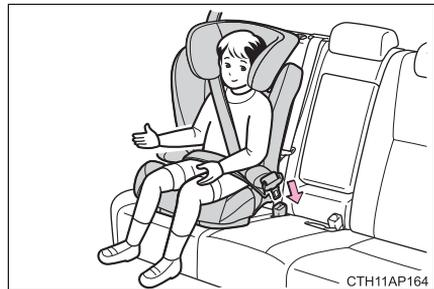
Compruebe que el cinturón de seguridad del hombro está correctamente colocado sobre el hombro del niño y que el cinturón de seguridad de la cintura está ajustado lo más bajo posible. (→P. 38)
