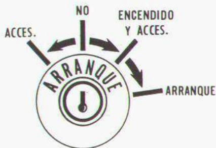
**Llave en posición vertical:** sistema eléctrico desconectado.
