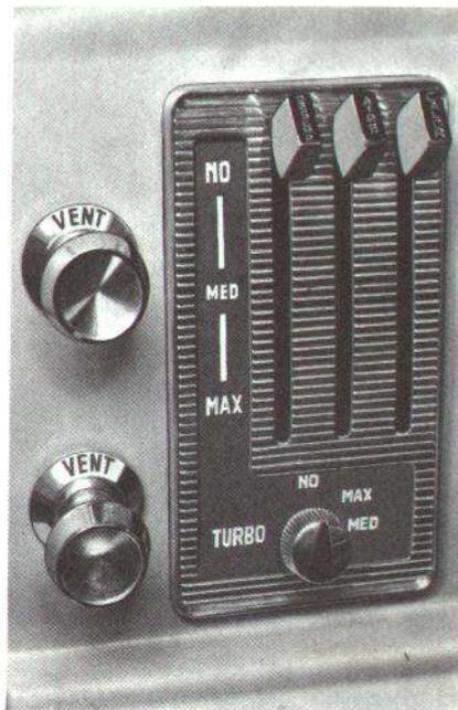
Llevando la palanca (Desempañador) hacia abajo, una corriente de aire caliente sale por las rejillas en la parte superior del panel de instrumentos, para desempañar el cristal del parabrisas. La corriente de aire en ciertas ocasiones, incluso fría es eficaz para el desempañado.
