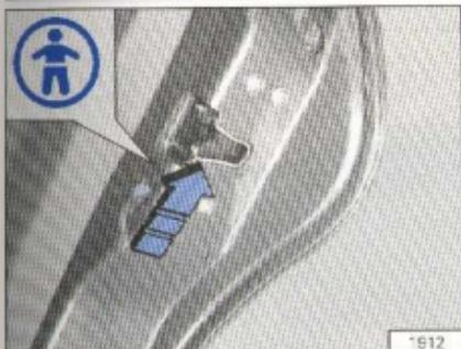
Las puertas traseras se pueden bloquear desplazando la palanca, próxima a la cerradura, como se indica en el dibujo (flecha). Esto impide que las puertas se puedan abrir desde el interior del vehículo.
