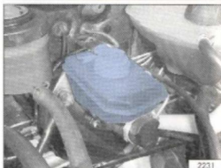
El depósito del líquido de frenos se encuentra ubicado contra el parallama, lado del conductor.
