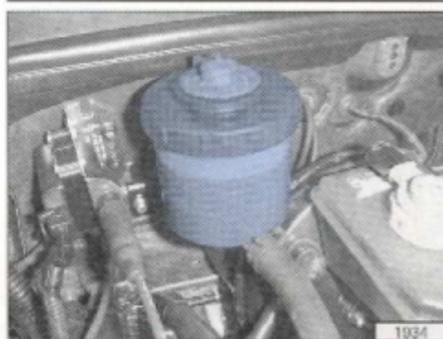
Con el vehículo nivelado, el motor detenido y las ruedas alineadas, el nivel de líquido de dirección de potencia debe estar entre las marcas MIN. y MAX. del depósito. Ver figura.
