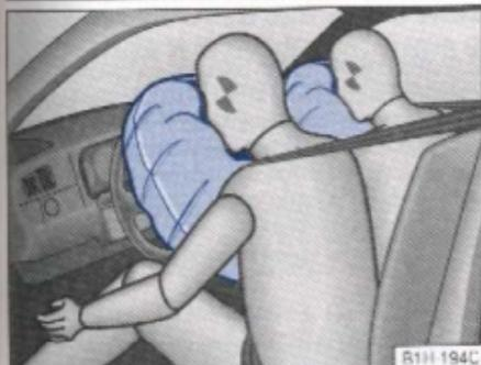
La bolsa de aire desarrollada especialmente permite, bajo carga, la salida controlada del gas para recoger suavemente la cabeza y el tórax. **Después del accidente, la bolsa de aire se ha vaciado tanto que ya no estorba la visibilidad.**
