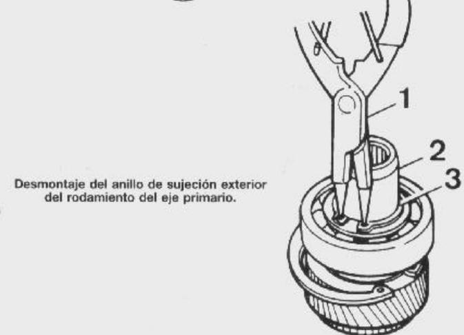
Desmontaje del anillo de sujeción exterior del rodamiento del eje primario.
