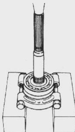
Desmontaje del rodamiento del eje de salida trasero.
