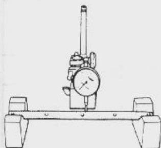
Control del salto del eje de balancines.
