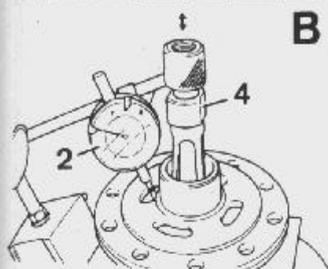
**Nota:** Para el control de la precarga, no montar ni el retén ni la arandela.
