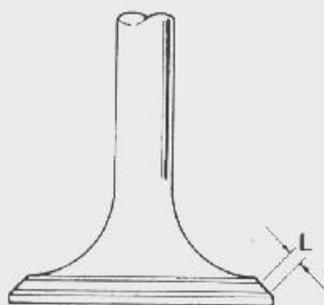
Control del ancho de asiento de una válvula
