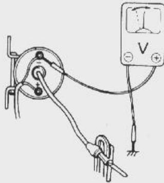
Conexión del voltímetro para control del captador.
