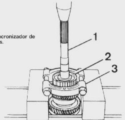
Desmontaje del rodamiento trasero de eje secundario.
