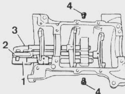
**Ensamblado de los ejes de horquillas.**
