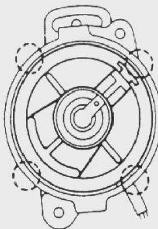
Posición del rotor antes de colocar el distribuidor de encendido.
