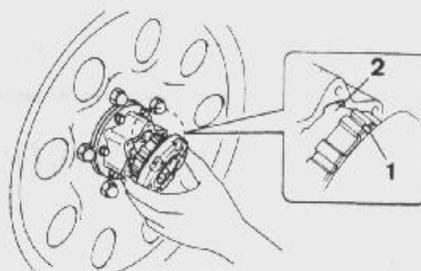
Ensamblado de un cubo desembragable manual
