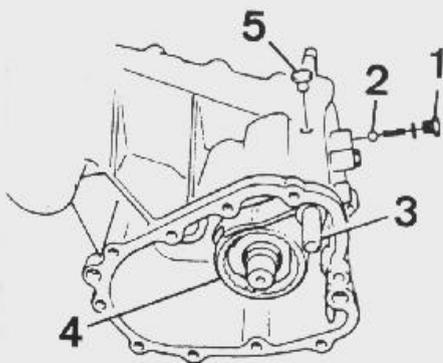
Desmontaje del eje de cambio de gama.
