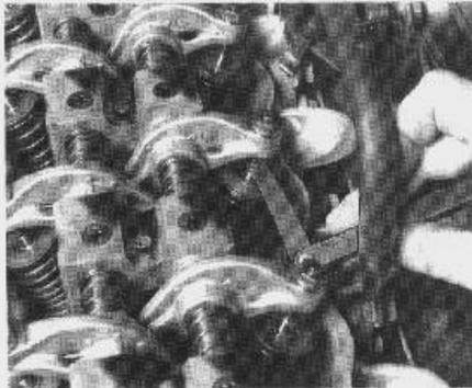
Medición del juego de las válvulas (motor de 8 válvulas)
