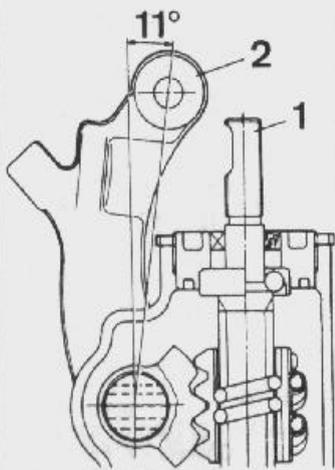
Posicionado de la bieleta de mando para control del par de rotación del eje de entrada.
