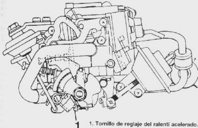
1. Tornillo de reglaje del ralentí acelerado.
