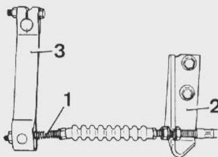
**Desmontaje del cable de embrague**
