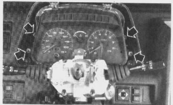
Tornillos de fijación del cuadro de instrumentos.
