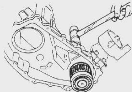
Desmontaje del eje de salida delantero.
