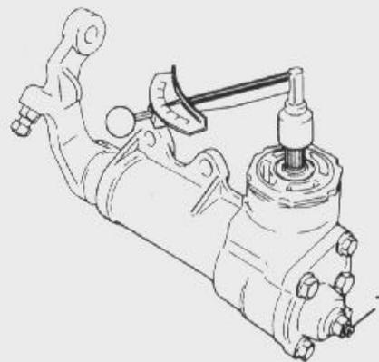
Control del par de rotación del eje de entrada.
