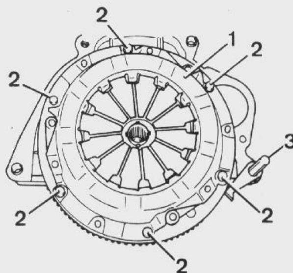
Desmontaje del mecanismo o del disco.
