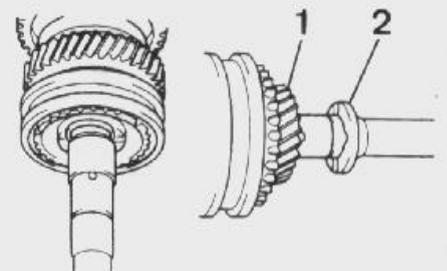
Ensamblado del eje secundario.
