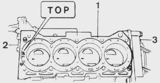
Montaje de la junta de culata
