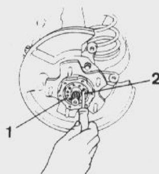
Desmontaje de la chapa de retención de una tuerca de cubo.
