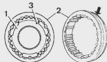
Ensamblado del cubo de garras de cambio a cuatro ruedas motrices.
