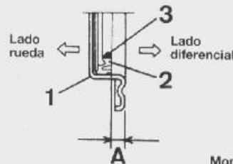
Montaje del retén en la placa de retención.
