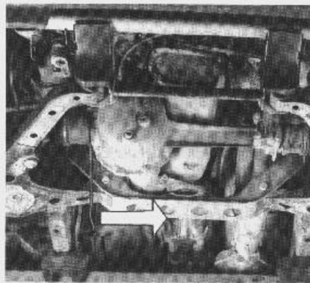
Separación del semieje derecho del puente con ayuda de una palanca.
