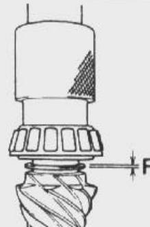
Montaje con prensa del rodamiento de piñón de ataque.
