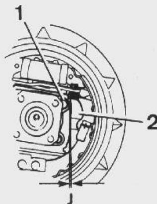
Desmontaje de un semieje trasero.
