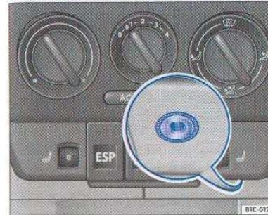
Fig. 53 Consola central: terminal de conexión adicional
