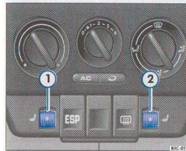
Fig. 38 Consola central: ruedecillas moleteadas para la calefacción de los asientos delanteros
