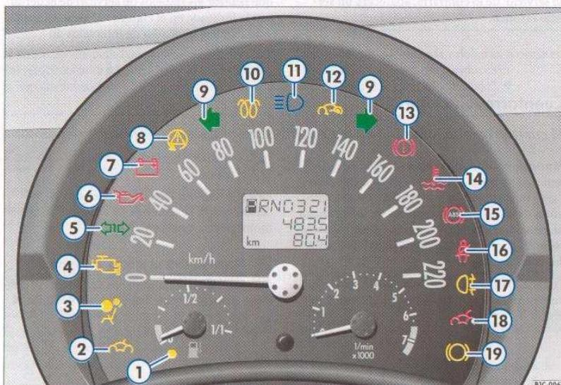
Fig. 4 Testigos de control y de advertencia del cuadro de instrumentos. Algunos de estos testigos sólo están disponibles con determinadas versiones del modelo o forman parte de equipamientos opcionales.
