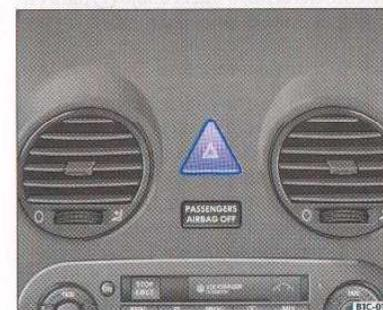
Fig. 22 Tablero de instrumentos: conmutador de los intermitentes de emergencia
