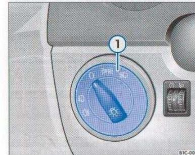
Fig. 19 Detalle del tablero de instrumentos: mando de las luces, faros antiniebla y luz antiniebla trasera
