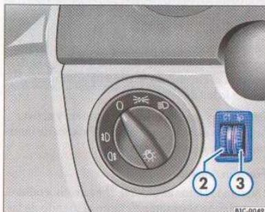
Fig. 20 Detalle del tablero de instrumentos: reguladores de la iluminación de instrumentos y mandos
