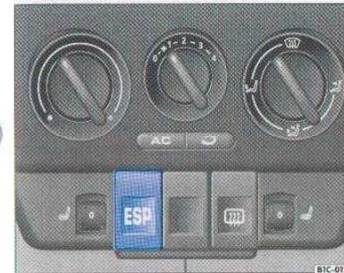
Fig. 65 Consola central: tecla ESP
