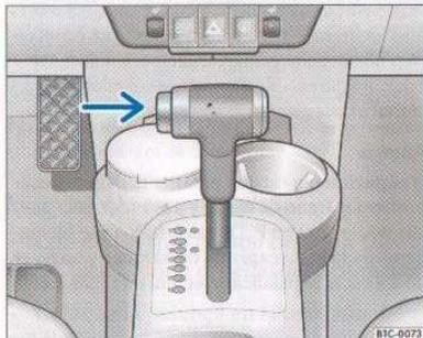
Fig. 68 Consola central: palanca selectora del cambio automático
