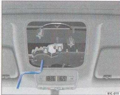
Fig. 18 Detalle del guarnecido del techo: manivela para el accionamiento de emergencia
