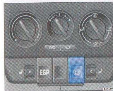
Fig. 31 Consola central: mando para la luneta térmica
