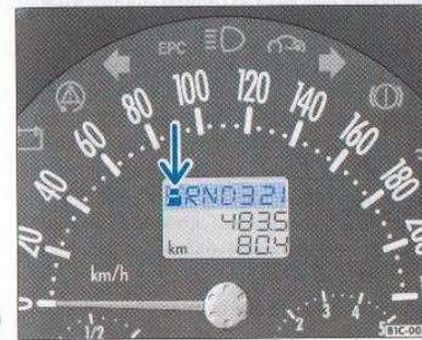
Fig. 69 Cuadro de instrumentos: indicador de posición de la palanca selectora
