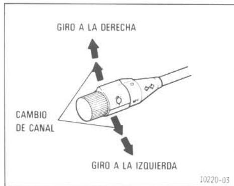
**Para señalar los giros, mueva la palanca hacia arriba o hacia abajo de la manera convencional.**
