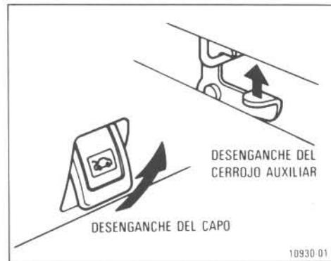
Para abrir el capó del motor, tire de la palanca de desenganche del cierre del capó que hay debajo del tablero. El capó se abrirá un poco mediante su resorte. Vaya delante del vehículo, presione hacia arriba la palanca del cerrojo auxiliar y levante el capó.
