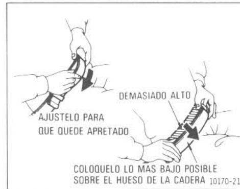
Acorte el exceso de longitud del cinturón y ajuste la posición del cinturón de la cadera.
