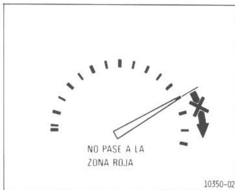
El tacómetro indica la velocidad del motor en miles de rpm (revoluciones por minuto). Uselo mientras maneja para seleccionar los puntos de cambio correctos y para evitar el arrastre y la sobreaceleración del motor.
