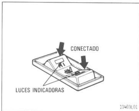
Para conectar el calefactor del asiento del conductor, empuje el interruptor a "HI" (temperatura de calefacción alta) o "LO" (temperatura de calefacción baja).
