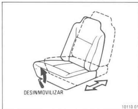
**Tire de la palanca de desinmovilización hacia arriba. Luego deslice el asiento hasta la posición deseada, presionando ligeramente con el cuerpo, y suelte la palanca.**
