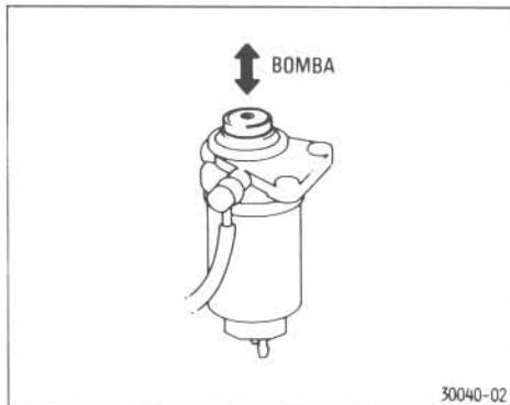
**Si se le acaba el combustible y el motor se para, puede ocurrir que el motor no arranque después de echar combustible. En tal caso, accione la bomba de cebado hasta que sienta más resistencia.**
