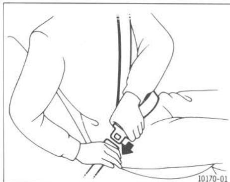
Ajuste el asiento como sea necesario y siéntese recto en posición vertical en el asiento. Para abrocharse el cinturón, sáquelo del retractor e inserte la lengüeta en la hebilla.
