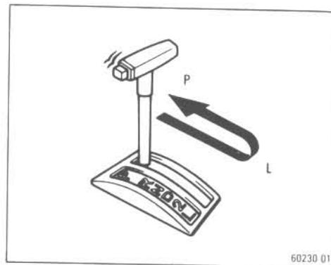
1. Compruebe el nivel del fluido solamente cuando la transmisión está caliente (temperatura de funcionamiento normal). Con el vehículo nivelado, aplique primero el freno de estacionamiento y luego arranque el motor. Mientras el motor está marchando en vacío, apriete el pedal del freno y cambie la palanca selectora a cada engranaje desde la "P" a la "L", y vuelva a la "P".
