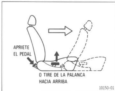
Tire de la palanca de desinmovilización del respaldo hacia arriba o apriete el pedal de suelta—el asiento se desinmovilizará automáticamente hacia adelante.
