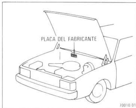
El número de identificación del vehículo aparece en la placa del fabricante instalada en el compartimiento del motor.
