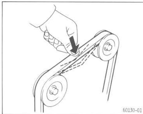
**Inspeccione visualmente el estado de las correas. Compruebe su tensión presionando con el pulgar hacia la mitad entre las poleas.**
