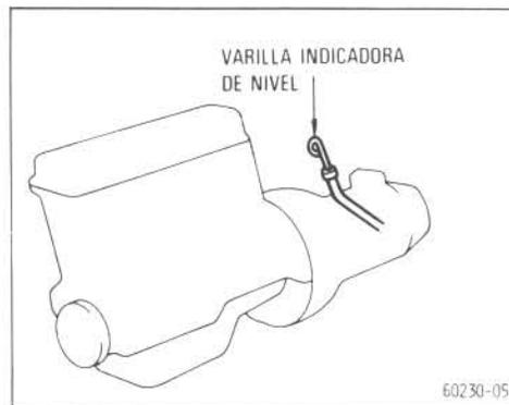
Sin embargo, el comprobar una transmisión fría le servirá sólo como referencia, ya que para obtener el nivel correcto debe comprobarse de nuevo a la temperatura de funcionamiento normal.
