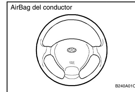
Su Hyundai está equipado con un AIRBAG. Los indicadores de presencia del sistema están marcados con las letras SRS Air bag en la tapa del volante y en el salpicadero en el lado del acompañante.
