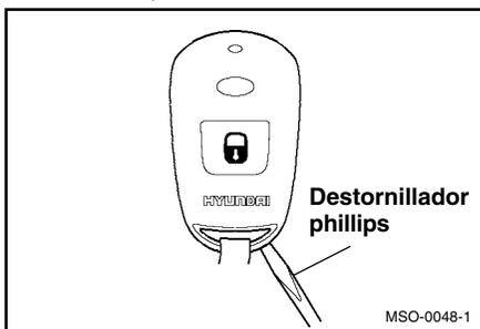
1. Abra la caja con un destornillador plano como se indica en la figura.
