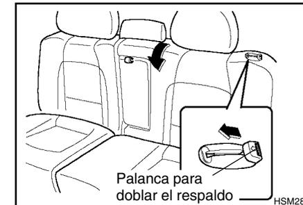
Para reclinar el respaldo, empuje la palanca del mismo hacia el reposacabezas y suéltela al alcanzar el ángulo de inclinación deseado.
