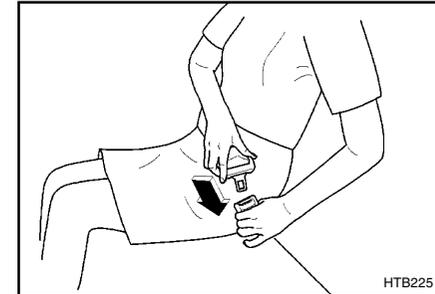
Para abrochar el cinturón de seguridad de dos puntos estático, inserte la parte metálica en el mecanismo de fijación hasta que escuché un "click", esto significará que su cinturón está asegurado. Verifique el aseguramiento y que no se encuentre torcido.
