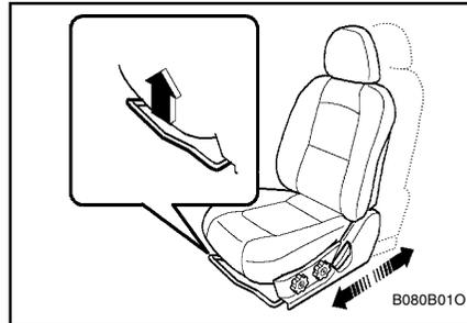
Para mover el asiento atrás o adelante, tire del seguro hacia arriba. Esto soltará el asiento y le permitirá desplazarlo hacia atrás o adelante según desee. Cuando encuentre la posición deseada, suelte la palanca y desplace el asiento suavemente hasta que se asegure y no se mueva más.
