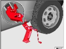
Fig. 135 Fitting the jack
