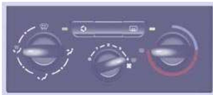
Frontal de la calefacción
