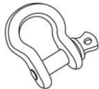
**Horquilla/grilletes:** el grillete es un medio seguro para conectar los extremos curvos de los cables, las correas y las roldanas. El pasador del grillete es roscado para facilitar el desmontaje.
