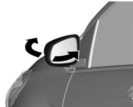
Para seguridad de los peatones, los espejos exteriores se giran fuera de su posición normal de montaje si se golpean con suficiente fuerza. Vuelva a colocar el espejo aplicando una ligera presión a la carcasa del espejo.
