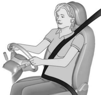
Extraiga el cinturón de seguridad y fíjelo en el broche. El cinturón de seguridad no debe estar retorcido y debe quedar bien ajustado al cuerpo. El respaldo no debe estar demasiado reclinado (máximo aproximado 25°).
