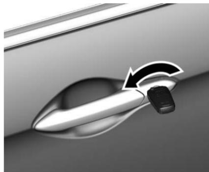
Desbloquee manualmente la puerta del conductor girando la llave en el seguro. Encienda la ignición y oprima el botón de bloqueo central para desbloquear todas las puertas y el compartimento de carga.
