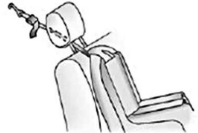
Si la posición de asiento exterior trasero que está utilizando tiene una cabecera ajustable y está utilizando sólo una atadura, levante la cabecera y pase la correa por debajo de la cabecera así como entre las barras de la cabecera.
