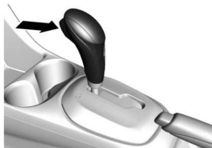
El movimiento entre ciertas posiciones de velocidades requiere presionar el botón al frente de la palanca de selección.
