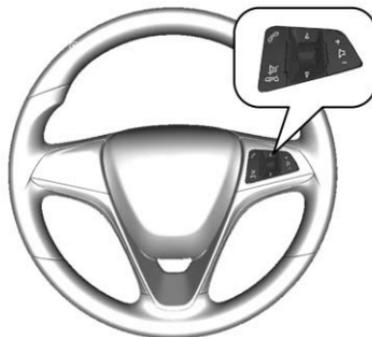
El sistema de Infoentretenimiento, un teléfono móvil conectado se puede operar por medio de los controles en el volante.
