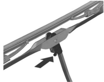
Levante el brazo del limpiador. Presione la palanca de liberación y desconecte el aspa del limpiador.
