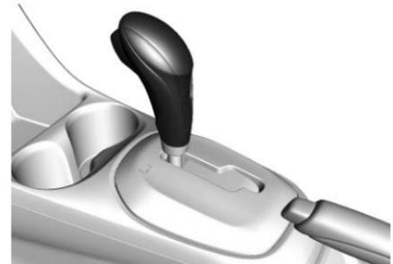
**P** : (estacionamiento) En la posición de estacionamiento, las ruedas delanteras están bloqueadas. Seleccione P únicamente cuando el vehículo esté detenido y el freno de estacionamiento esté aplicado.
