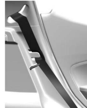
5. Coloque los cinturones de seguridad para los asientos exteriores en las guías para el cinturón.
