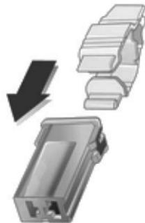
Coloque el extractor de fusibles en los diferentes tipos de fusibles de la parte superior o lateral y retire el fusible.
