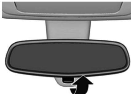
Para reducir el deslumbramiento, ajuste la palanca debajo de la carcasa del espejo.
