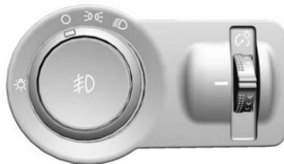
El control de luces exteriores está a la izquierda de la columna de dirección sobre el tablero de instrumentos.
