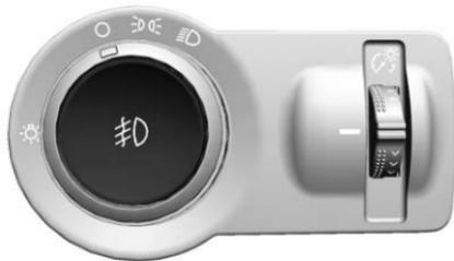
Presione para encender o apagar los faros de niebla delanteras. Cuando las luces anti-niebla se
