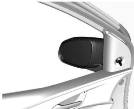
Si está equipado, mueva el control hacia arriba, abajo o los lados para ajustar el espejo.
