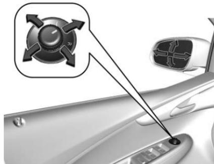
Seleccione el espejo exterior relevante girando el control hacia la izquierda (L) o derecha (R). Luego mueva el control para ajustar el espejo.
