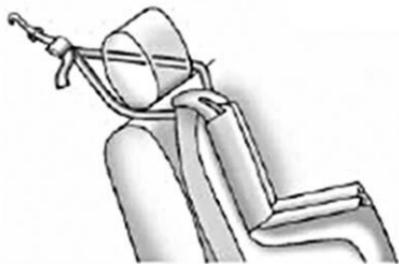
Si la posición de asiento exterior trasero que está utilizando tiene una cabecera ajustable y está utilizando una atadura doble, levante la cabecera y pase la correa por debajo de la cabecera así como alrededor de las barras de la cabecera.
