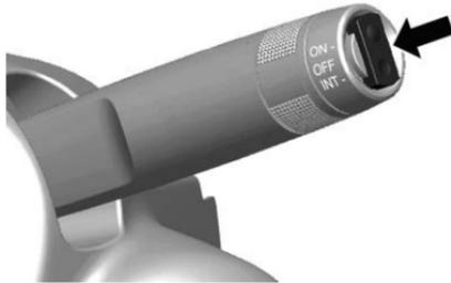
Presione el interruptor de oscilación para activar el limpiaparabrisas trasero:
