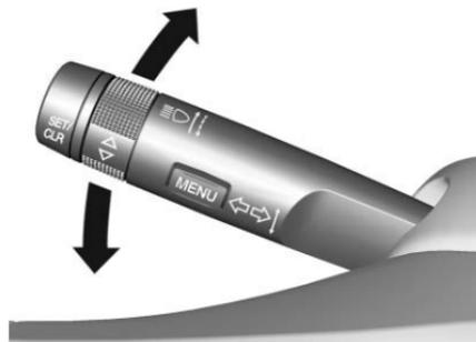
Mueva la palanca completamente hacia arriba o hacia abajo para señalar una vuelta.
