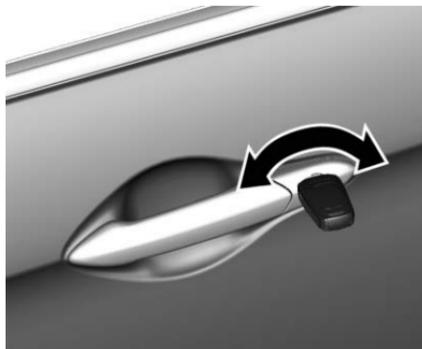
El bloqueo manual girando la llave en el cilindro permite el bloqueo central de puertas.
