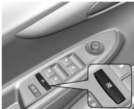
Presione el interruptor
