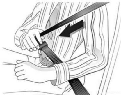
Extraiga el cinturón del retractor, guíelo sin retorcer de un extremo al otro del cuerpo e inserte la placa de seguro en la hebilla. Apriete el cinturón de seguridad de dos puntos mientras conduce jalando del cinturón del hombro
