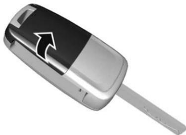
Extienda la llave y abra la unidad. Reemplace la batería (tipo de batería CR 2032), poniendo atención a la posición de la instalación. Cierre la unidad y sincronice.
