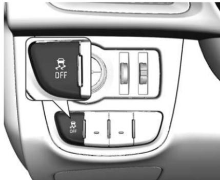
Para una conducción de alto desempeño, el ESC puede desactivarse : Sostenga
