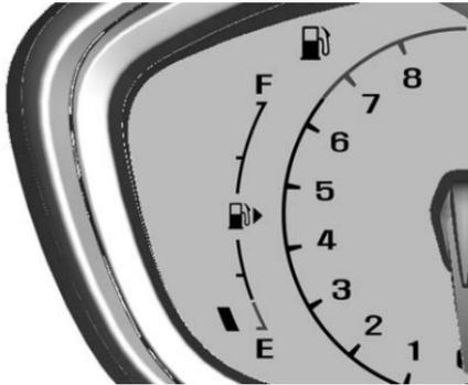
El indicador de control
