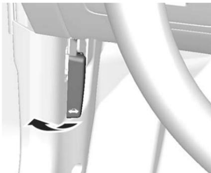
Jale la manija de liberación del cofre dentro del vehículo. Está en el lado inferior izquierdo del tablero de instrumentos.
