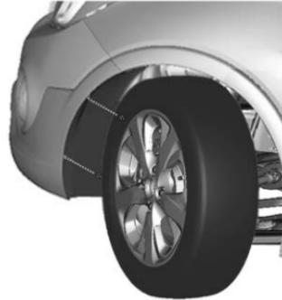
1. Incline la llanta delantera y retire las 2 tuercas de presión en la parte exterior del recubrimiento de la rueda.
