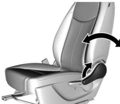
Jale la palanca, ajuste la inclinación y libere la palanca. Permita que se escuche que el asiento engancha.
