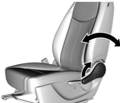
Jale la palanca, ajuste la inclinación y libere la palanca. Permita que el respaldo se conecte audiblemente.
