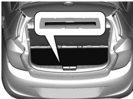
Almacene el triángulo de advertencia en la caja de herramientas del vehículo debajo de la cubierta de piso en el compartimento de carga.
