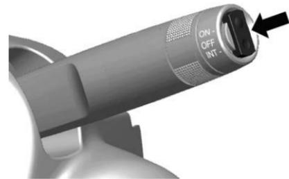
Presione el interruptor del oscilador para activar el limpiaparabrisas trasero:
