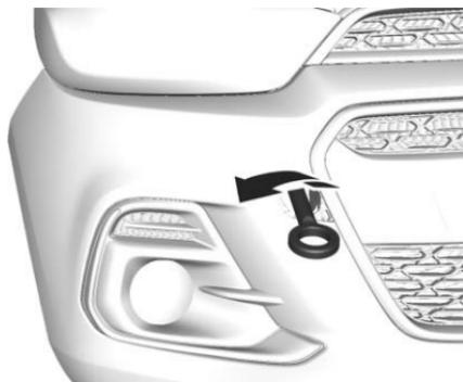
Atornille la argolla de remolque tanto como sea posible hasta que se detenga en una posición horizontal (debe estar en contacto con la tuerca de remolque).
