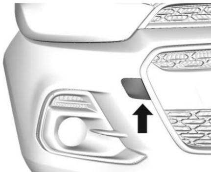
Desenganche la tapa usando el desarmador y retire la tapa.
