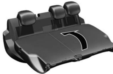
4. Pliegue el respaldo hacia adelante y hacia abajo.
