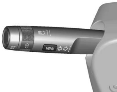
2. Usando el botón MENU y la rueda de ajuste en la palanca de direccional, desplácese hasta que llegue a Engine oil
