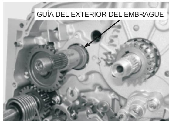
Aplique aceite del motor a los dientes del piñón conducido primario y dientes del piñón conducido del arranque de patada.
