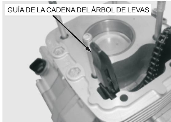
Compruebe si la guía y el tensor de la cadena del árbol de levas presentan un desgaste excesivo o daños, y sustitúyalos si es necesario.
