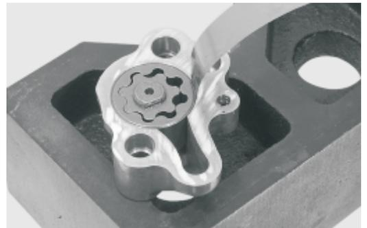
Mida la holgura de la punta del rotor entre los rotores interior y exterior.
