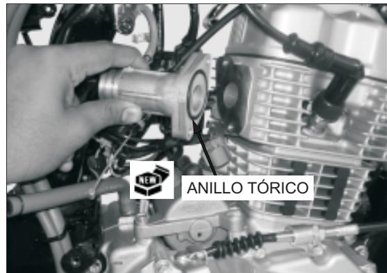
Instale el aislador el los tornillos.
