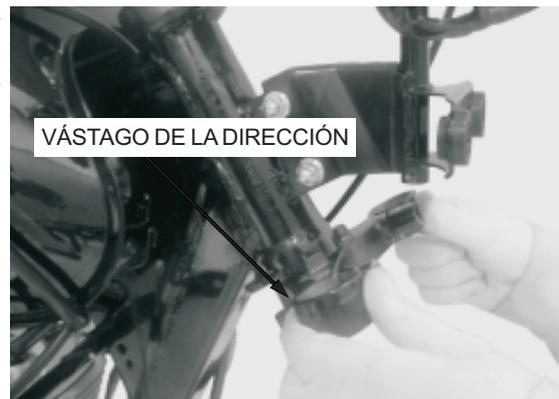
Afloje la tuerca de ajuste del cojinete de la dirección completamente, a continuación, reapriétala al par especificado.
