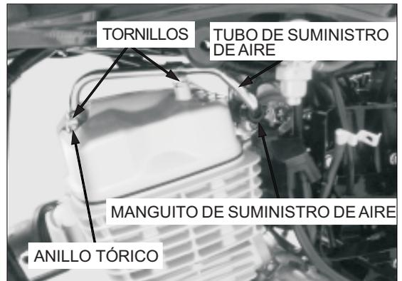
Compruebe el tubo de suministro de aire cuanto a rotura o daño.
