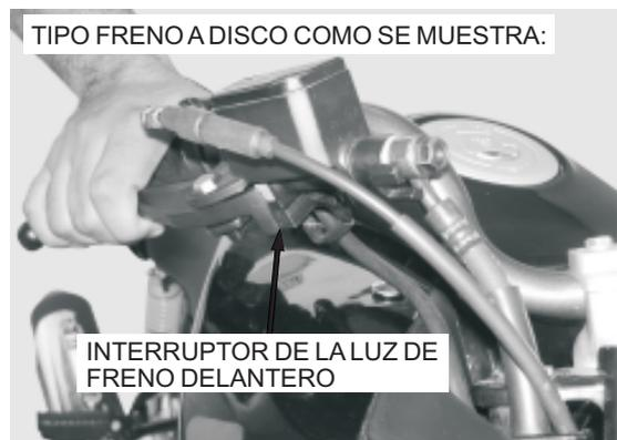
*Fije el cuerpo del interruptor de la luz de freno y gire la tuerca de ajuste. No gire el cuerpo del interruptor mientras gira la tuerca de ajuste.*
