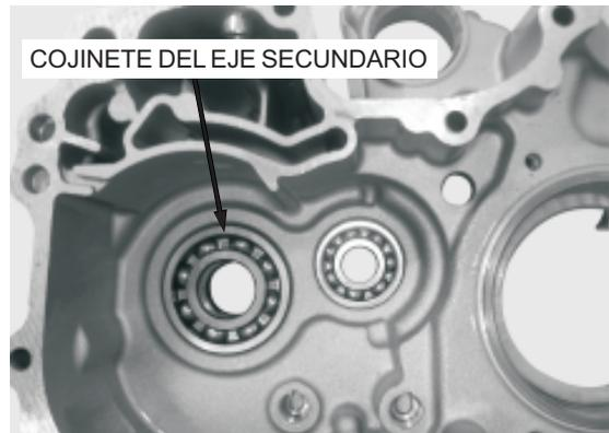
Desmonte el cojinete del eje primario de la mitad izquierda del cárter motor con las herramientas especiales.
