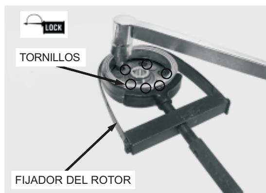
Monte el piñón conducido del motor de arranque en el rotor haciéndolo girar en el sentido contrario a las agujas del reloj.
