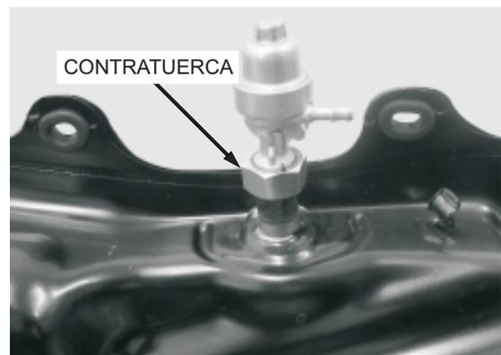
Remueva el grifo de combustible completo y el filtro tamiz de combustible del depósito de combustible.
