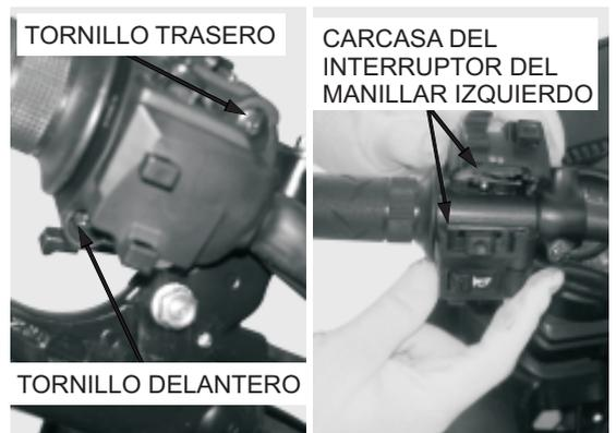
Desmonte el puño del manillar con movimientos de torsión cambiando las direcciones.
