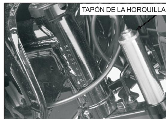
Afloje el tornillo de fijación inferior y monte el brazo de la horquilla a través del puente superior.
