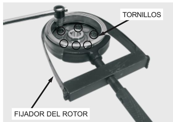
Desmonte el conjunto del embrague de arranque del volante.
