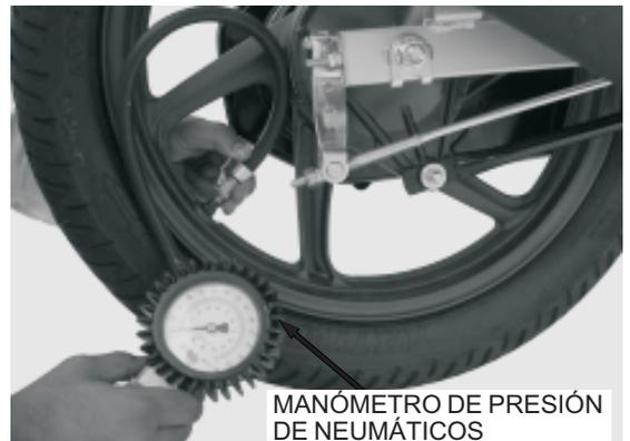
Compruebe la existencia de cortes, clavos incrustados u otros daños en los neumáticos.
