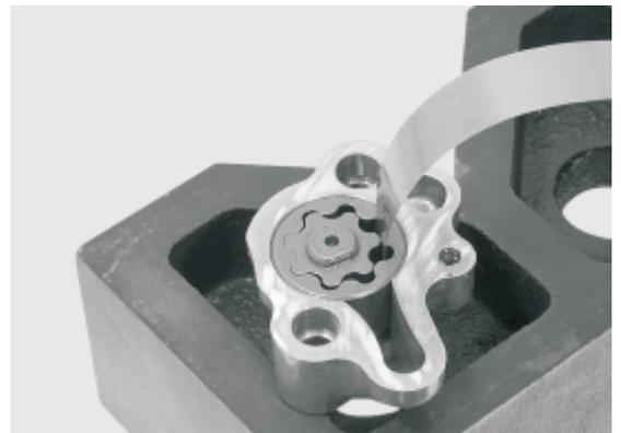
Desmonte el eje del rotor.
