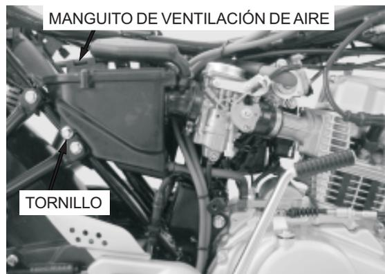
Monte y apriete los tornillos de la carcasa del filtro de aire.
