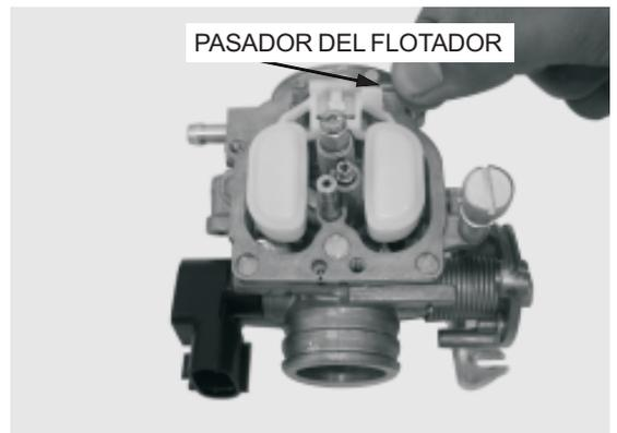
Con la válvula del flotador asentada y el brazo del flotador solamente tocando la válvula, mida el nivel del flotador utilizando la herramienta especial como se muestra.
