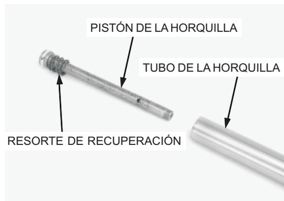
Monte la pieza de bloqueo de aceite en el extremo del pistón de la horquilla y, a continuación, monte el tubo de la horquilla en la corredera de la horquilla.
