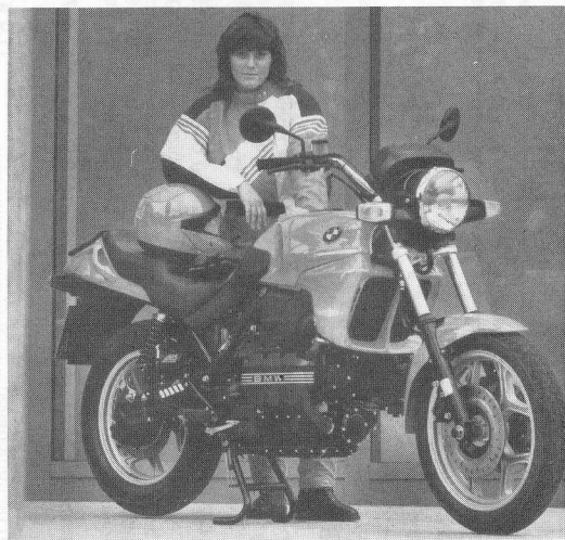
La versión 1990 de la K 75. Este modelo incorpora la horquilla, la rueda trasera y el disco de freno trasero de la K 75 S. De este modo, se le puede instalar opcionalmente el sistema de frenado ABS.
