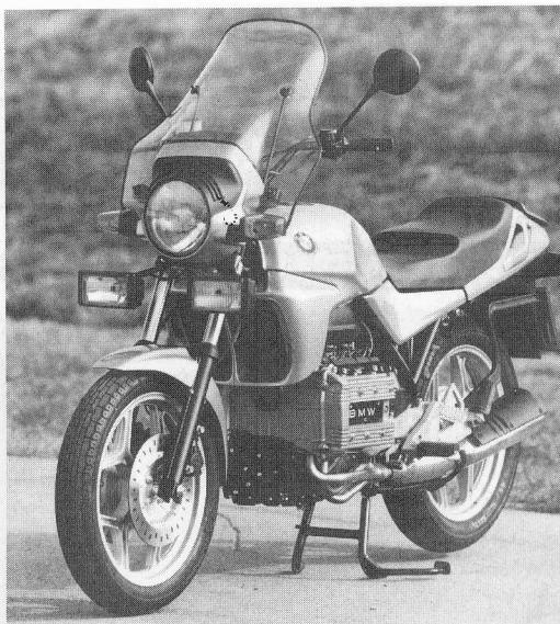
La K 75 C, cuando apareció, podía incorporar una cabeza de horquilla o un carenado de faro y un parabrisas. Los antinieblas instalados en este modelo forman parte de los accesorios comercializados por BMW.
