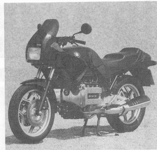
La K 75 S tal como apareció en 1986. El carenado de cabeza de horquilla fijada al cuadro, y no a la horquilla como en la versión C, recibe un faro rectangular y no circular. La K 75 S no poseía al principio plancha de carenado. Este último apareció al año siguiente y fue montada de serie dos años más tarde.
