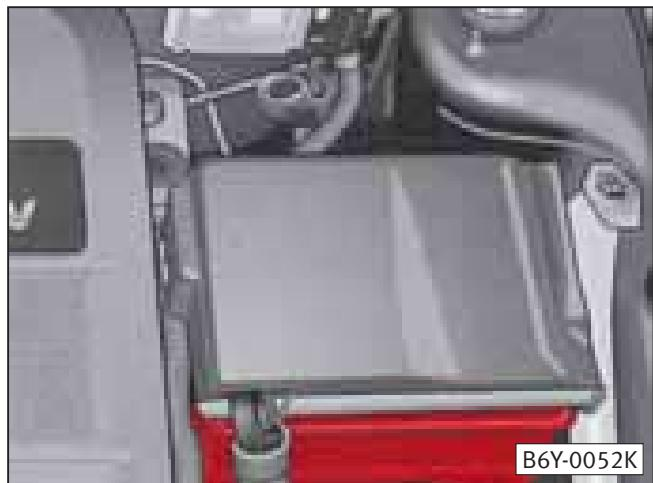
La batería se encuentra situada en el compartimento motor, debajo de una cubierta.
