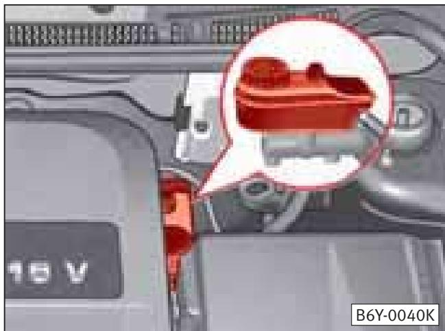
El depósito del líquido de frenos se encuentra en el lado izquierdo del compartimiento motor.
