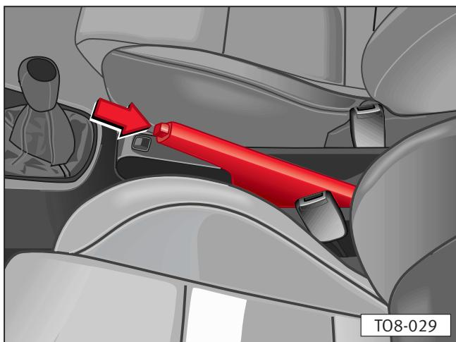
Para poner el freno de mano hay que levantar firmemente la palanca. En una cuesta pronunciada habrá que colocar además la primera marcha o, en caso de cambio automático, el bloqueo de aparcamiento. El freno de mano se ha de apretar firmemente, a fin de evitar que por descuido se conduzca con el freno puesto.
