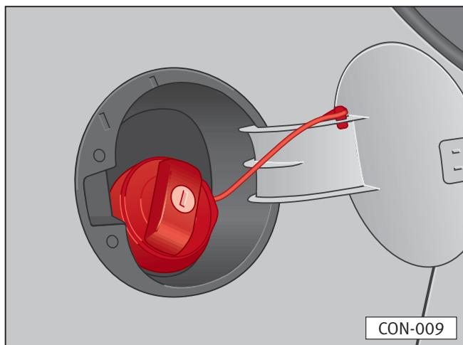
La boca de carga del depósito se encuentra en el panel lateral trasero derecho.
