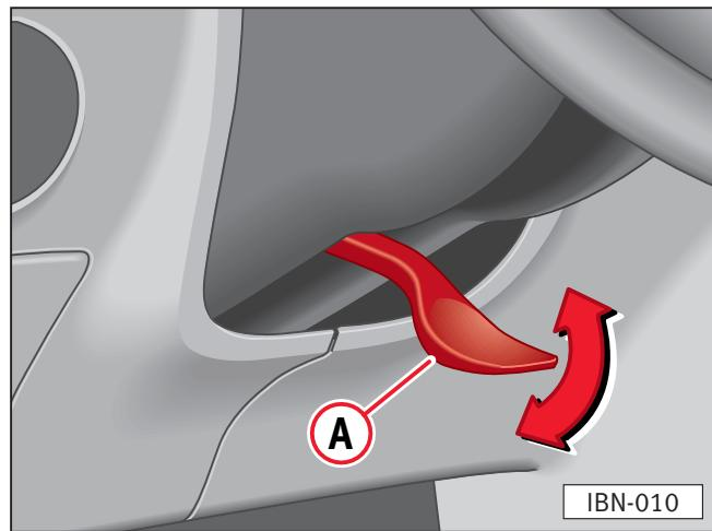
La columna de dirección se puede ajustar sin escalonamientos en altura y profundidad. Para ello se debe oprimir hacia abajo la palanca A situada en el alojamiento del revestimiento y colocar la columna en la posición deseada. Seguidamente, presionar de nuevo firmemente la palanca hacia arriba.
