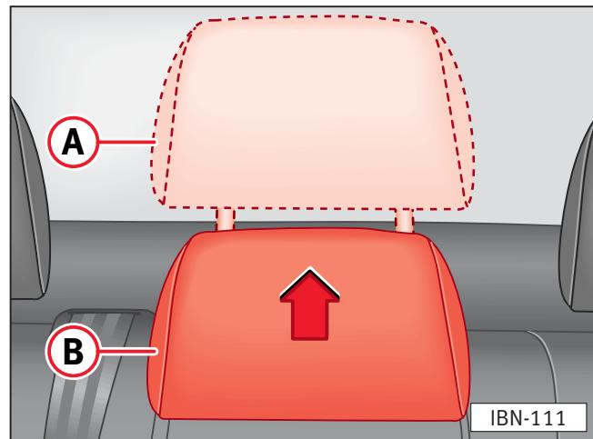
Los apoyacabezas son ajustables en altura y deberán adaptarse a la estatura del ocupante. Un apoyacabezas correctamente ajustado ofrece, junto con el cinturón de seguridad, una protección eficaz. También es posible ajustar la inclinación en el caso de los apoyacabezas delanteros.
