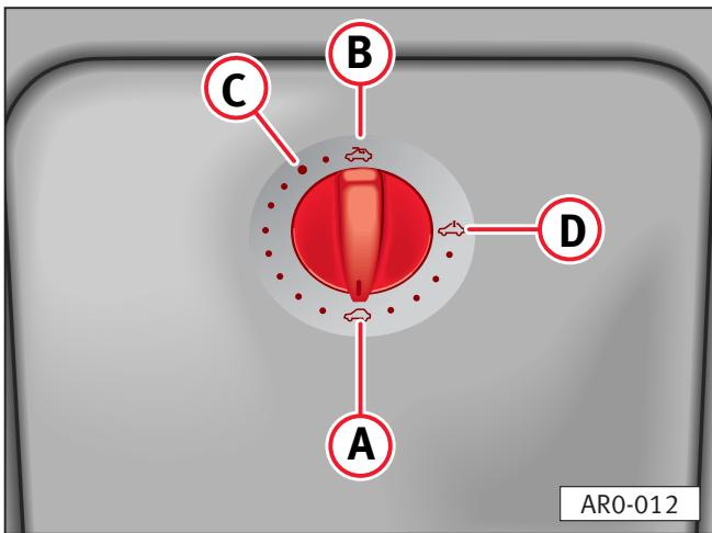
Con el encendido conectado, el techo abrible se abre y se cierra mediante el mando giratorio.
