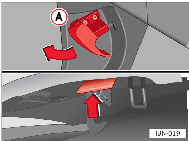
**Para desbloquearlo,** tírese de la palanca A dispuesta en el panel lateral lado conductor, bajo el tablero de instrumentos; el capó salta ligeramente por la fuerza del muelle.
