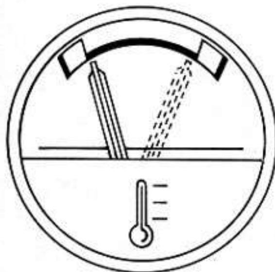
miento inmediatamente si la aguja muestra un rápido ascenso hacia la marca roja. Una lectura baja y continuada, con el motor en temperatura de trabajo, puede indicar, el termostato defectuoso o algún inconveniente en el sistema indicador.
