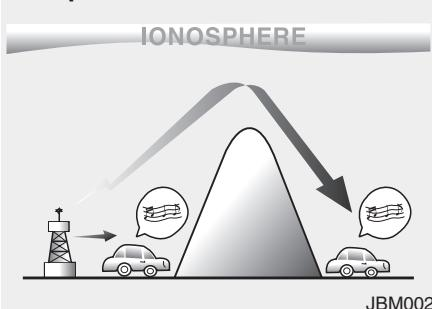
Las emisiones en AM (MW, LW) se reciben a distancias mayores que las de FM. Esto se debe a que las emisoras de AM transmiten en frecuencias bajas. Estas ondas de radio largas y de baja frecuencia pueden seguir la curvatura de la tierra en lugar de propagarse en línea recta directamente por la atmósfera. Además, se curvan alrededor de los obstáculos, por lo que proporcionan una mejor cobertura de la señal.
