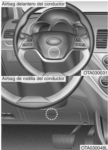
Los indicadores de presencia del sistema son las letras "AIR BAG" o estampadas en la cubierta del panel del airbag en el volante y/o en la cubierta del cojín para rodillas del lado del conductor colocado debajo del volante y en la cubierta del panel delantero sobre la guantera del lado del acompañante.
