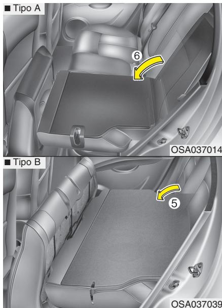
8. Pliegue el respaldo firmemente hacia delante y hacia abajo (5), (6).
