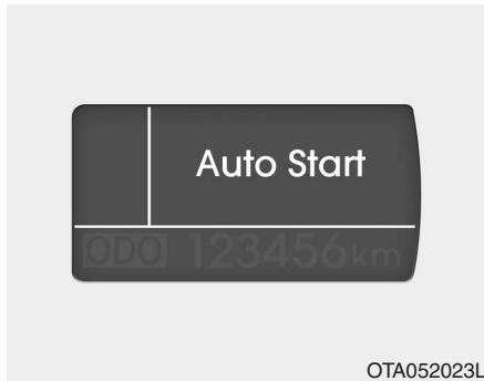
El indicador verde AUTO STOP (Ⓐ) en el cuadro de instrumentos parpadeará unos 5 segundos y aparecerá el mensaje "El motor vuelve a arrancar" en la pantalla LCD (opcional).
