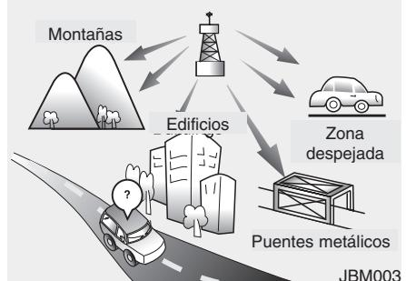
Las emisiones en FM se transmiten a frecuencias elevadas y las ondas no se curvan siguiendo la superficie terrestre. Por ello, las emisiones en FM comienzan por lo general a desvanecerse a escasa distancia de la emisora. Además, las señales de FM se suelen ver afectadas por edificios, montañas u otros obstáculos. Este puede inducirle a pensar que su aparato de radio tiene algún fallo. Las condiciones que se indican a continuación son normales y no indican averías en la radio.
