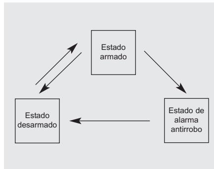
Este sistema está diseñado para proteger frente a la entrada no autorizada al vehículo. Funciona en tres etapas: la primera es "Armado", la segunda "Alarma antirrobo" y la tercera "Desarmado". Cuando se activa, el sistema proporciona una alarma acústica y enciende los intermitentes de emergencia.
