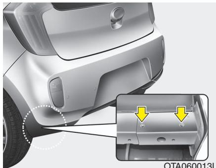
**\* ATENCIÓN - Ubicación del elemento de montaje para remolque**
