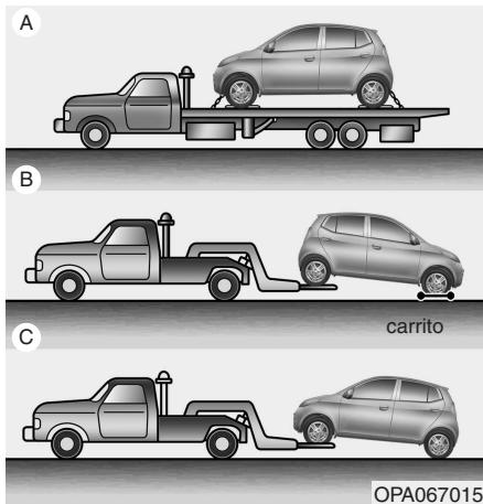
El vehículo se puede remolcar con las ruedas traseras apoyadas en el suelo (sin carro de transporte) y las delanteras levantadas.
