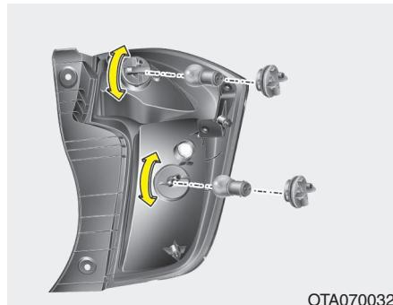
3. Retire el casquillo del conjunto de las luces haciéndolo girar en sentido contrario a las agujas del reloj hasta que sus patillas queden alineadas con las ranuras del conjunto.
