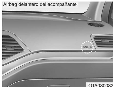
La finalidad del SRS es proporcionar al conductor del vehículo y al acompañante una protección complementaria a los cinturones de seguridad en caso de impacto frontal de gravedad.
