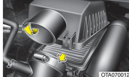
2. Afloje la abrazadera de la manguera del purificador de aire con un destornillador.
