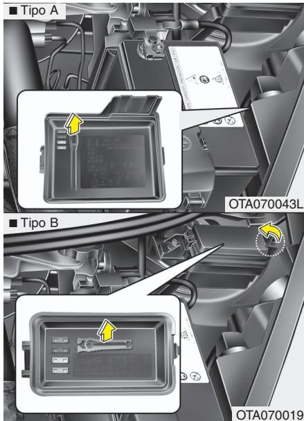
3. Tire del fusible averiado. Utilice la herramienta de desmontaje que está en el panel de fusibles del compartimento del motor.
