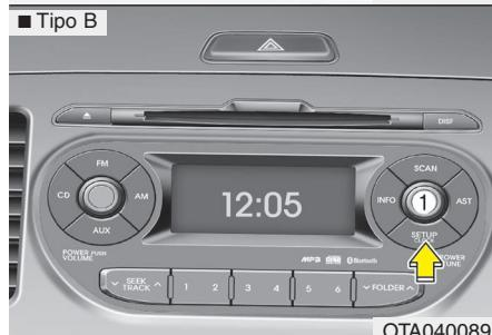
**Ajuste del reloj (Tipo A, Tipo B)****Con el sistema audio apagado**
