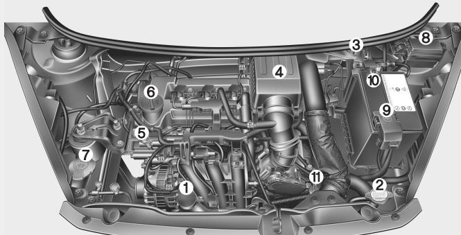
1. Depósito de refrigerante del motor ..... 7-26
