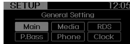
En el modo SETUP, gire el botón TUNE para mover el cursor entre los elementos y empuje el botón TUNE para seleccionar.
