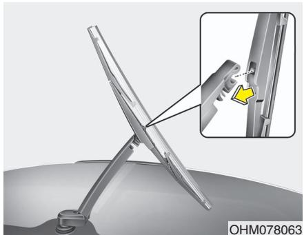
2. Monte el nuevo conjunto de la escobilla introduciendo la parte central en la ranura del limpiaparabrisas hasta que se coloque en su sitio.
