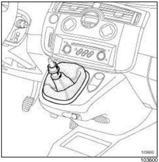
☐ Unclip the « knob - gear lever gaiter » assembly.
