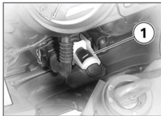
1 Ajuste del alcance de los faros
