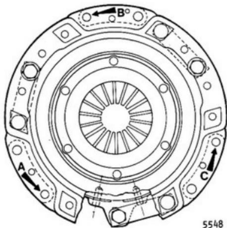
Apretar definitivamente los tornillos en forma alternada y progresiva a una torsión de 2,6 mkg para Motor 1400 y 2,2 mkg para Motor 1300.
