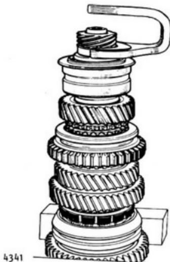
Marcar la posición del desplazable de 3ra. - 4ta. con respecto al núcleo del sincronizador.
