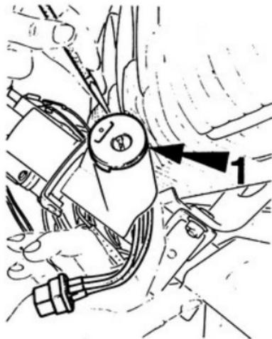
Retirar el tornillo de fijación (1), presionar el perno de traba con un punzón y empujar el interruptor de atrás hacia adelante, para desmontarlo.
