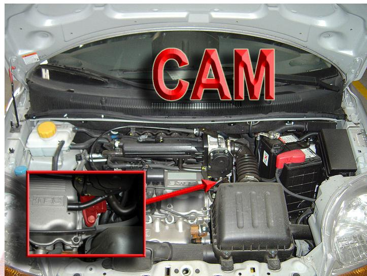
Lado derecho de la culata, por encima de la carcasa del termostato.
