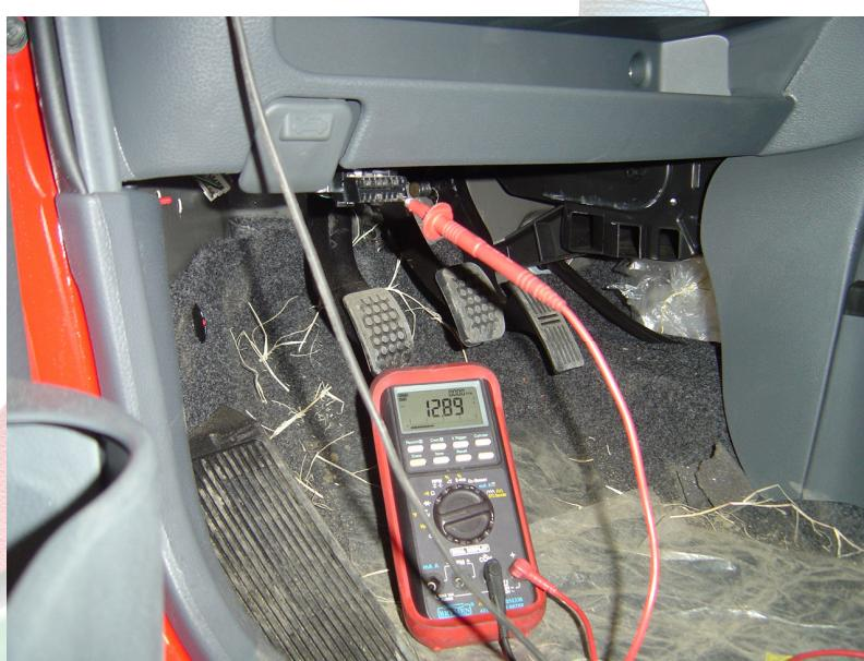
6. Conectar el cable rojo del multímetro al pin 16 del DCL.
