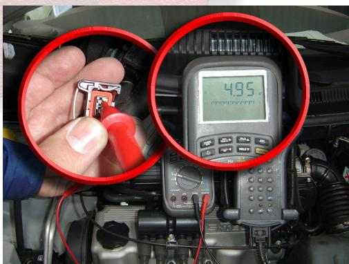
Conectar el cable rojo al otro terminal en el conector del sensor
