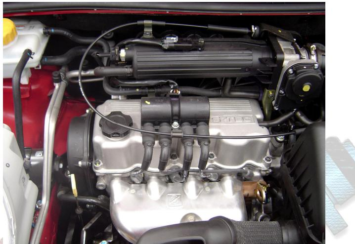
Sistema constituido por un paquete único de bobina, sin modulo de potencia en su interior.
