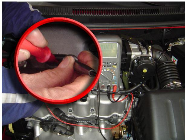
6. Conectar el cable negro a cada terminal lateral en el conector en la bobina.
