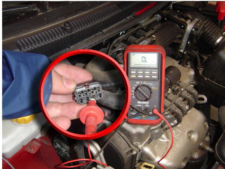
4. Conectar el cable rojo al único terminal inferior del conector múltiple de los inyectores.
