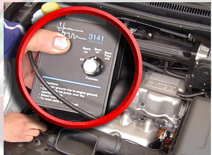
5. Girar el dial a función de Kv. de bujía.
