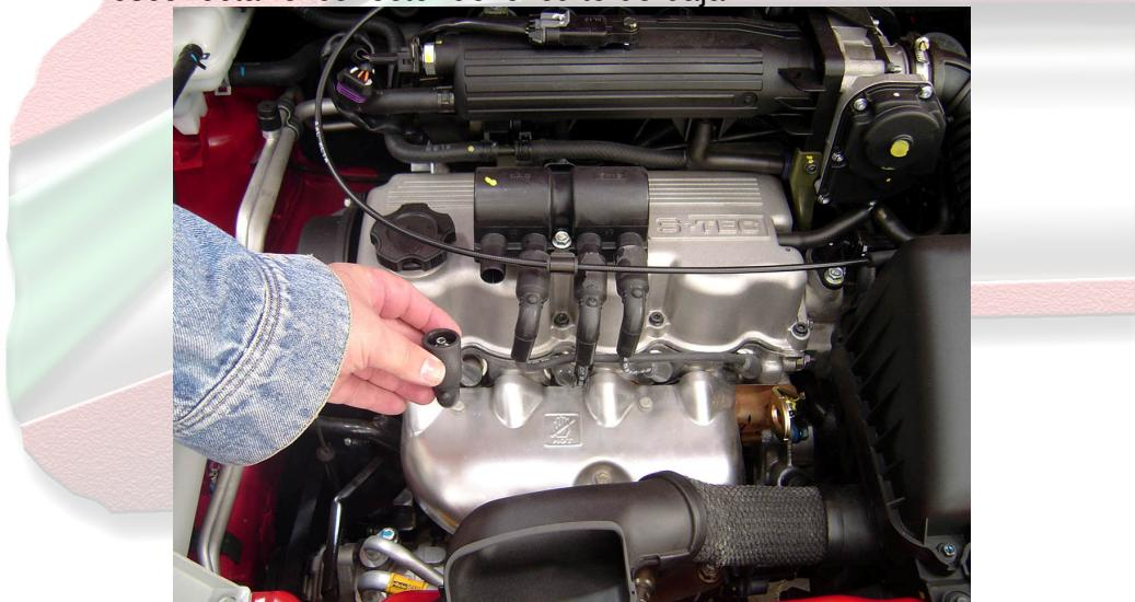
3. Desconectar de la bobina todos los cables de alta.
