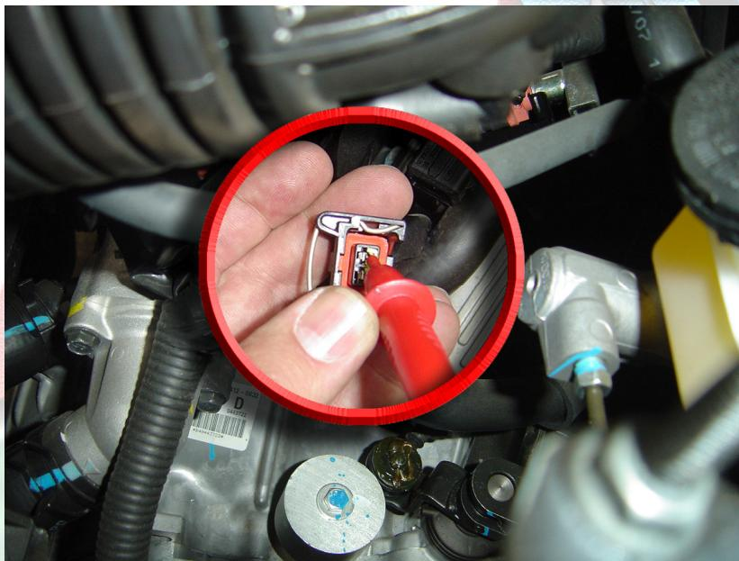
12. Conectar el cable rojo del multímetro a uno de los terminales en el conector del sensor
