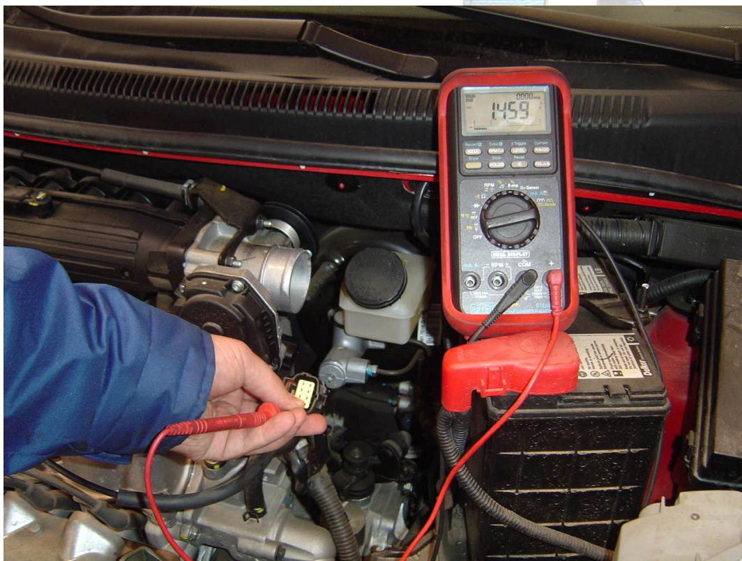
8. Conectar el cable rojo del multímetro al terminal 2 del conector del MTIA.
