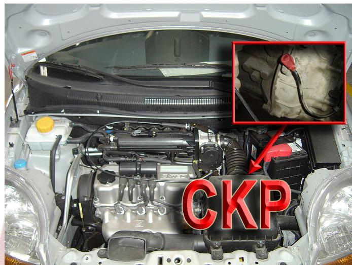
En la carcasa de la caja en la unión entre el motor y la caja de velocidades
