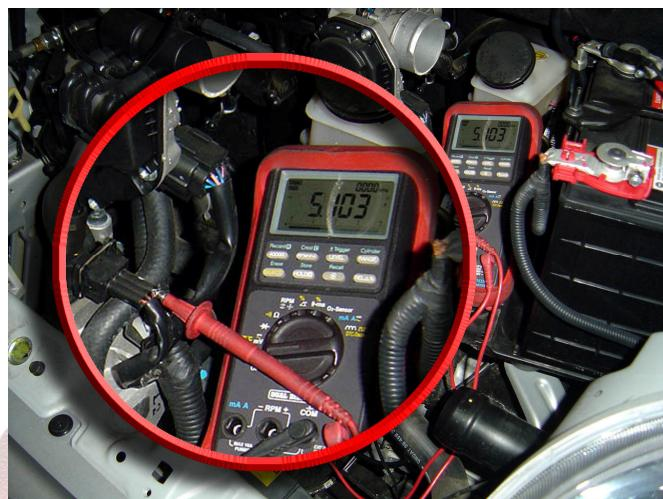
1. Mantener el cable negro del multímetro conectado a masa.
