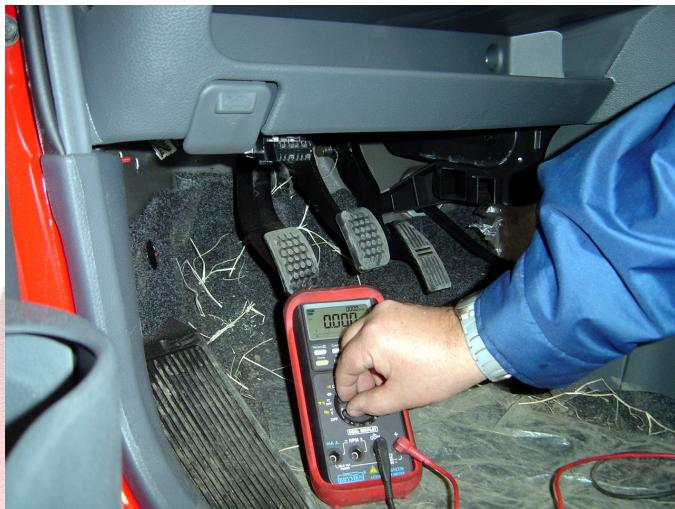
2. Dial del multímetro en función de voltios continuos.
