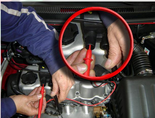
8. Cable rojo del multímetro a una de las torre de la bobina 1.
