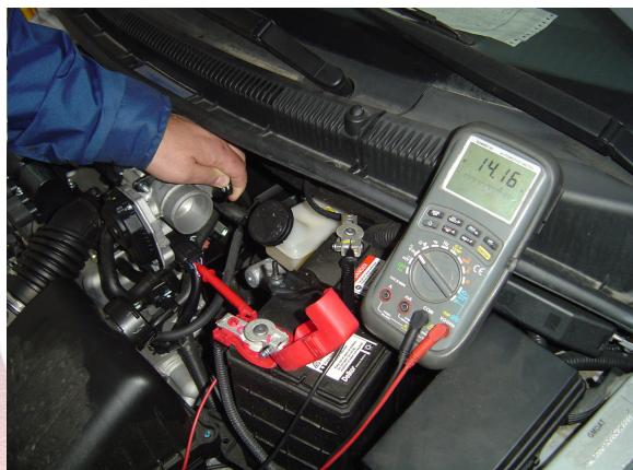
El voltaje debe ser incrementarse instantáneamente hasta alcanzar un valor cercano al de la batería.
