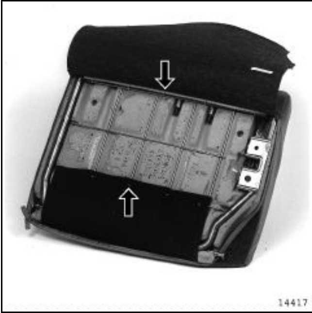
Sacar las grapas "nariz de cerdo" fijadas a la armadura.
