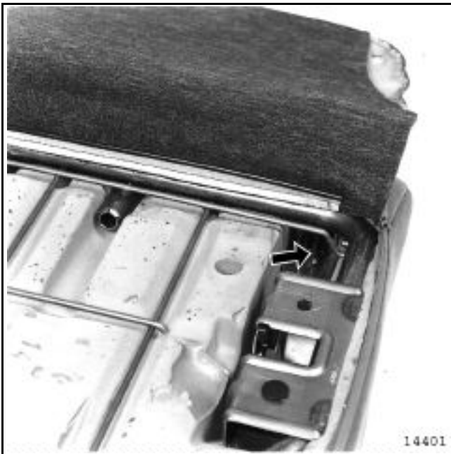
Extraer el botón de desbloqueo del respaldo y la armadura del respaldo (seguir el método descrito en el capítulo 76A-B).
