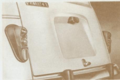
**Para cerrar:** Levante ligeramente el portón y tire del compás para soltar el dispositivo de retención, bájelo y ciérrelo igual que las puertas delanteras.
