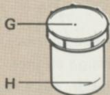
**Compruebe** el nivel del líquido de freno. Debe sobrepasar siempre la marca inferior **H**.
