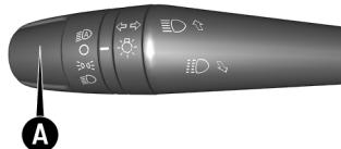
El faro alto se apaga y vuelve a poner la palanca en la posición central y estable.
