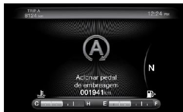
Si no se presiona el pedal de embrague en aproximadamente 3 minutos, un mensaje será exhibido en el display (Off o Start&Stop no disponible), en este caso el rearranque automático estará deshabilitado y será necesario efectuar el rearranque del ve-
