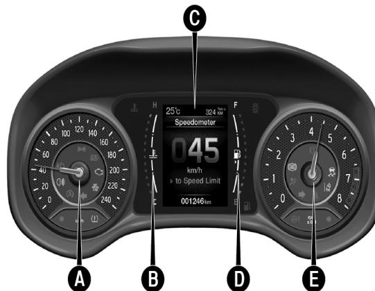
A- Velocímetro – B- Indicador digital de la temperatura del líquido de enfriamiento del motor con luz de aviso de temperatura máxima – C- Pantalla multifunción – D- Indicador digital de nivel de combustible con luz de aviso de límite mínimo (el triángulo presente en el lado derecho o abajo del símbolo indica en cual lado del vehículo está la boquilla para el suministro de combustible) – E- Cuentarrevoluciones
