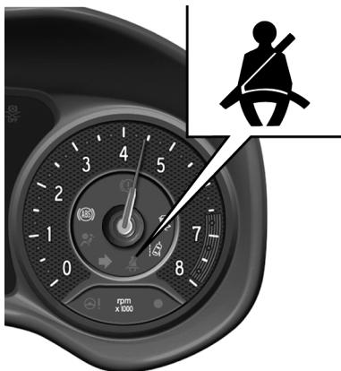
Cuando el vehículo se detiene, si el cinturón de seguridad en el lado del conductor se suelta, la luz sigue encendida de manera fija.
