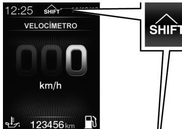
La indicación queda visible en la pantalla hasta que se haga un cambio de marcha o hasta que las condiciones de manejo entren en un perfil donde no se necesita hacer un cambio de marchas para optimizar el consumo.
