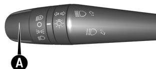
La iluminación exterior se realiza sólo con la llave de encendido en la posición **MAR** (excepto en la función **Follow me home** y luces de posición).
