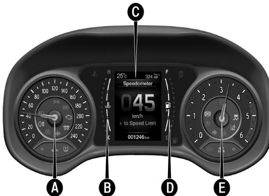
A- Velocímetro – B- Indicador digital de la temperatura del líquido de enfriamiento del motor con luz de aviso de temperatura máxima – C- Pantalla multifunción – D- Indicador digital de nivel de combustible con luz de aviso de límite mínimo (el triángulo presente en el lado derecho o abajo del símbolo indica en cual lado del vehículo está la boquilla para el suministro de combustible) – E- Cuentarrevoluciones
