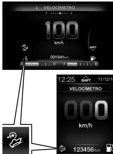
La velocidad del sistema HDC se puede regular por el pedal del freno y del acelerador (entre 2,5 km/h a 25 km/h para versiones con cambio automático y entre 6 km/h a 25 km/h para versiones con cambio manual). Cuando se consigue la velocidad deseada y se suelta los dos pedales, el sistema HDC mantiene la velocidad definida. De esta manera, el conductor puede ajustar la velocidad y, si
