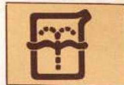
Esta luz se encenderá cuando el nivel del líquido en el depósito del lavaparabrisas ha llegado a la marca de mínimo. Complete el nivel de acuerdo a lo indicado en la sección "Cuidado de su vehículo".
