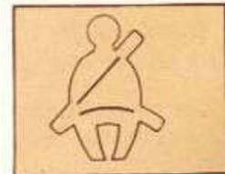
Al colocar la llave de ignición en la posición de contacto, se encenderá la luz recordatoria de colocarse el cinturón de seguridad. Esta luz se apagará automáticamente luego de varios segundos.
