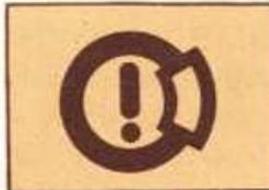
Esta luz se encenderá cuando el material de fricción de las pastillas de freno llegue al espesor mínimo admisible.
