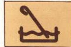
La luz se enciende cuando el nivel de aceite lubricante del motor, en el cárter, está próximo a la marca de mínimo de la varilla indicadora. Controle primero el nivel y luego complételo de acuerdo a lo explicado en la sección "Cuidado de su vehículo".
