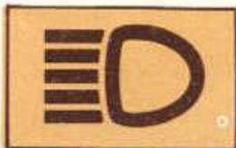
La luz de color azul indica el encendido de las luces altas. La misma se encenderá cada vez que se conecte la luz alta de los faros delanteros.
