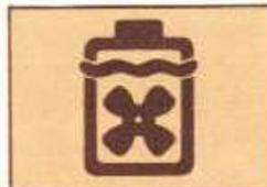
La luz de aviso se encenderá cuando el nivel del líquido refrigerante del motor, alojado en su depósito, ha llegado a la marca de mínimo. Complete el nivel de acuerdo a lo indicado en la sección "Cuidado de su vehículo".
