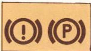
La luz de aviso se encenderá indicando que el freno de estacionamiento se encuentra aplicado, al colocar la llave de encendido en la posición de contacto. Se apagará en el momento que se desaplique el freno de estacionamiento. Si la luz se enciende durante la marcha controle primeramente que el freno de estacionamiento se encuentre desaplicado. Si la luz permanece
