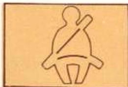
Al colocar la llave de ignición en la posición de contacto se encenderá la luz recordatoria de colocarse el cinturón de seguridad. Esta luz se apagará automáticamente luego de varios segundos.
