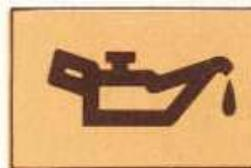
Esta luz es de color rojo y se enciende al colocar la llave de contacto en la posición II (encendido). La luz debe apagarse inmediatamente que el motor se ponga en funcionamiento, no debiendo encenderse mientras que el motor funciona: LA LUZ APAGADA INDICA CON CERTEZA QUE LA PRESION DE ACEITE DEL MOTOR ES CORRECTA (SI LA LAMPARA Y EL CIRCUITO FUNCIONAN CORRECTAMENTE).
