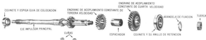
Vista esquemática de los componentes del eje impulsor principal
