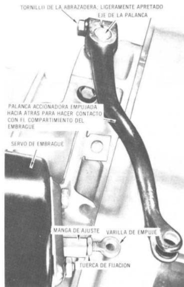
**Primer paso para efectuar el ajuste básico del embrague, con un plato opresor nuevo**
