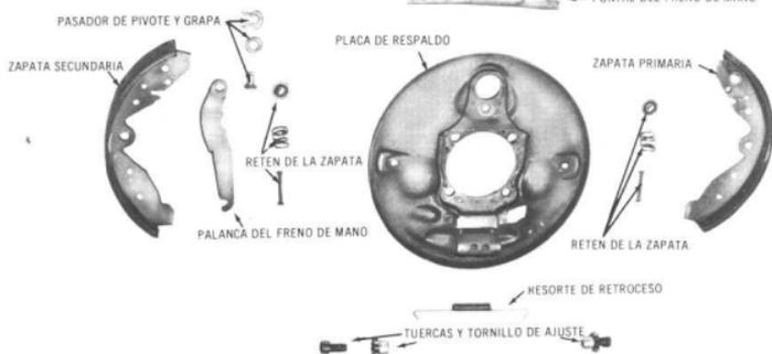
Vista esquemática de los componentes de las zapatas de los frenos traseros
