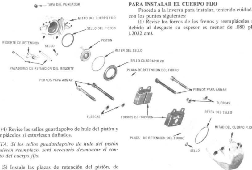
Vista esquemática de los componentes del cuerpo fijo de los frenos de disco
