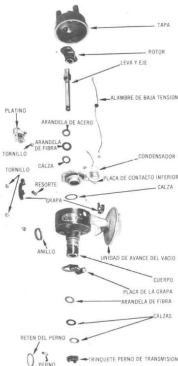
(3) Revise si están desgastadas las áreas del cojinete del eje. Si el juego radial es excesivo, sustituya el distribuidor completo. Ajuste el juego axial con calzas.
