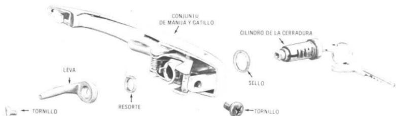
Componentes de la manija exterior de la cerradura de la portezuela, instalados en los Modelos 1500
