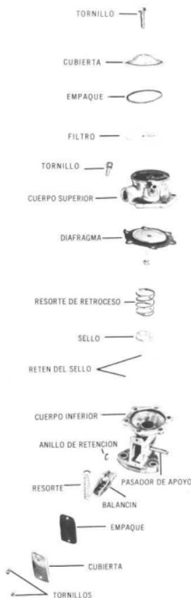
**Vista esquemática de los componentes de la bomba de combustible (tipicos de todos los modelos)**
