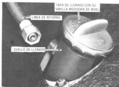
Conducto de retorno del aceite, desconectado del cuello de llenado del tanque
