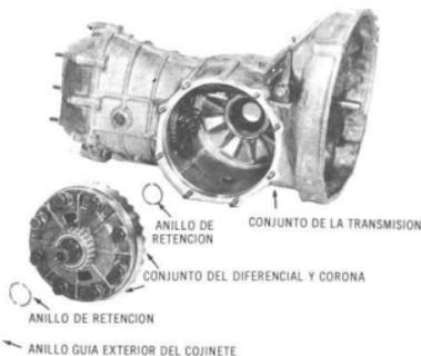
(4) De la cubierta del compartimiento retire el engrane del diferencial (eje corto) y la arandela de empuje.
