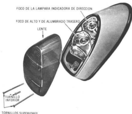
Luces traseras del indicador de dirección, de alumbrado y de alto
