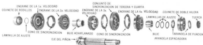
Vista esquemática de los componentes del eje del piñón impulsor
