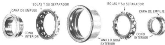
Componentes del cojinete de doble hilera de bolas del piñón impulsor. Los modelos recientes tienen un cojinete de doble hilera de rodillos. (Los conos interiores tienen marcado "empuje" sobre la cara exterior)
