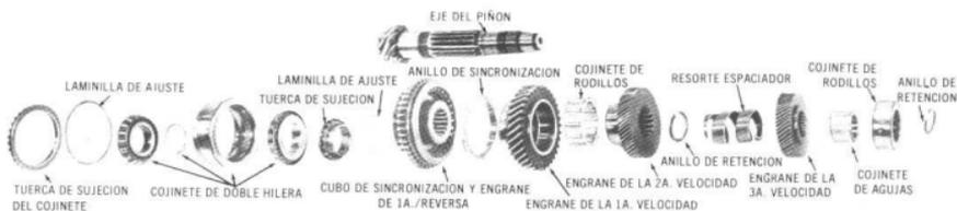
Vista esquemática de los componentes del eje del piñón por lo tanto, si uno está dañado, se deberán reemplazar ambos
