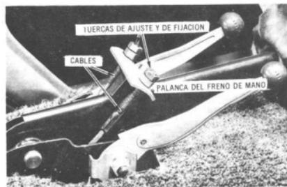
Ajuste del cable del freno de mano. Se muestra el modelo 1500, típico de los modelos anteriores
