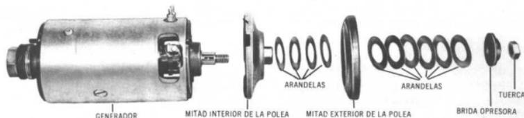
**Generador y polea de impulso bípártida, con las arandelas para el ajuste de la tensión de la banda del ventilador**
