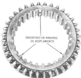
Manga de sincronización de la segunda velocidad, mostrando el entendado en las ranuras de acoplamiento para la lengüeta de las placas de cambios del conjunto de sincronización
