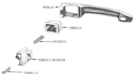
Componentes de la manija exterior de la portezuela para cerradura giratoria, instaladas en los Modelos 1200—1300
