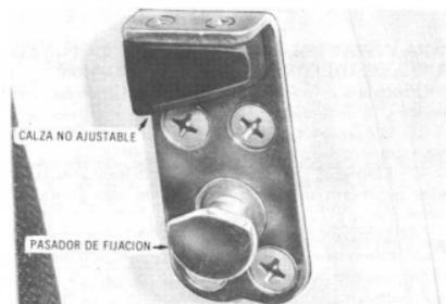
**Percutor de cierre para la cerradura de la portezuela, instalado a los Modelos 1500 (típico)**
