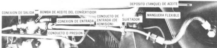
Vista de la parte baja de la carrocería mostrando la disposición de la bomba y el depósito de aceite del convertidor
