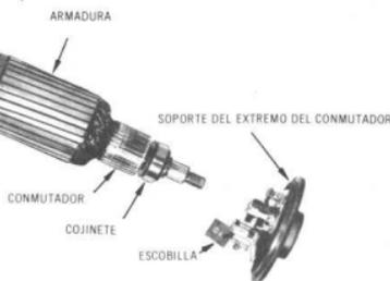
Vista esquemática de los componentes del generador (Tipo de todos los Modelos)
