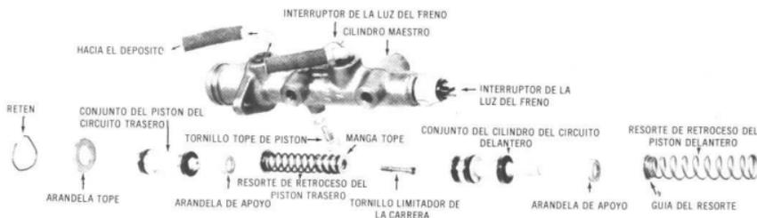
Vista esquemática de los componentes del cilindro maestro. Sistema de frenos de circuito doble
