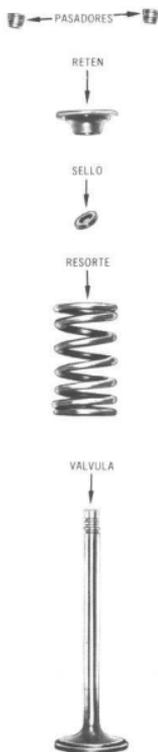
Elementos componentes de las válvulas y de los resortes de las mismas
