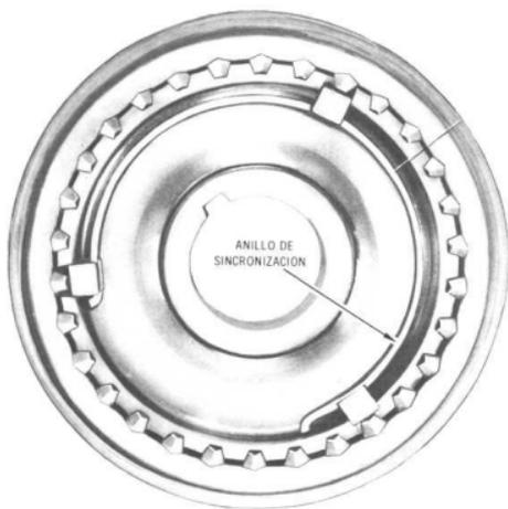
Posición instalada del anillo de sincronización para el conjunto sincronizador de 2a./3a.
