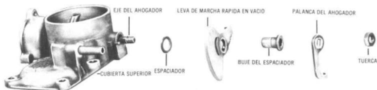
Componentes de la leva de marcha rápida en vacío del carburador 28 PICT
