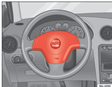
Fig. 17 Airbag del conductor en el volante
