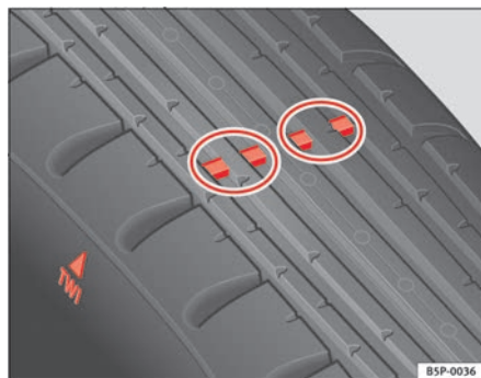
Fig. 129 Indicadores de desgaste del perfil del neumático
