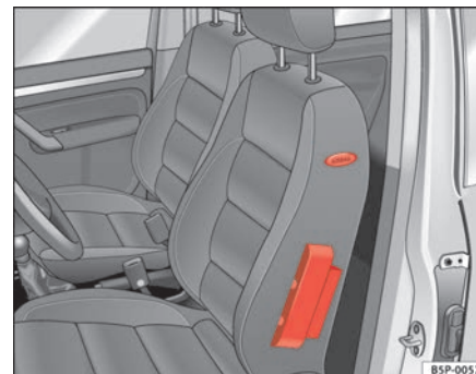
Fig. 21 Airbag lateral en el asiento del conductor
