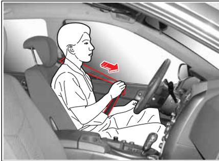
1. Jale hacia fuera la placa del seguro del retractor. Si el cinturón de seguridad está trabado cuando jala hacia afuera, rebobínelo completamente en el retractor, luego jale hacia afuera hasta alcanzar el largo deseado.
