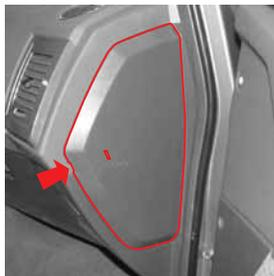
La caja de fusibles está ubicada en la parte derecha del tablero de instrumentos. Para acceder a la caja de fusibles interior, abra la puerta del acompañante y extraiga la tapa de la caja de fusibles con un destornillador.
