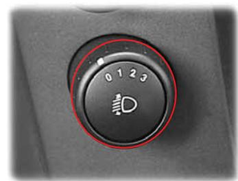
Si las luces bajas están encendidas, ajuste el ángulo de alineación de los faros para adecuarlo a la carga del vehículo.
