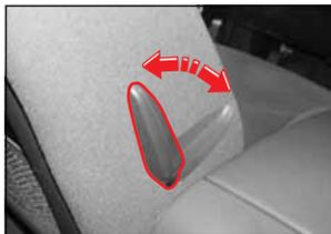
Gire la palanca hacia adelante para aumentar el apoyo lumbar. Para disminuirlo, gire la palanca hacia atrás.
