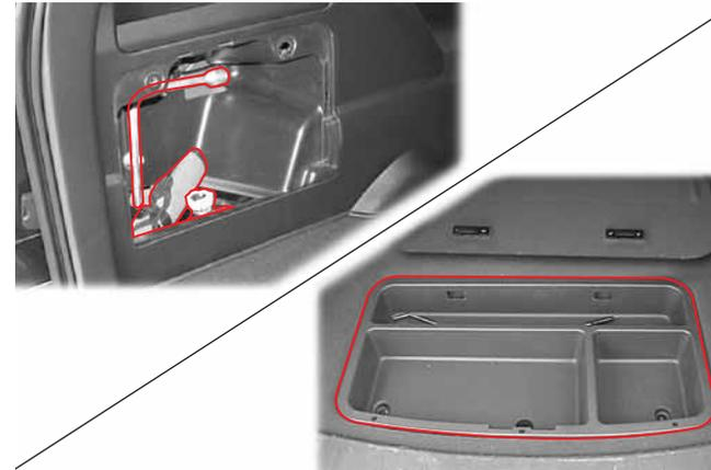
4. Extraiga el gato, la llave inglesa para tuercas de rueda, las herramientas OVM y la conexión del gato.
