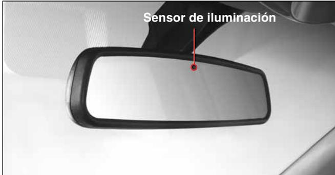
El nivel de reflejo del espejo retrovisor interior puede ajustarse en forma automática por la intensidad de la luz del vehículo que está detrás.
