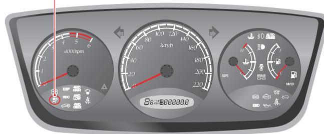
Al colocar el interruptor de ignición en la posición ON, esta luz indicadora se ilumina y se vuelve a apagar, para confirmar que el sistema de bolsas de aire está en funcionamiento. En caso de que no se encienda o apague, o si parpadea o ilumina en forma continua durante la conducción, significa que el sistema tiene una falla. Debe revisar inmediatamente el sistema de bolsas de aire con un Concesionario Ssangyong o Servicio técnico autorizado de Ssangyong.
