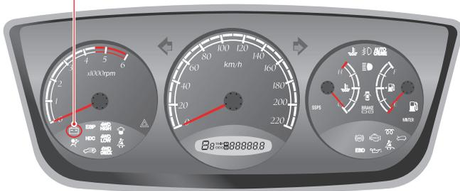
Esta luz de advertencia se enciende cuando el interruptor de ignición se enciende, y se apaga cuando el motor arranca. Si esta luz no se apaga cuando el motor arranca o se encienden durante la conducción, significa que el sistema tiene una falla. Debe revisar el sistema de carga con un Concesionario Ssangyong o Servicio técnico autorizado de Ssangyong.
