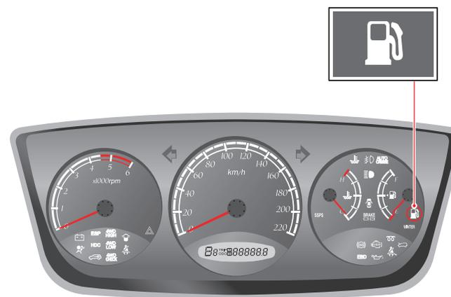
Esta luz de advertencia indica que el combustible está por agotarse. El tiempo que demora en encenderse varía según las condiciones operativas del vehículo o las condiciones del camino. No espere hasta que la luz se encienda para cargar combustible. Se recomienda agregar combustible ni bien se encienda esta luz.
