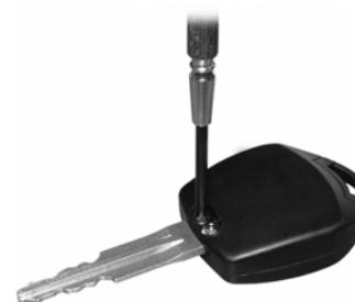
2. Levante la tapa haciendo palanca con un destornillador plano.
