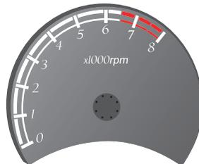
El tacómetro indica la velocidad del motor en revoluciones por minuto. Multiplica 1.000 al número actual para obtener el número actual de revoluciones del motor.
