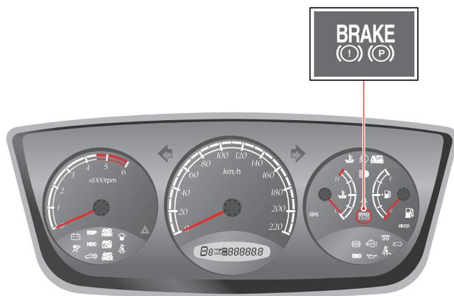
Esta luz indicadora se enciende cuando se aplica el freno de mano y/o el nivel de líquido de frenos es inferior al nivel especificado.
