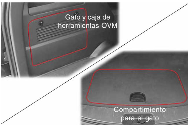
Las herramientas de emergencia como el gato, la conexión para el gato, entre otras, se guardan en el compartimiento para el gato en el lateral de la tercera fila y en el compartimiento para la conexión del gato en el piso.
