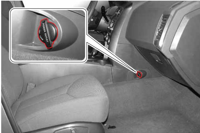
Un tomacorrientes auxiliar para dispositivos eléctricos adicionales está instalado en el tablero. Este tomacorrientes suministra energía cuando la llave de ignición está en la posición “ON” o “ACC”.
