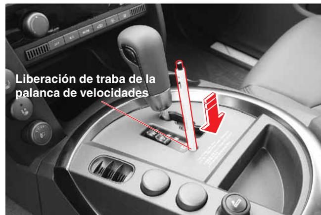
Si no puede cambiar la posición **“P”** con el interruptor de ignición en la posición **ON** y el pedal de frenos oprimido:
