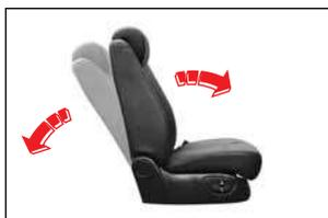
Ajuste de deslizamiento del asiento
