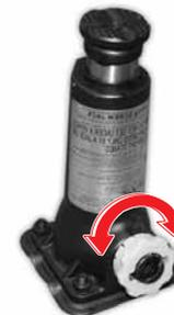
Al extraer el gato de la caja, primero baje la cabeza del gato para poder sacarlo con facilidad. Para guardar bien el gato en la caja nuevamente, levante la cabeza del gato después de colocar la parte posterior en la caja.
