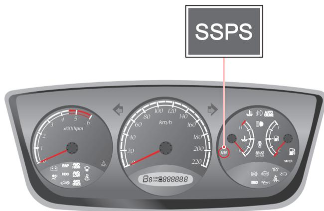
Esta alarma luminosa se enciende cuando el sistema SSPS está defectuoso. Cuando esta luz de advertencia se enciende, el esfuerzo de control de manejo se torna pesado.
