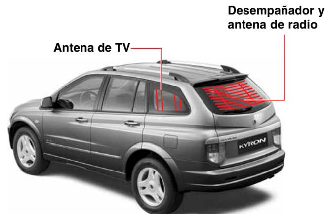
La antena en el cristal (para radio FM y AM) está ubicada en la parte superior e inferior de la ventanilla de la puerta trasera y el desempañador está ubicado en la parte central de la ventanilla de la puerta trasera. Las antenas de TV\* están instaladas a ambos lados del cristal de la puerta trasera.
