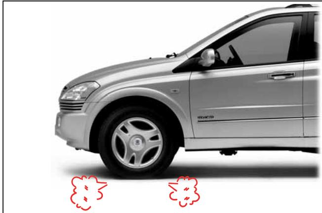
Si se desinfla un neumático mientras conduce, sujete firmemente el volante y levante el pie del acelerador. Disminuya la velocidad gradualmente y estacione su vehículo en un lugar seguro. Reemplace el neumático desinflado con un neumático de auxilio. Para este proceso, refiérase a las secciones sobre neumáticos de auxilio.
