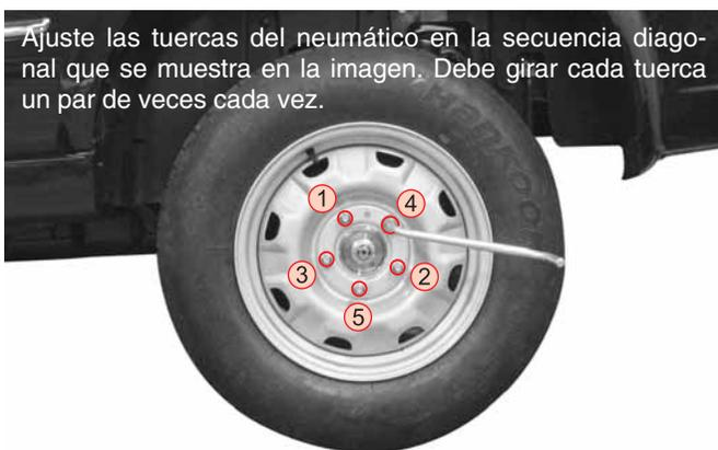
Ajuste las tuercas del neumático en la secuencia diagonal que se muestra en la imagen. Debe girar cada tuerca un par de veces cada vez.
