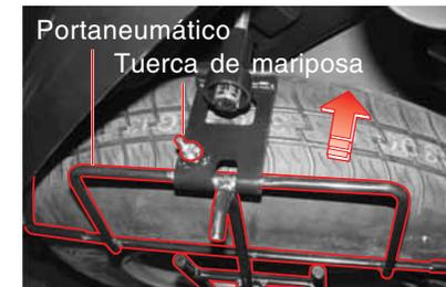
1. Utilice la llave inglesa para aflojar el perno de sujeción del portaneumático para el neumático de auxilio.
