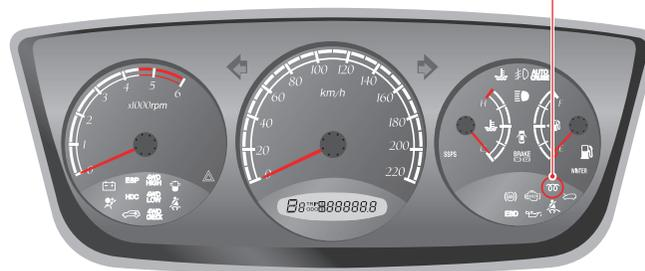
Este indicador se enciende cuando el interruptor de ignición se coloca en la posición "ON" y se mantiene encendido por un corto período de tiempo o se apaga inmediatamente. Cuando las bujías de ignición están suficientemente calientes, la luz se apagará. En los vehículos equipados con motor del tipo a inyección directa, este indicador puede encenderse por plazos muy breves o no encenderse.
