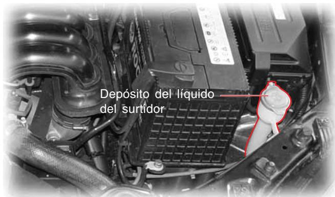
Revise frecuentemente el nivel de líquido del lavador y agregue el líquido especificado cuando sea necesario.
