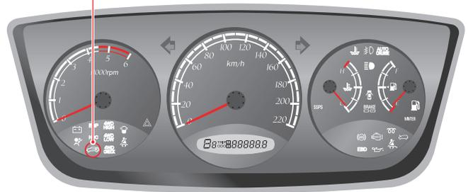
Este indicador se enciende cuando la llave de ignición está en comunicación con la unidad de control del motor (durante el arranque del motor) durante 0,5 segundos.
