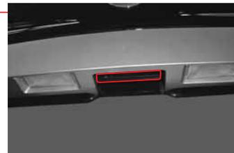
Para abrir la puerta trasera, destrábela y jale de la palanca hacia arriba.
