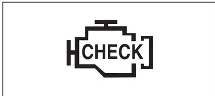
El Indicador de Revisión del Motor en el tablero de instrumentos se enciende cuando los sistemas de combustible o electrónicos principales del motor no funcionan correctamente. Como resultado, la potencia de salida del motor podría disminuir o el motor podría detenerse en forma involuntaria. Si esto sucede, visite al distribuidor o servicio técnico autorizado de Ssangyong más cercano.
