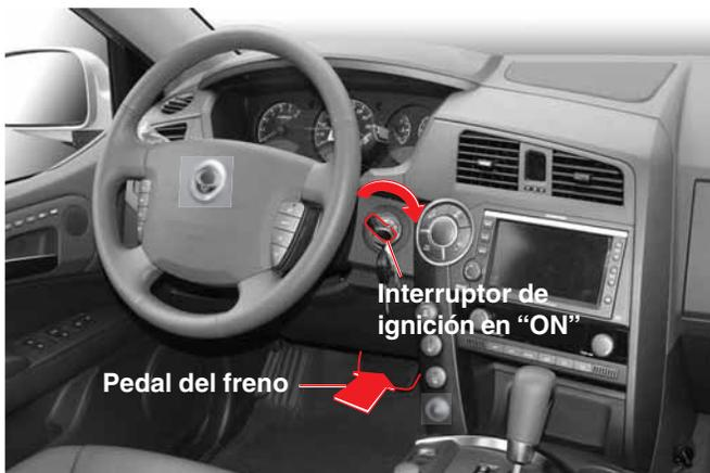
Para pasar de la posición **“P”** a otra posición, el interruptor de ignición debe estar en la posición **ON** y el pedal de frenos oprimido.
