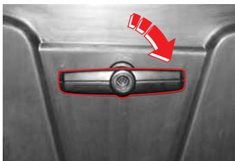
Destrahe la puerta trasera y gire la palanca en dirección horaria. Luego jale de la puerta trasera para abrirla.
