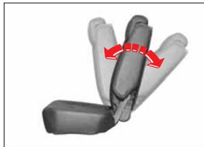
Para cambiar el ángulo de reclinación del respaldo del asiento, inclínese un poco hacia delante y levante la palanca (A). Luego, reclínese hacia atrás y libere la palanca en la posición deseada. Después de realizar este ajuste, asegúrese de que la palanca vuelva a su posición original y que el respaldo del asiento quede trabado.
