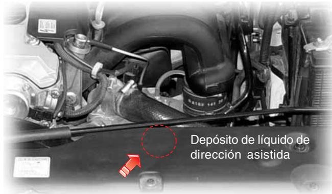
Estacione el motor en una superficie plana, apague el motor y revise el nivel del líquido. El nivel del líquido debe estar entre las marcas MIN y MAX del medidor de la tapa del depósito. Si es inferior a la marca MIN, agregue el líquido especificado hasta llenar el depósito. Utilice sólo líquidos especificados. La diferencia entre las marcas MÍN y MÁX muestra fluctuaciones del líquido de dirección cuando está caliente y cuando está frío.
