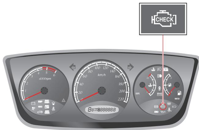
Si la luz continua encendida o se enciende durante la conducción, indica que algunos componentes de control del motor incluso los sensores y dispositivos no funcionan correctamente.
