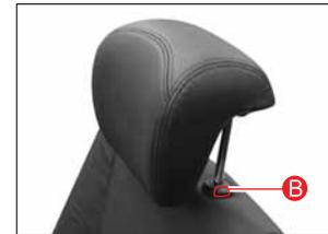
Para levantar el apoyacabeza, jale hacia arriba sin presionar el botón de liberación. Para bajar el apoyacabezas, presione el botón de liberación (B) en la parte superior del respaldo del asiento y empuje el apoyacabezas hacia abajo.
