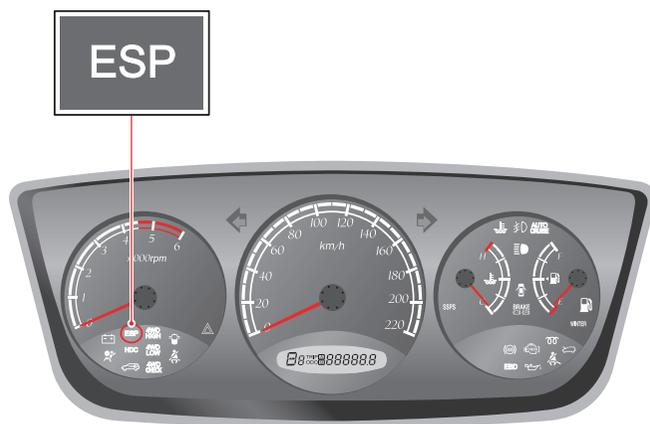
Si oprime el interruptor ESP<sub>OFF</sub>, la función ESP se detendrá y la luz indicadora en el tablero de instrumentos se encenderá. Si la función ESP funciona, la luz del indicador parpadea.
