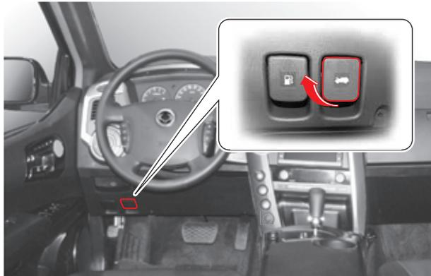
1. Para abrir el capó, jale de la perilla de liberación, ubicada en el lado inferior izquierdo del volante, para descorrer el pestillo del capó.
