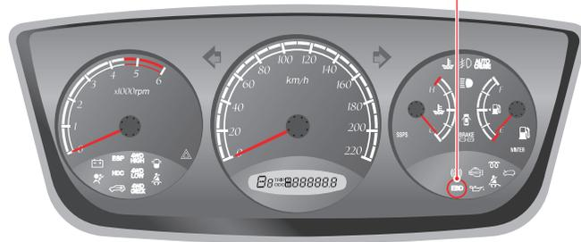
Esta el interruptor de ignición se gira a la posición "ON", esta luz se enciende y se apaga cuando el sistema está en condición normal. Si el sistema EBD no está en condición normal, la luz de advertencia permanece encendida.
