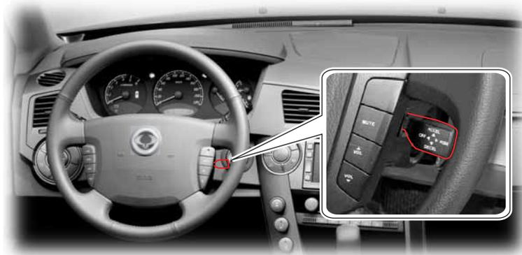
El control de velocidad es un sistema de control de velocidad automático que mantiene la velocidad de conducción deseada sin utilizar el pedal del acelerador.
