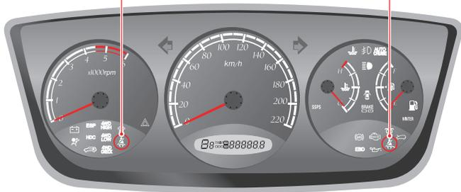
Cuando el interruptor de ignición está en la posición "ON" y el cinturón de seguridad del conductor no está colocado, la luz del recordatorio se enciende y suena la alarma de advertencia de cinturones de seguridad durante 6 segundos. Esta operación de recordatorio se detiene cuando el conductor se coloca el cinturón de seguridad, incluso durante el período operativo.
