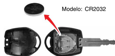
3. Extraiga la pila y coloque una nueva.
