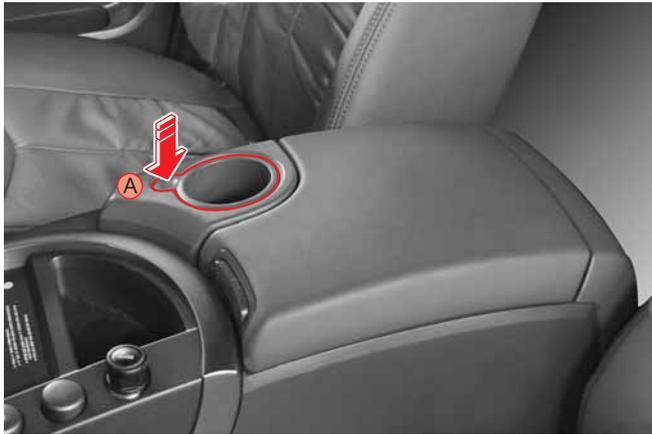
El soporte se levanta al presionar (A).
