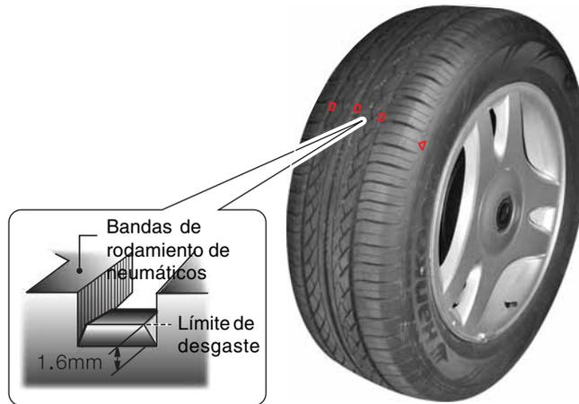
Los neumáticos en su vehículo tienen instalados indicadores de desgaste de bandas de rodamiento entre las ranuras de las bandas. El neumático debería ser reemplazo cuando el indicador de desgaste aparece en dos o más ranuras adyacentes.
