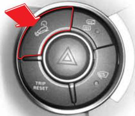
Al presionar una vez este botón, la función HDC está lista para ser usada. El indicador HDC verde en el tablero de instrumentos se enciende. Al presionar nuevamente este botón, la función HDC se desactiva y el indicador se apaga.
