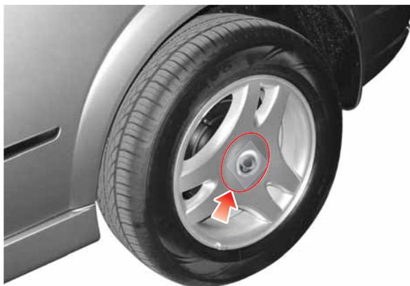
1. Levante la tapa de la rueda haciendo palanca con un destornillador plano.
