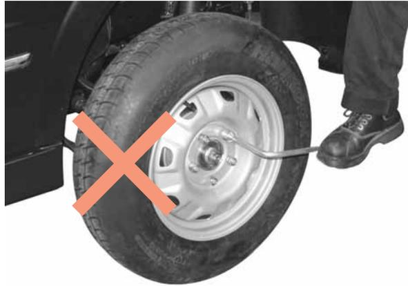
No ajuste demasiado las tuercas de la rueda porque podrían dañarse. No ajuste demasiado las tuercas de la rueda presionando la llave inglesa con el pie o utilizando un tubo.
