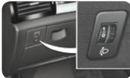
Para los vehículos equipados con lámparas halógenas, en función de la carga de su vehículo, se recomienda corregir su reglaje.
