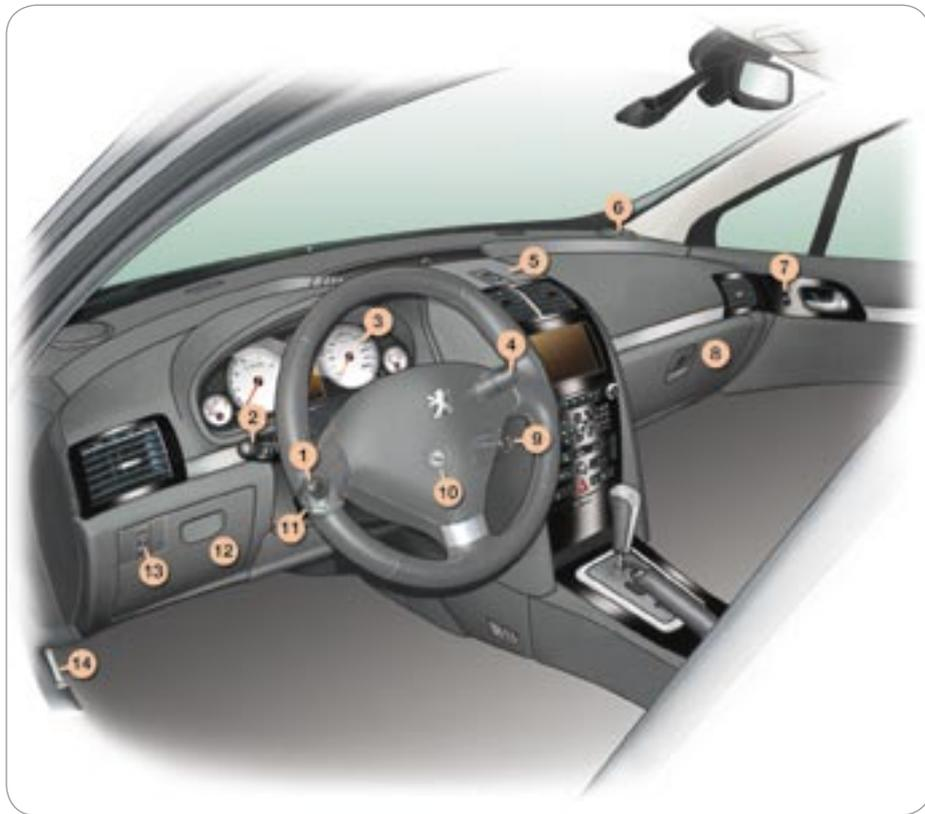
1. Reglaje en altura y en profundidad del volante.
