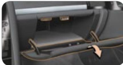
Está provista de una cerradura. Para abrirla, levante la empuñadura. Al abrir la tapa se enciende una luz.
