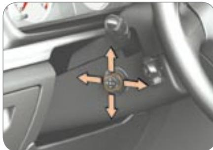
Parado, ajuste la altura o la profundidad del volante desplazando el mando :
