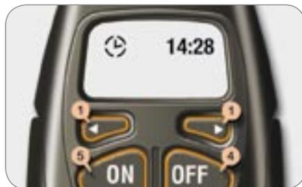
Después de ver la hora, con la ayuda de las teclas **1**, pulse en los 10 segundos siguientes, simultáneamente en las teclas **4** y **5**.
