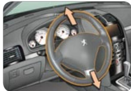
Al abrir la puerta conductor y contacto quitado, el volante sube para facilitar el acceso o la salida de su vehículo.
