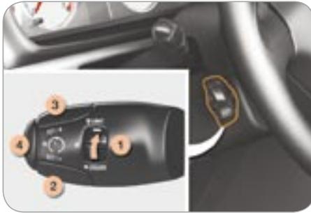
Permite mantener, de manera constante, la velocidad del vehículo programada por el conductor.
