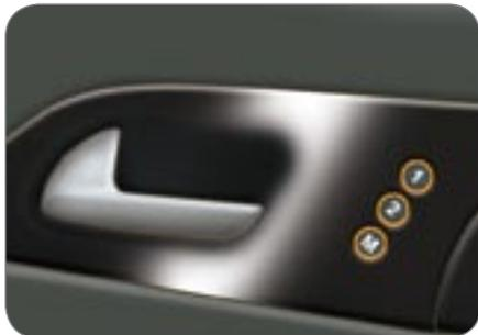
La memorización tiene en cuenta el reglaje eléctrico del cojín del asiento y de los retrovisores exteriores.
