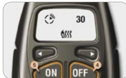
Pulse en la tecla **5** (ON) hasta que aparezca el mensaje **"OK"**.
