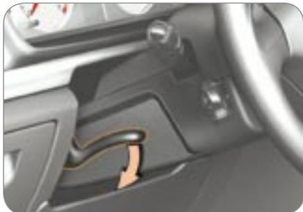
Parado, desbloquee el volante empujando hacia delante el mando.
