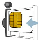
Instale la tarjeta SIM en el soporte e insértela a continuación en la trampilla.
