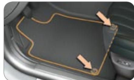
Para el desmontaje de la alfombra lado conductor, retroceda el asiento al máximo y retire las fijaciones.
