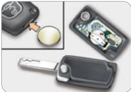
Si después de haber cambiado la pila, el telemando sigue estando inoperativo, efectúe un procedimiento de reiniciación.
