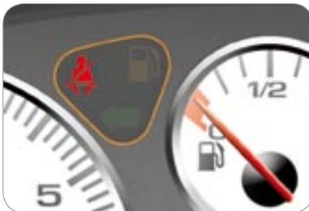
Nada más **poner el contacto**, si un pasajero delantero no se ha abrochado su cinturón de seguridad y si la velocidad del vehículo es **inferior a 20 km/h**, usted está avisado por el **testigo de cinturón** que se enciende.
