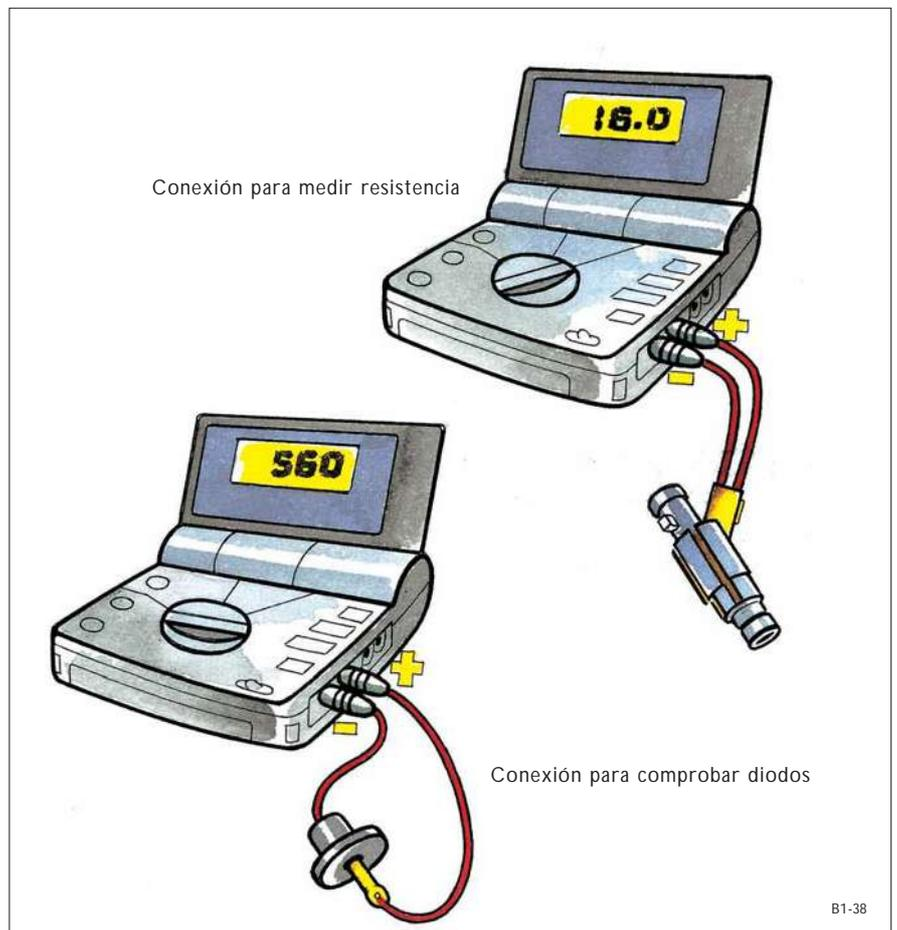
Conexión para medir resistencia
