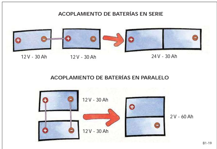
paralelo, cada tipo de acoplamiento proporciona unas características eléctricas de tensión nominal y capacidad diferentes:
