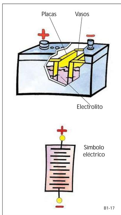
Uno de los métodos más comunes de producir electricidad es el químico: la batería de plomo es una fuente de corriente continua que se basa en este principio; está formada por varios elementos acumuladores o vasos que se conectan formando una batería.
