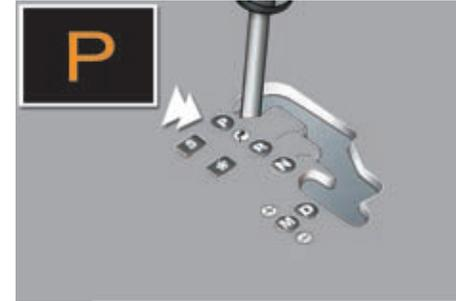
Cuando se desplaza la palanca por la rejilla para seleccionar una posición, el testigo correspondiente se enciende en el cuadro de a bordo.
