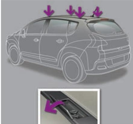
Para instalar las barras de techo transversales, utilice las cuatro fijaciones rápidas previstas a este efecto:
