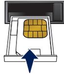
Instale la tarjeta SIM en el soporte y, a continuación, en la trampa.
