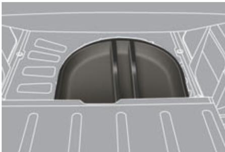
☞ Levante la alfombra de maletero, enganchando los dos cordones en los ganchos, y acceda al cajón de colocación.
