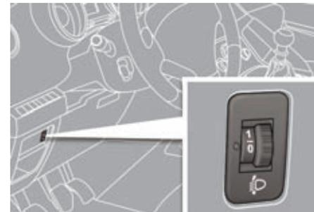
Para no molestar a los demás usuarios de la vía, debe regularse la altura de los faros con lámparas halógenas, en función de la carga del vehículo.
