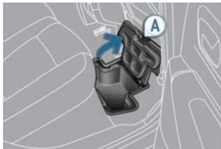
Según la configuración, el vehículo está equipado con unos espacios de almacenamiento bajo los pies, situados delante de los asientos traseros laterales. Puede accederse a ellos mediante las trampillas, dotadas cada una de ellas de una empuñadura de agarre **A**.
