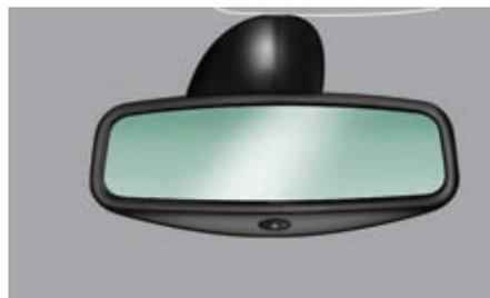
Gracias a un sensor que mide la luminosidad procedente de detrás del vehículo, este sistema realiza progresivamente y de forma automática el paso entre los modos día y noche.
