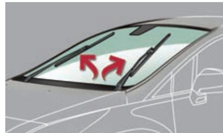
Esta posición permite separar las escobillas del parabrisas delantero.
