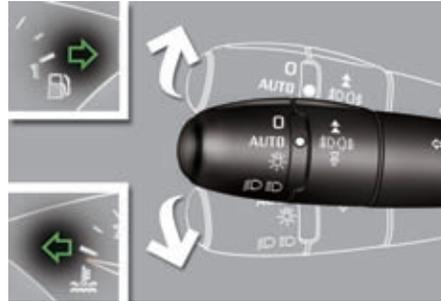
Accione el mando de luces hacia arriba o hacia abajo sobrepasando el punto de resistencia. Los indicadores de dirección correspondientes parpadearán mientras el mando permanezca en esa posición.
