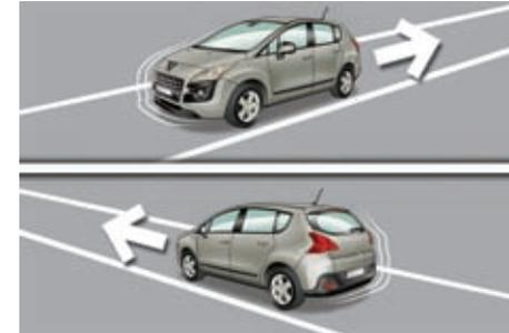
El vehículo está equipado con un sistema que lo mantiene inmobilizado un instante (aproximadamente 2 segundos) para facilitar el arranque en pendiente, dando tiempo al conductor para pasar del pedal del freno al del acelerador.
