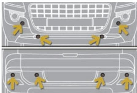
Sistema formado por cuatro sensores de proximidad, instalados en el paragolpes delantero y/o trasero.
