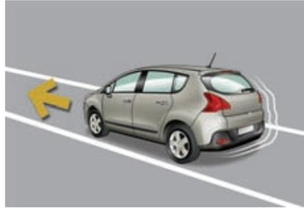
**En subida, con el vehículo parado, éste se mantiene un momento después de soltar el pedal del freno:**
