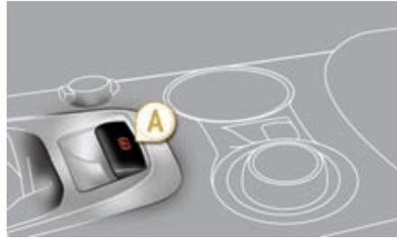
En caso de fallo de la frenada con el pedal del freno o en situaciones excepcionales (por ejemplo: malestar del conductor, conducción acompañada...), **tirar de forma continua del mando A permite parar el vehículo.**
