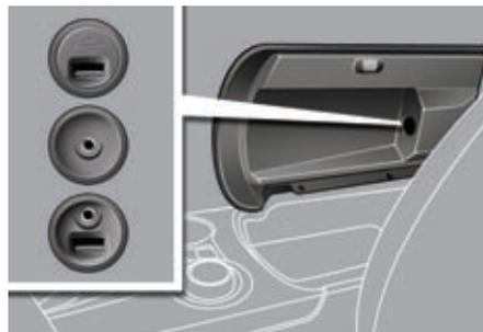
Este cajetín de conexiones, compuesto por una toma JACK y/o USB, está situado en el reposabrazo delantero (debajo de la tapa).
