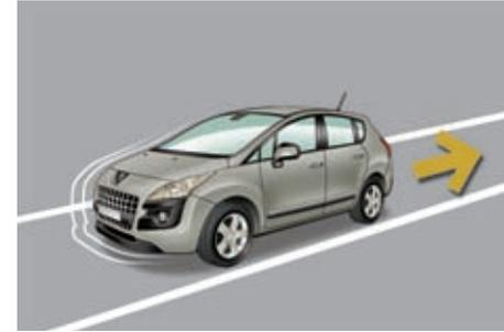
**En bajada, con el vehículo parado y la marcha atrás introducida, el vehículo se mantiene un instante después de soltar el pedal del freno.**
