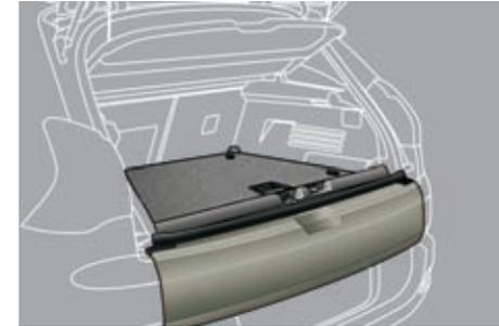
Posición alta (50 kg como máximo), con el portón inferior cerrado para aislar la parte inferior del maletero.
