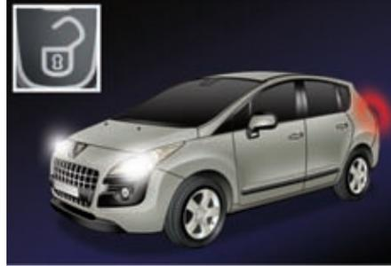
Cuando el sensor detecta que la luminosidad es reducida, el encendido a distancia de las luces de cruce y de posición facilita la llegada al vehículo. Esta función se puede programar desde el menú de configuración.
