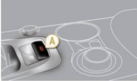
Con el vehículo parado, para accionar el freno de estacionamiento, tanto con el motor en marcha como parado, **tire** del mando **A**.
