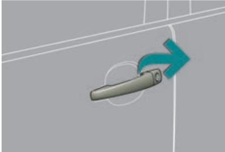
☞ Después del desbloqueo total del vehículo con el mando a distancia o con la llave, tire de la empuñadura de la puerta.
