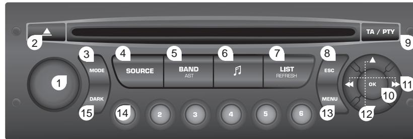
1. Encendido/Apagado y ajuste del volumen.
