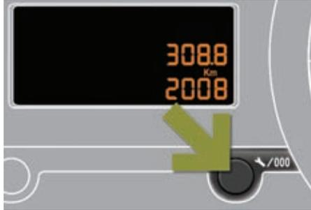
Los kilometrajes total y parcial se muestran durante treinta segundos al cortar el contacto, al abrir la puerta del conductor, así como al bloquear y desbloquear el vehículo.
