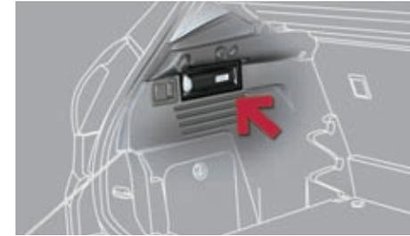
Iluminación amovible, integrada en la pared del maletero, que sirve para iluminar el maletero y como linterna.
