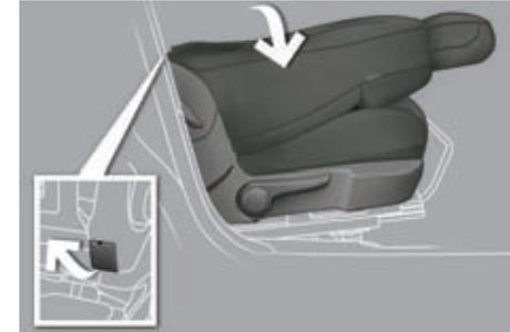
Permite colocar objetos en su superficie o facilitar la carga de objetos largos en el interior del vehículo.
