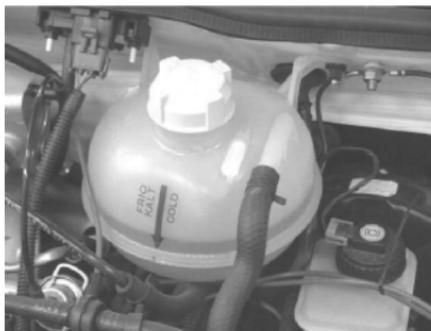
Si no fuera posible identificar el problema, y el nivel de líquido de enfriamiento no estuviese al máximo, añada al tanque de recuperación una mezcla de agua y líquido protector para radiador a razón de 50%.
