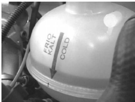
Con el sistema de enfriamiento frío, el nivel de anticongelante en el depósito de compensación debe encontrarse un poco por encima de la marca "COLD" (frío). Con el motor caliente a la temperatura de servicio, éste sube, volviendo a bajar al enfriarse el motor. Si el nivel desciende por debajo de la marca debe rellenarse hasta un poco por encima de dicha marca.
