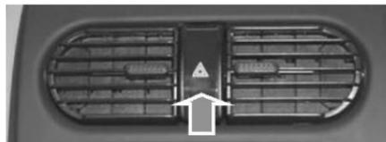
Presione el botón que se encuentra entre las rejillas de ventilación para activar las luces de emergencia.
