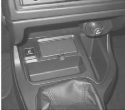
El encendedor de cigarros se encuentra debajo del portaobjetos o bien del radio. Presionar el encendedor de cigarros estando el encendido conectado. El encendedor se desconecta cuando está incandescente la resistencia en espiral. Extraerlo entonces.
