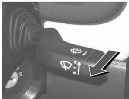
Presionar hacia adelante la palanca. Primera posición (pos. fija) = Limpiado
