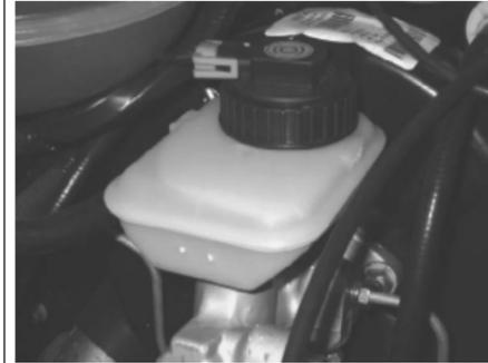
**PRECAUCIÓN: El líquido de frenos es corrosivo y ataca la pintura del vehículo.**
