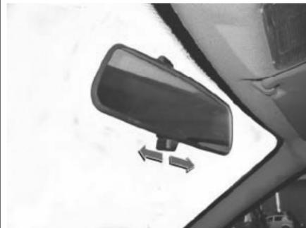
Espejo retrovisor interior: ajustar a la altura (articulación en el parabrisas).
