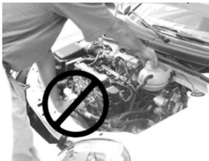
**PRECAUCIÓN:** Para evitar lesiones, mantenga las manos, herramientas y la ropa lejos del ventilador de enfriamiento. El ventilador puede encenderse si el vehículo está encendido o no lo está. El ventilador se enciende automáticamente en respuesta a un sensor de calor cuando la llave de ignición está en la posición "RUN" (conectado).
