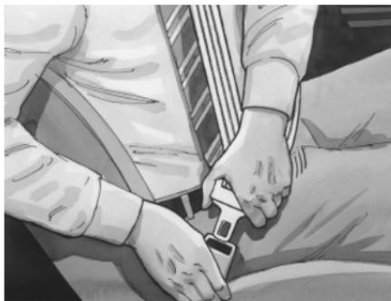
Insertar la lengüeta en la hebilla. El respaldo del asiento no debe estar demasiado reclinado hacia atrás. El cinturón abdominal debe estar sin retorcer y bien adaptado. Tense a menudo durante el viaje el cinturón mediante un tirón en el cinturón torácico.
