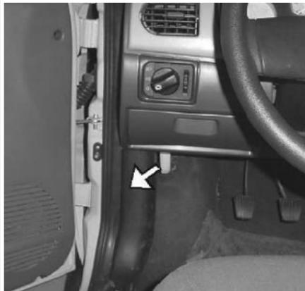
Tirar de la palanca del cierre de seguridad del cofre que se encuentra debajo del tablero de instrumentos en el lado del conductor. El cofre se libera y se levanta unos centímetros.
