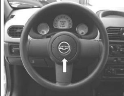
Presionar el centro del volante para hacerlo funcionar.
