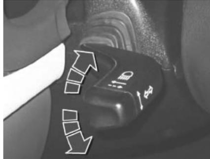
Para indicar un cambio de vía en la carretera, presionar la palanca en la dirección necesaria solamente hasta que se perciba una cierta resistencia; al soltarla vuelve inmediatamente a su posición inicial.
