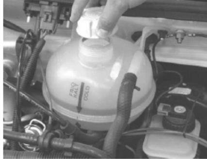
El nivel líquido de enfriamiento deberá estar al máximo. De no ser así, esto advierte la posibilidad de fuga en las mangueras del radiador, mangueras del calefactor, radiador o bomba de agua.
