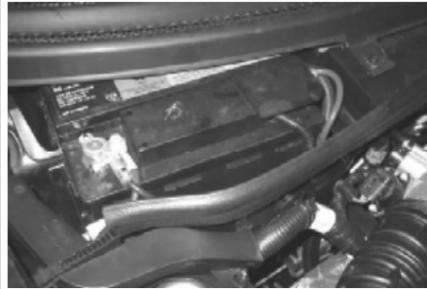
Su vehículo está equipado con una batería que no requiere mantenimiento (No hay que destapar para agregar electrolito).
