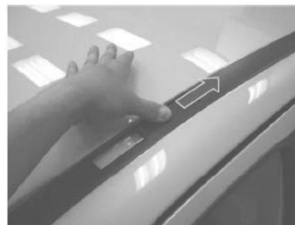
Existen 4 puntos de fijación en el techo para instalación del portaequipajes.
