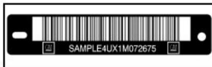
Esta es la identificación legal de su vehículo. Aparece en una placa adherida a la parte superior izquierda del tablero de instrumentos. Esta placa se puede ver fácilmente a través del parabrisas. El VIN aparece en la Factura del Automóvil. No intente limpiar la placa VIN con algún solvente; use un trapo húmedo para quitar el polvo.
