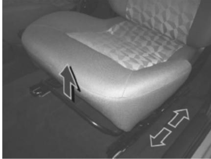
No variar nunca la posición del asiento del conductor estando en marcha el vehículo porque puede suceder que el asiento se desplace incontroladamente con la palanca liberada.
