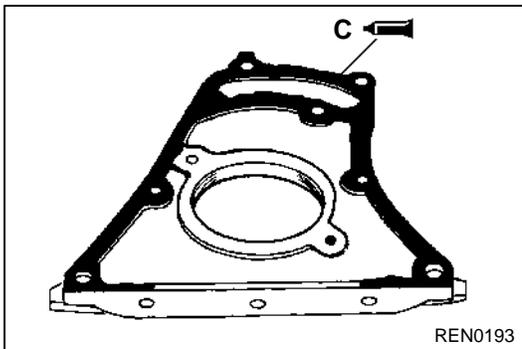
**PUNTOS DE SERVICIO PARA LA INSTALACION****▶A◀ INSTALACION DE LA PLACA DELANTERA DEL BLOQUE DE CILINDROS**
