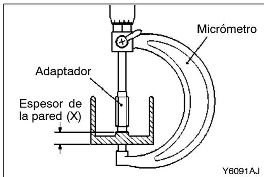
(5) Utilizando un micrómetro, medir el espesor de la pared (X) del levantaválvulas, y anotar el valor medido.
