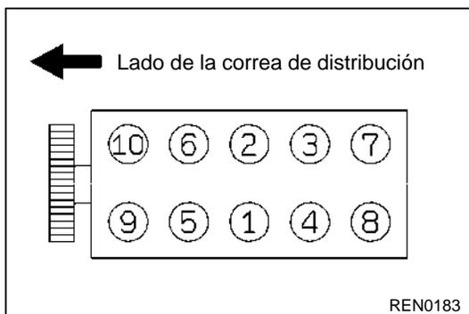
**►E◄ INSTALACION DEL PERNO DE LA CULATA DE CILINDROS**
