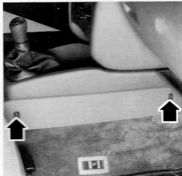
Fijaciones laterales de la consola de suelo (vista lado derecho, idéntico lado izquierdo).
