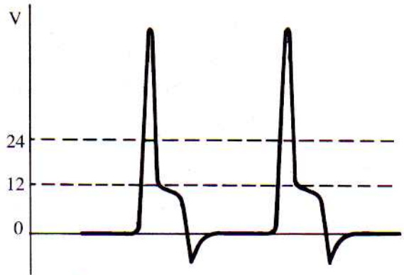
Onda del voltage entre plátinos
