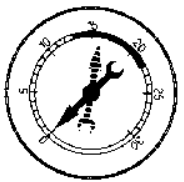
ESCAPE OBSTRUIDO (DESCIENDE HACIA CERO A MEDIDA QUE AUMENTAN LAS RPM DEL MOTOR)
