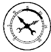
MUELLES DE VALVULAS DESGASTADOS (MAS PRONUNCIADO AL AUMENTAR LA VELOCIDAD DEL MOTOR)
