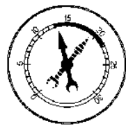
GUIAS DE VALVULAS DESGASTADAS (SE ESTABILIZA AL AUMENTAR LA VELOCIDAD DEL MOTOR)
