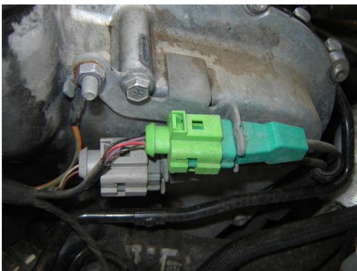
**Fig. 5 Ubicación de los conectores para sensores de detonación.** Conector verde de sensor de detonación 1 (G61) y conector gris para sensor 2 (G66).
