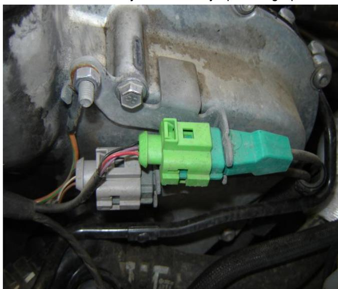
**Fig. 22 Ubicación de los conectores para sensores de detonación.** Conector verde de sensor de detonación 1 (G61) y conector gris para sensor 2 (G66).
