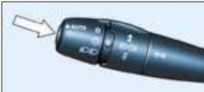
Un impulso en la tecla situada en el extremo del mando de luces permite repetir la última información vocal, o, dar un mensaje vocal y una señalización más precisa de la próxima topografía.
