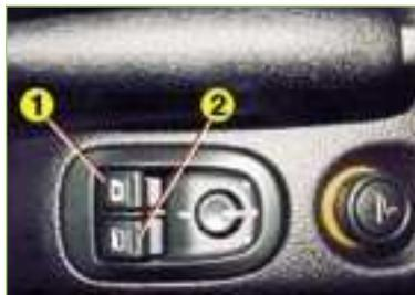
Pulse el interruptor sobrepasando el punto de resistencia :
