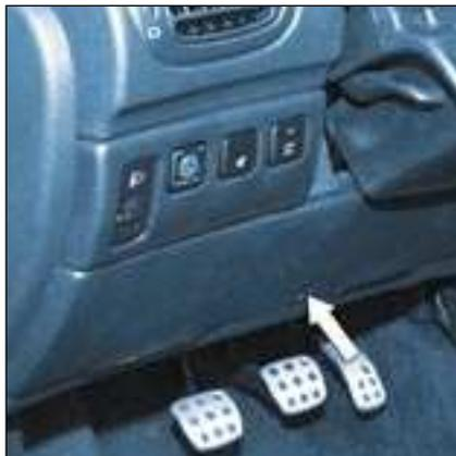
Los fusibles de recambio y la pinza **A** están fijados en el interior de la caja de fusibles del panel de instrumentos.
