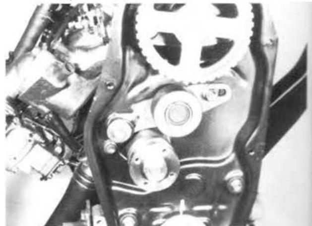
5) Antes de instalar la correa de distribución a la polea del árbol de levas y la polea de la correa de distribución del cigüeñal, afloje todos los tornillos de ajuste de la válvula de admisión y de escape balancines brazos
