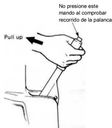
2) Freno de estacionamiento ajuste recorrido de la palanca
