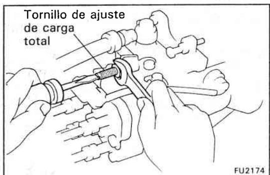
(d) Ajuste girando el tornillo de ajuste de carga total.
