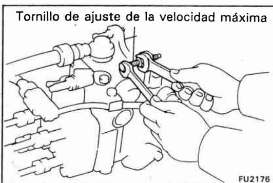
(b) Ajuste girando el tornillo de ajuste de velocidad máxima.
