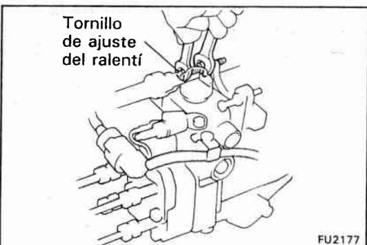
(b) Ajuste girando el tornillo de ajuste del ralentí.
