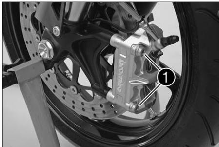
Retirar los tornillos **[1]** de la pinza del freno y sacar hacia atrás cuidadosamente la pinza del freno del freno de disco.
