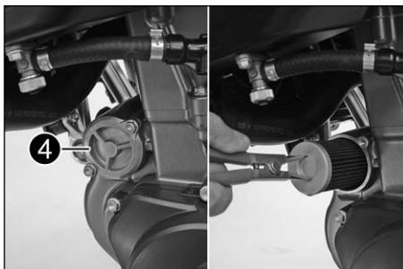
Retirar la tapa del filtro del aceite [4] y sacar el filtro del aceite con un alicate para anillo seeger (al revés) del cárter del motor.
