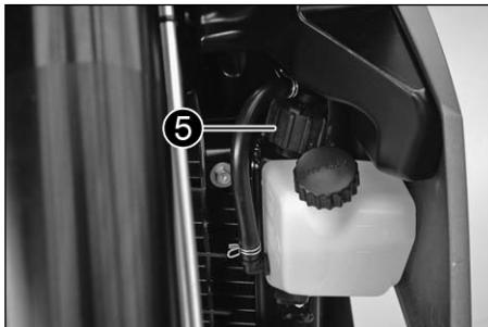
Como líquido refrigerante se utiliza una mezcla de 50 % de agente anticongelante y 50 % de agua destilada. Su temperatura mínima de protección es de - 25° C. Esta mezcla además de ser un buen anticongelante protege también de la corrosión, por este motivo no debe ser nunca sustituida por agua pura.
