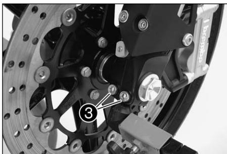
Apretar los tornillos de fijación [3] en ambos asientos del eje de la rueda con 15 Nm. Accionar el freno de mano hasta que exista el punto de presión y examinar si la rueda delantera se deja girar fácilmente. Retirar el caballete trasero.
