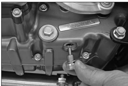
Montar el tornillo de vaciado del aceite con un nuevo anillo de retención y apretarlo con 20Nm.
