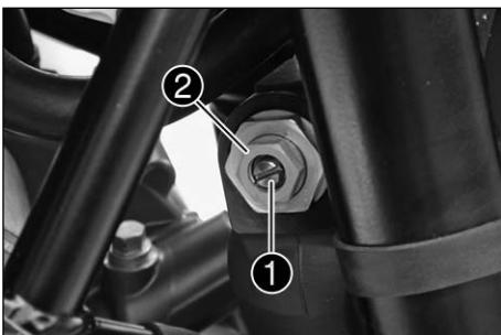
El tornillo de ajuste **[1]** para el ámbito de Lowspeed puede ser ajustado con un destornillador.
