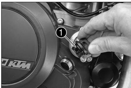
Desatornillar el tornillo de cierre [1]. Llenar 2 litros de aceite de motor totalmente sintético 10W/60 según la norma JASO MA (por ej. Motorex Cross Power 4T 10W/60) y montar el tornillo de cierre. Encender el motor y dejarlo calentar en ralentí hasta que alumbré 5 barras del indicador de la temperatura. Apagar el motor y examinar el nivel del aceite (véase examinar el nivel del aceite del motor).
