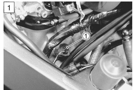
**DATA** Voltaje del sensor ECT: 4,5 – 5,5 V
