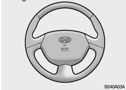
Su vehículo Hyundai está equipado con el sistema de airbag Suplemental Restraint System. La presencia de este sistema viene indicada por las letras "SRS AIR BAG" grabadas en la tapa del airbag en el volante y en el panel frontal del lado del acompañante, sobre la guantera.
