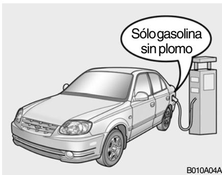
En el vehículo Hyundai deberá ser utilizada gasolina sin plomo con un Índice de Octano N° 91 o superior. Si fuera utilizada gasolina con plomo causaría un funcionamiento defectuoso del catalizador inutilizándolo y haciendo ineficaz su sistema de control de emisión de gases. Ello produciría además un costo adicional en los gastos de mantenimiento del vehículo. Para evitar el uso accidental de gasolina con plomo, la boca de mayor diámetro utilizada para llenado de gasolina con
