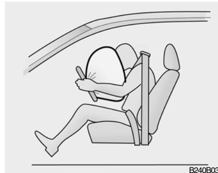
La combinación del Airbag inflado en su totalidad y el uso apropiado del cinturón de seguridad, disminuye el movimiento hacia adelante del conductor, o del acompañante, y por lo tanto, reduce el riesgo de sufrir lesiones en la cabeza o el pecho.
