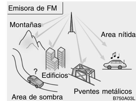
Las ondas de FM son de alta frecuencia y no pueden curvarse para seguir la curvatura de la tierra. Como consecuencia de esto las ondas de FM se comienzan a perder a corta distancia de la emisora. Además este tipo de señal es fácilmente afectada por los edificios, cerros u otros tipos de obstáculos. Esto ocasiona que usted crea que existe algún tipo de problema con su equipo de radio. Las siguientes condiciones son normales y no indican problema de su radio:
