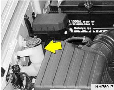
El depósito limpiaparabrisas proporciona agua para lavar los parabrisas. Se debe poner un líquido de buena calidad en el depósito. El nivel debe ser verificado de forma más constante cuando existe mal tiempo o cuando este sistema se emplea muy seguidamente. La capacidad del depósito de reserva es de 4,5 litros.
