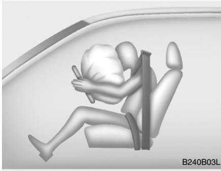
Al desplegarse el Airbag, las costuras del forro del volante de dirección se separarán debido a la presión provocada por la expansión del Airbag. Al abrirse los forros se producirá la total expansión del Airbag.
