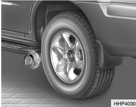
Instale de nuevo el tapacubos montando el saliente de anclaje del tapacubos en la ranura de la rueda, y golpee el centro del tapacubos con la mano.
