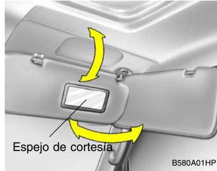
Su vehículo Hyundai está equipado con viseras para proporcionar protección frontal o lateral contra el sol para el conductor y su acompañante. Para reducir el deslumbramiento o protegerse contra la luz directa del sol. La visera del acompañante están dotadas de espejos de cortesía.
