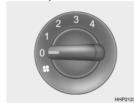
Este se utiliza para conectar o desconectar el ventilador y para seleccionar su velocidad.
