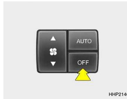
Presionar el botón "OFF" para detener el funcionamiento de los sistemas de calefacción o refrigeración.
