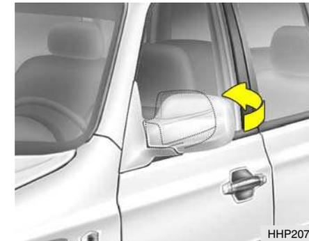
Para plegar los espejos exteriores, empújelos hacia atrás. Los espejos se pueden plegar para aparcar en sitios muy estrechos.
