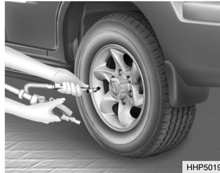
Si usted tiene un medidor de presión de neumáticos, revise la presión. Si esta bajo lo recomendado, conduzca despacio a la estación de servicio más próxima, e ínflala a la presión recomendada. Si esta muy alta, ajústela a la presión correcta. Si la tapa no se vuelve a poner, la válvula puede llenarse de polvo o mugre y provocar que la válvula pierda aire. Si la válvula pierde aire, compre otra y reemplácela, lo más pronto posible.
