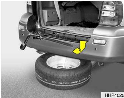
2. Inserte la barra de la rueda de recambio en el agujero situado en la parte superior del parachoques trasero.
