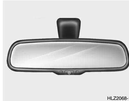
El retrovisor interior eléctrico de adaptación al día y a la noche regula automáticamente el deslumbramiento de los faros del vehículo de atrás.
