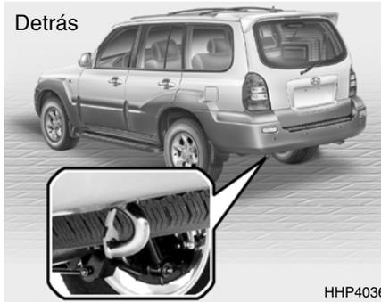
En caso de tener que remolcar el vehículo por producirse una emergencia y si no está disponible ninguna grúa comercial, acople un cable de remolque, una cadena o una correa a uno de los ganchos a tal efecto situados en la parte inferior delantera y trasera del vehículo. Extremar las precauciones al llevar a cabo esta operación si el vehículo se encuentra en una superficie no asfaltada para evitar producir daños en el mismo.
