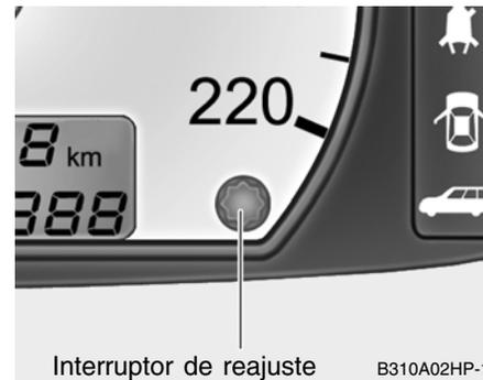
Al pulsar el botón de reajuste en la parte inferior derecha del velocímetro durante menos de 1 segundo al girar la llave de encendido a "ON" se visualiza la secuencia siguiente:
