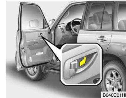
Las puertas pueden ser cerradas sin necesidad de utilizar la llave. Para cerrarlas desde el exterior, presionar primero el interruptor interior de cierre a la posición "LOCK" de manera que la marca roja del interruptor quede oculta y después cerrar la puerta. La puerta no se cerrará si la llave de contacto permanece puesta en la cerradura cuando se cierran las puertas delanteras. Esto es normal.
