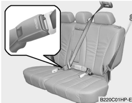
Cuando se desee soltar el cinturón de seguridad, presionar el pulsador situado en la hebilla de bloqueo.
