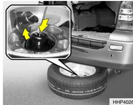
5. Extraiga la placa de elevación de la parte central de la rueda de repuesto tras descender completamente la misma.
