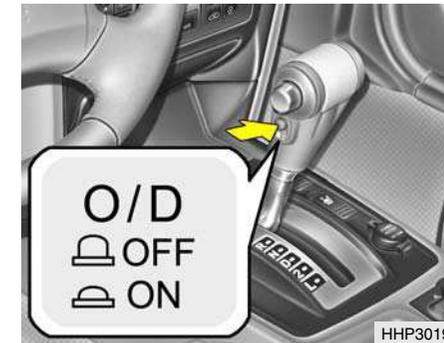
Cuando está activado el interruptor del overdrive, la caja de cambios automática cambia a cuarta velocidad después de segunda y tercera. Si el interruptor no se activado, no se podrá alcanzar la cuarta.
