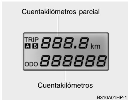
El cuentakilómetros digital graba la distancia total conducida en kilómetros o millas, y es útil para mantener un registro de los intervalos de mantenimiento.
