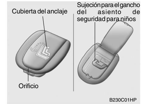
1. Abra la cubierta del anclaje situada en el suelo, detrás del asiento trasero, introduciendo la llave en el orificio.
