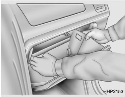
2. Baje completamente la guantera empujando ambos lados de la misma hacia dentro.
