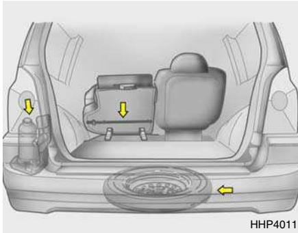
o Saque el neumático de recambio, el gato y la bolsa de herramientas.
