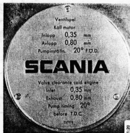
Fig. 11. Placa en la tapa de las válvulas
