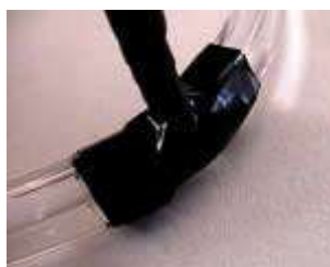
Cinta aisladora asegurando y protegiendo los LEDs
