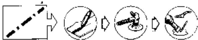
Después de pintar y antes de guarnecer, efectuar el tratamiento de los cuerpos huecos (parte interna del panel de aleta).
