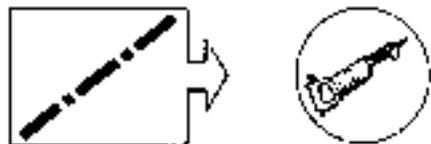
Antes de efectuar el corte del bajo de caja sobre el vehículo, es necesario desgrapar los puntos de soldadura eléctrica en la unión del bajo de caja con su tabique longitudinal.
