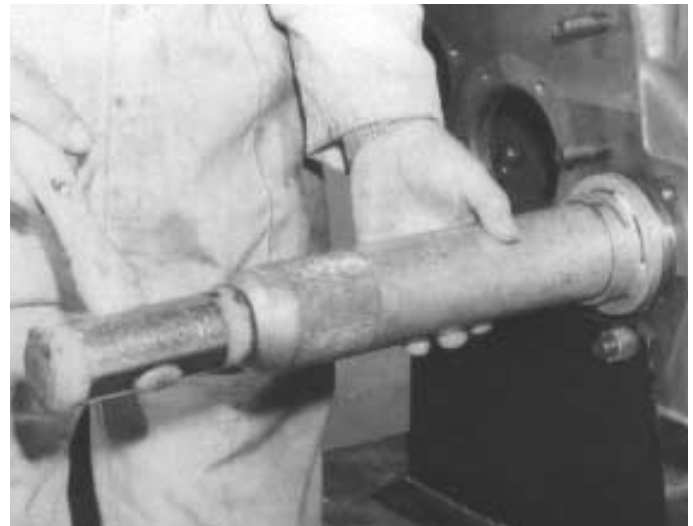
12. Fijar el cojinete delantero del eje secundario en el eje, con la ranura del anillo elástico en la parte de más afuera posible, y empleando un montador adecuado, meter el cojinete en el eje y en la carcasa.
