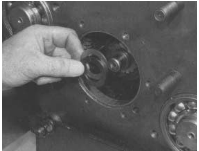
9. Colocar el cojinete de bolas de empuje del eje principal en la espiga de este último, con la arandela de empuje de acero encarada al eje. Aplicarle vaselina.
