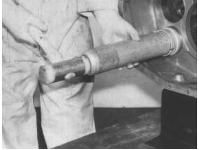
11. Valiéndose de un montador apropiado, meter el cojinete en el eje y en la carcasa. Montar el anillo elástico de retención en el eje.
