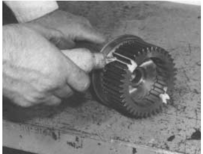
8. Pintar señales de puesta a punto en dos dientes cualesquiera adyacentes del engranaje conductor, y en dos dientes exactamente enfrente de los dos primeros.
