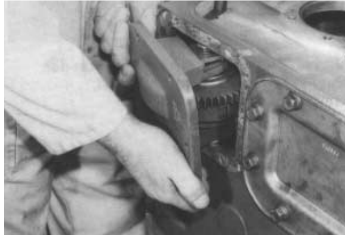
23. Sacar del fondo de la caja el freno de cambios hacia arriba.
