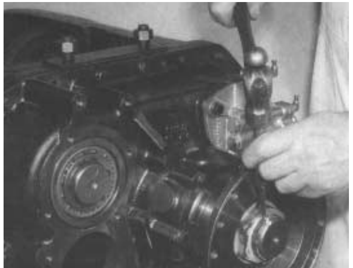
22. Apretar la tuerca con brida al par correcto. Meter la tuerca bien metida en la estría del eje.
