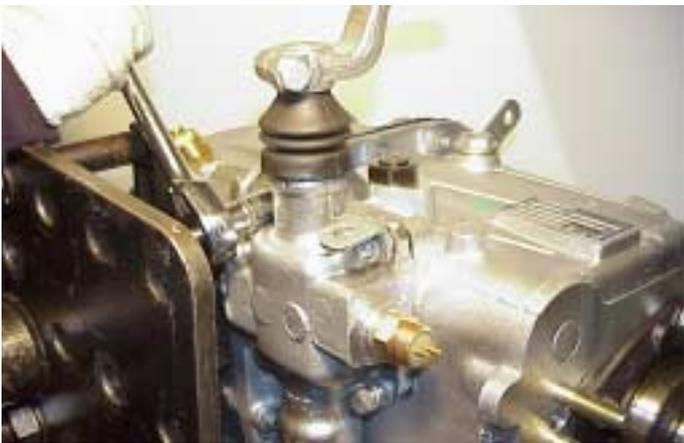
45. Ajuste los tornillos a un par de apriete de 35 a 39 Nm.
