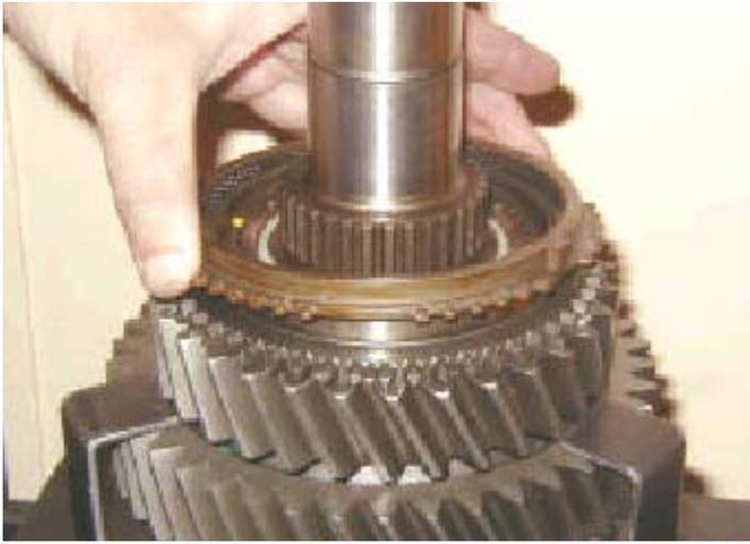
8. Lubricar el collarín de sincronización de la 3ª y montar el anillo sincronizador.
