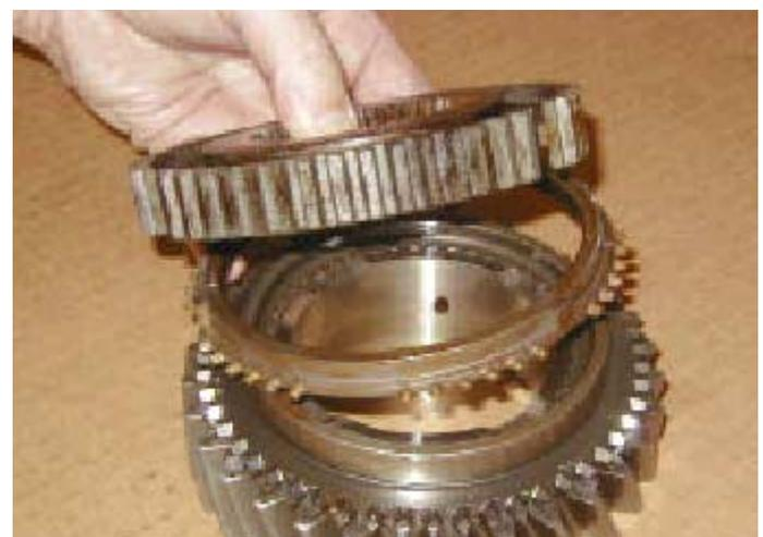
17. Sacar el cubo sincronizador y el anillo sincronizador.
