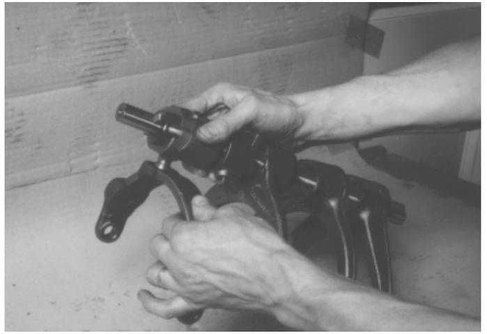
5. La horquilla de 5a/6a se cambia por un selector en las unidades con superdirecta. Compruebe que el selector cabe bien antes de montar la caja de cambios.
