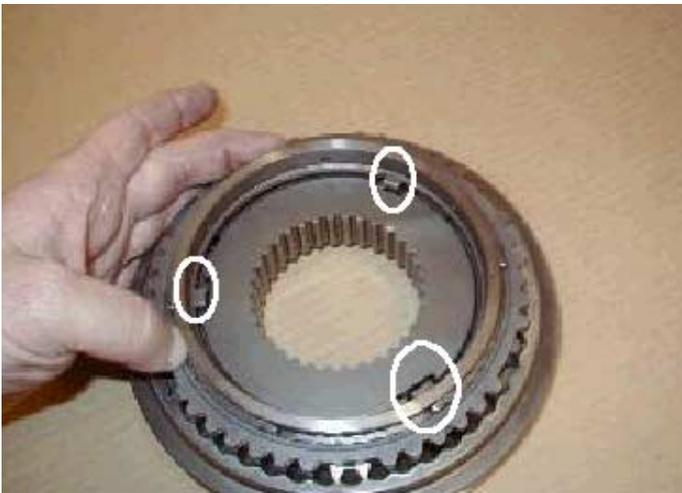
14. Colocar en posición el anillo interior del sincronizador asegurándose de que las tres lengüetas quedan alineadas con las patas de los bloques.
