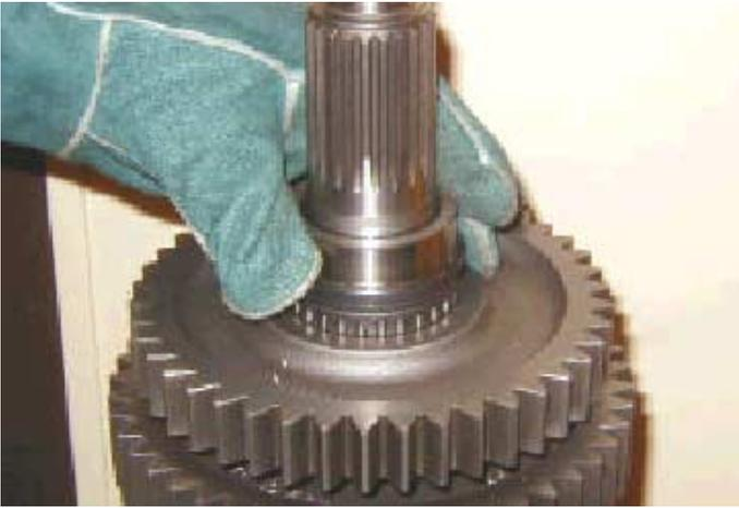
30. Montar el cojinete de rodillos en aguja de la marcha atrás. Lubricarlo y, con el saliente hacia abajo, montar el engranaje de marcha atrás en el eje pral.
