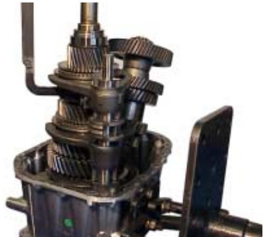
22. Monte la herramienta especial de elevación al Eje Principal bajo el sincronizador de las marchas 5a y 6a. Eleve el eje aproximadamente 20 mm. Esto permite que el Eje Secundario se eleve limpiamente.
