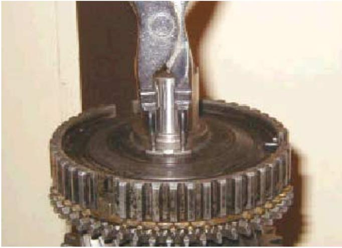
20. De entre la gama de circlips o resortes circulares de retención graduados que hay disponibles, seleccionar el que encaje en la ranura del eje pral. con menor huelgo. Meter el circlip en la ranura.
