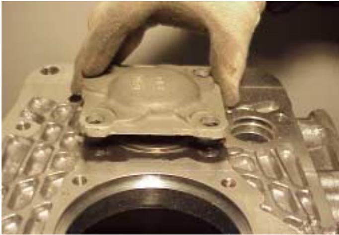
7. Aplicar loctite 5900 a la carcasa, instalar la cubierta de cojinete trasero del eje de posición en la caja. Apretar los tornillos de cabeza con el mismo par en el intervalo correcto (69 a 78 Nm) asegurando que el extremo del cojinete quede presionado contra la caja.
