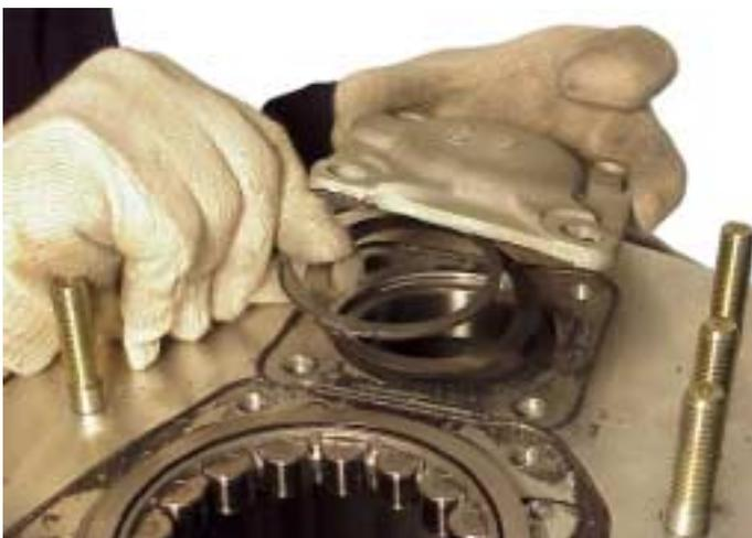
31. Extraer la placa de retención en el cojinete frontal del eje de posición y el espaciador graduado de la caja frontal.
