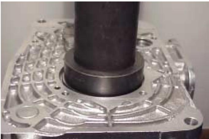
8. Instale en la caja el conjunto del rodillo y carril exterior del cojinete trasero del Eje Principal así como el anillo a presión con la muesca hacia fuera. Instale el alojamiento del velocímetro con dos o tres tornillos.
