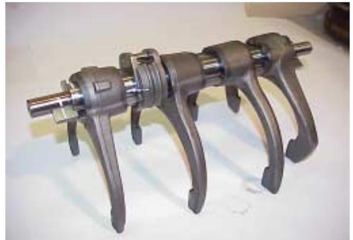
1. Coloque el conjunto selector en un banco con el bloque selector mirando hacia la izquierda. Marque cuál es la parte delantera del eje y chavetas para facilitar posteriormente el montaje.
