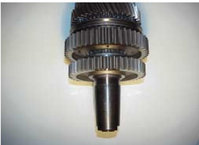
9. Encaje la camisa guía especial sobre el Eje Principal. No se necesita herramienta para cojinete de bolas con 4 contactos.
