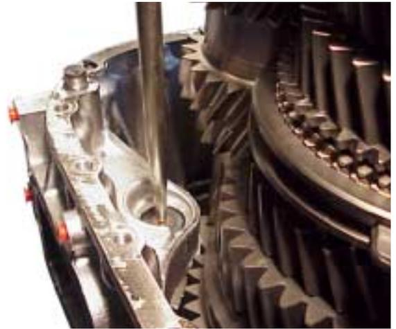
20. Extraiga el eje inversor de la marcha atrás utilizando un escariador/punzón adecuado y largo. Saque el tapón de expansión de la caja.
