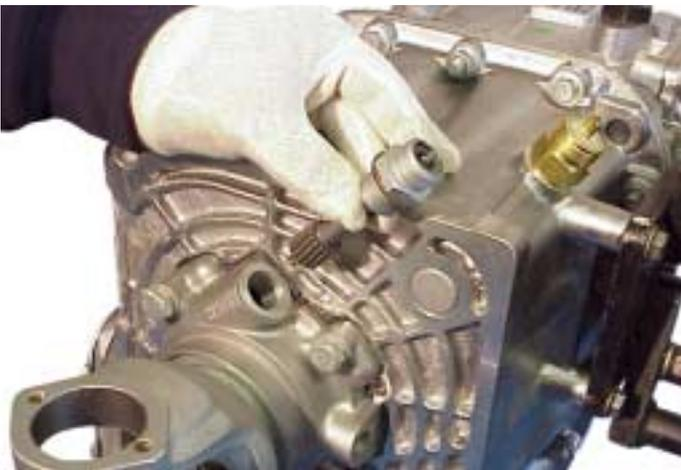
3. Quite el conjunto del alojamiento y el engranaje del piñón del velocímetro o la unidad del tacómetro electrónico. Quite la luz de marcha atrás.
