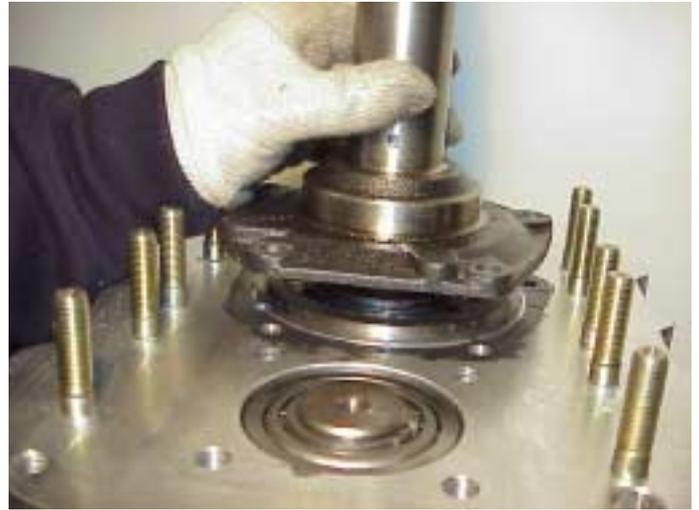
21. Lubrique la superficie del sello del eje y aplique sellabridas a la superficie de contacto de la cubierta delantera. Instale la cubierta delantera y ajuste los tornillos con un par de 35 a 39 Nm.
