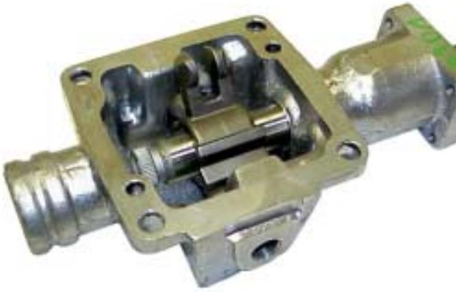
4. Instalar el eje del lado derecho de la carcasa.
