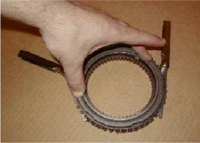
j) Sujetando las piezas firmemente unidas, medir la separación que media entre el anillo sincronizador y el collarín sincronizador, valiéndose para ello de una galga de espesores que se aplicará, como muestra el grabado, en varios puntos de la circunferencia. La aludida separación debería ser de entre 0,5 y 1,9 mm. De no arrojar la galga una medición que caiga dentro de estas tolerancias, habrá que cambiar el conjunto sincronizador.
