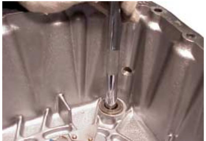
33. Si lo considera necesario, para recambiar los casquillos del Eje Selector, empuje los tapones obstructores del orificio del Eje Selector hacia afuera de las cajas.
