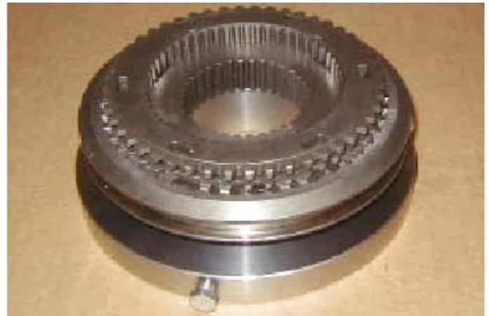
2. Colocar el conjunto sincronizador de 1ª/2ª en la herramienta de sujeción, cerciorándose de que la acanaladura del manguito sincronizador queda en la parte superior.
