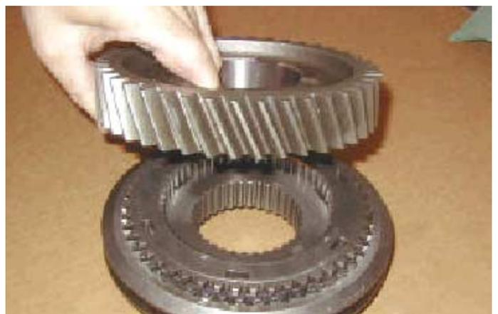
10. Sacar con cuidado la herramienta de sujeción, depositando acto seguido el conjunto sincronizador y el engranaje de la 2ª sobre una superficie de trabajo adecuada. Sacar el engranaje de la 2ª.
