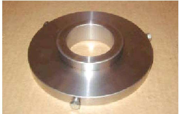
1. Con el saliente hacia arriba, depositar la herramienta de sujeción sobre una superficie adecuada.
