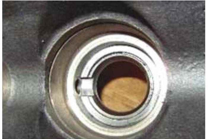
1. Limpiar todas las caras de uniones. Fijar el soporte asegurando que la ranura queda en línea con el agujero en la carcasa del pin.
