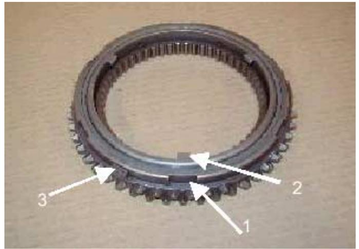
4. Montar el anillo sincronizador, asegurándose de que las muescas (1) quedan alineadas con las lengüetas (2) del anillo interior del sincronizador, y que, como muestra el grabado, los salientes (3) del anillo sincronizador quedan a la izquierda de las lengüetas (2) del anillo interior del sincronizador.
