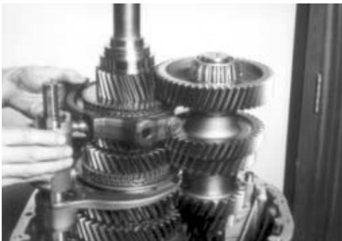
14. Instale los suplementos de la horquilla en la horquilla selectora de superdirecta 5a/6a en las cajas de cambio que tengan superdirecta. Acople los suplementos y horquilla en la camisa del sincronizador.
