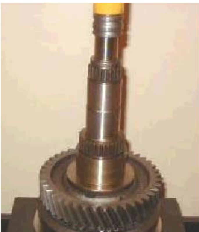
5. Con el extremo liso en la parte superior, montar el eje principal en el engranaje de la 2ª y conjunto sincronizador, asegurándose de que las estrías del eje pral. engranan debidamente en las del conjunto sincronizador. Meter a fondo el eje pral. en el conjunto sincronizador.
