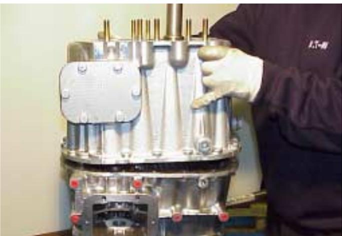
15. Aplicar sellante loctite 5900 a la brida de unión en la caja trasera e instalar la caja frontal. Colocar los tornillos de cabeza y las tuercas.
