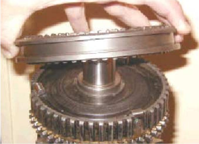
1. Con el extremo liso arriba, sujetar el conjunto del eje pral. en un tornillo de banco de mordezas blandas o protegidas. Ejerciendo ahora sumo cuidado, deslizar hacia arriba el manguito sincronizador de 5ª/6ª hasta quedar los tres rodillos separados de la estría o ranura del manguito sincronizador. Por último sacar del cubo sincronizador: Los tres rodillos, el manguito sincronizador, y los tres vástagos y tres muelles del cubo sincronizador.
