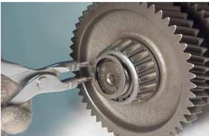
1. Sujete el conjunto del eje y quite el anillo elástico graduado que retiene el rodamiento cónico delantero.
