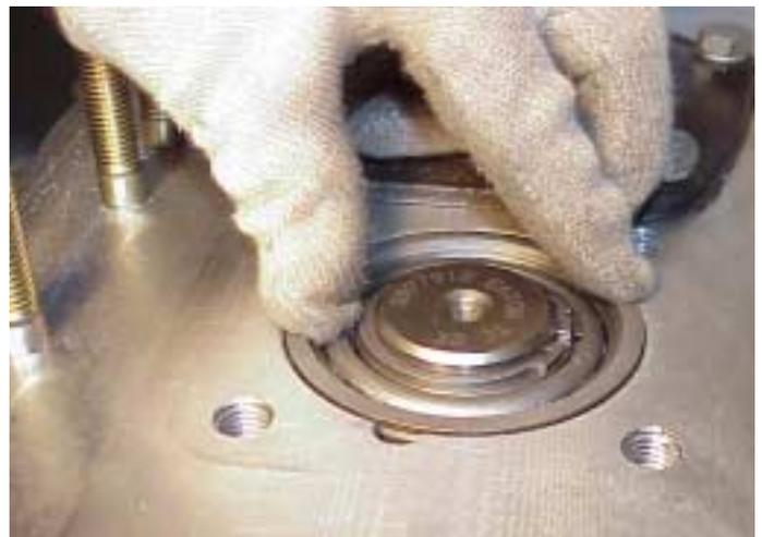
22. Buscar una cuña y colocarla contra el extremo del cojinete del eje de posición. Colocar el espaciador por encima de la cuña.
