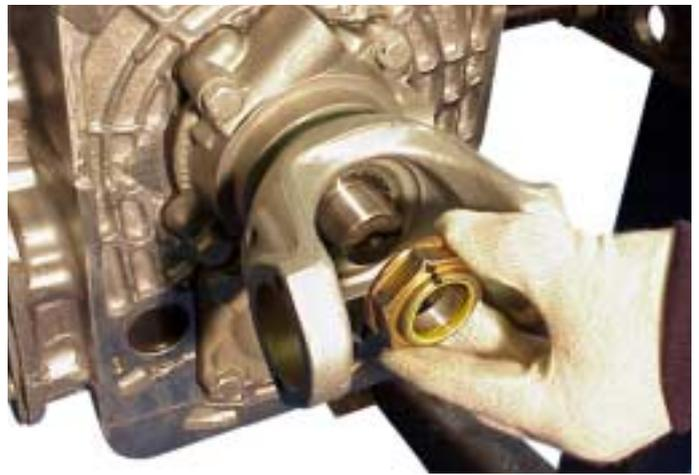
5. Use una llave soporta-brida para quitar la tuerca retén de la brida del accionamiento de salida.
