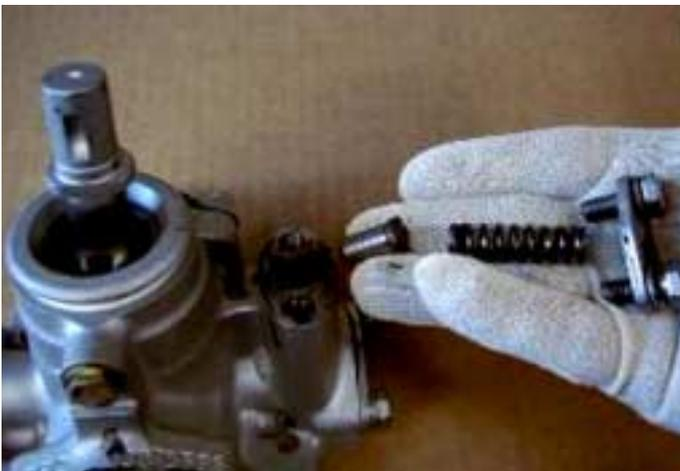
2. Sacar los tornillos, arandelas, la lámina cubierta de retención, el muelle y el émbolo.
