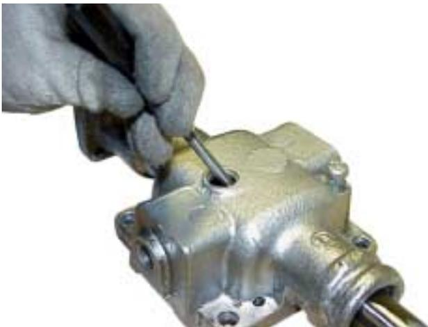
9. Desplazar el pin hacia fuera. Extraer el eje y la palanca interior.
