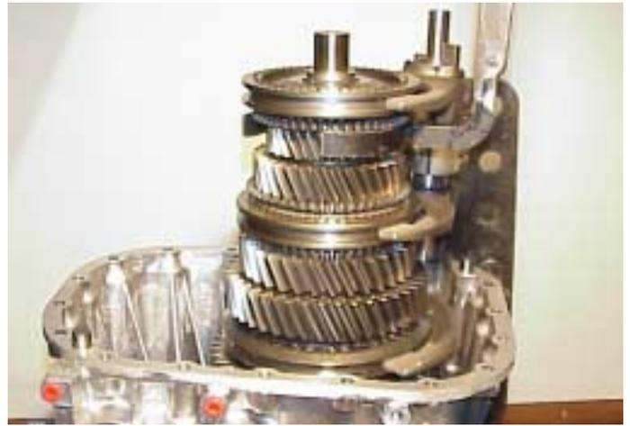
10. Localice al conjunto del Eje Selector. Sujete el Eje Principal utilizando la herramienta especial, perne y baje el conjunto en la caja asegurándose de que el Eje Selector penetra en el casquillo trasero. Sujete el Eje Principal y los selectores aproximadamente a 20 mm sobre la posición de instalación permanente.
