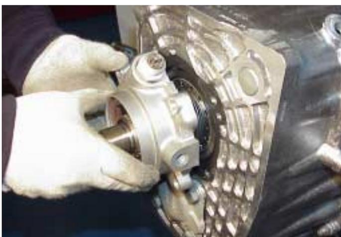
30. Selle la brida e instale el alojamiento del velocímetro. Tenga en cuenta la posición del tornillo más largo. Ajuste los tornillos al par adecuado (de 35 a 39 Nm).
