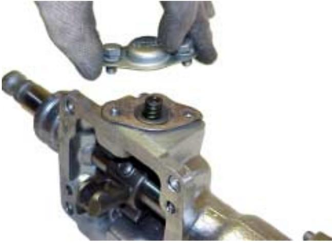
10. Instale el vástago y el muelle de la retenida inversora y coloque la cubierta utilizando una junta nueva. Ajuste los tornillos según el par de apriete apropiado (de 20 a 24 Nm).
