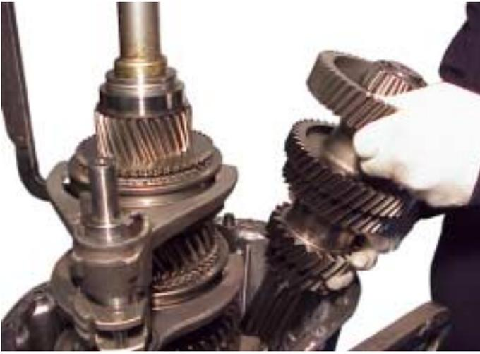
23. Levantamiento del eje de posición
