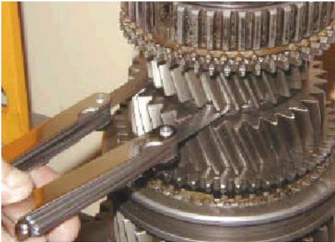
21. Valiéndose de una galga de espesores, comprobar que el huelgo axial del engranaje de la 5ª cae dentro de las tolerancias prescritas en el gráfico.
