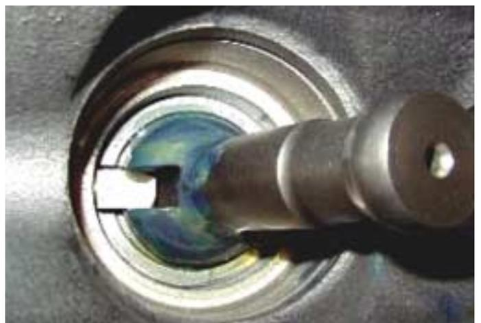
3. Aplicar una capa de grasa al eje selector y, asegurando que la ranura en el eje selector queda en línea con el pin en la carcasa, fijar el eje selector.
