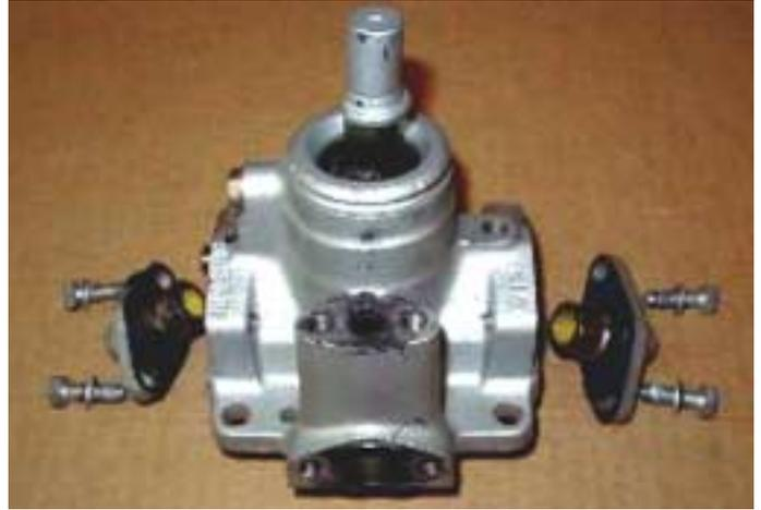
4. Sacar los tornillos, arandelas y cubiertas de extremos de ambos lados de la carcasa.
