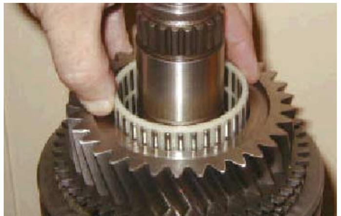
13. Montar el conjunto de la 4ª. Lubricar el cojinete de rodillos en aguja e instalarlo en el engranaje.
