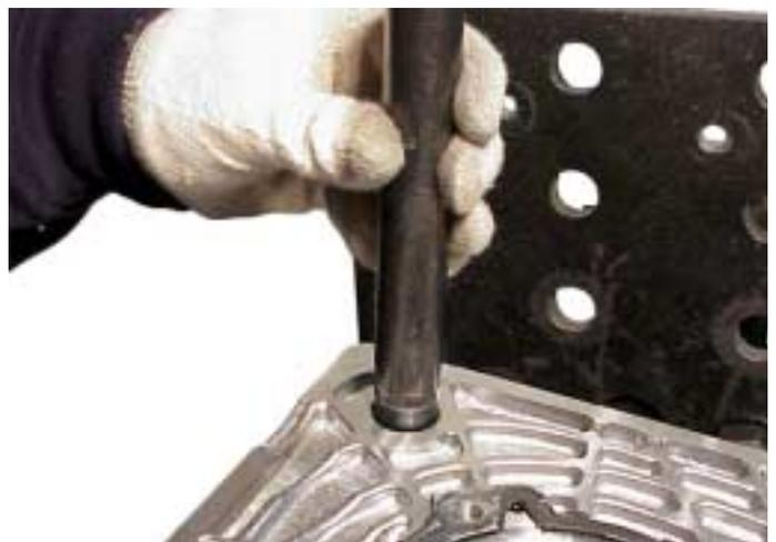
34. Déle la vuelta a las cajas y, utilizando la herramienta especial o un mandril adecuado (25 mm de diámetro), saque los casquillos del Eje Selector de las cajas.
