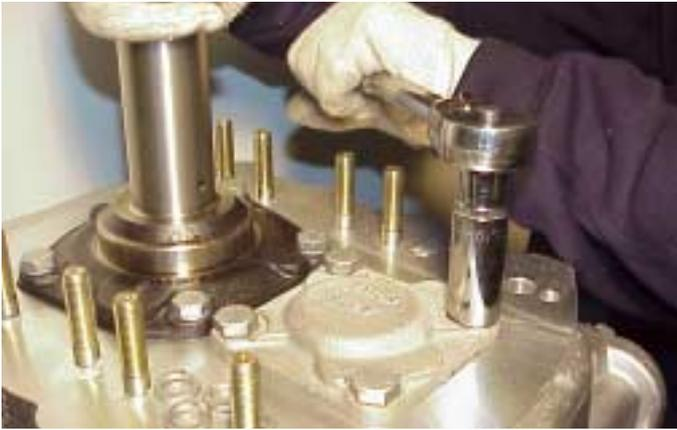
23. Instalar la cubierta del cojinete frontal del eje de posición (sin sellante). Fijar los tornillos de cabeza sin arandelas de muelle. Apretar con cuidado los tornillos de cabeza sin llegar a tope rotando al hacerlo el eje de entrada hacia atrás y delante para fijar los cojinetes. Seguir apretando los tornillos de cabeza hasta que se perciba cierta resistencia en el eje de entrada.
