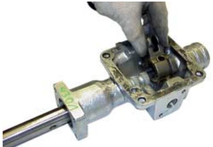
3. Instalar la palanca interior, ranura larga plana cerca del frontal de la carcasa.
