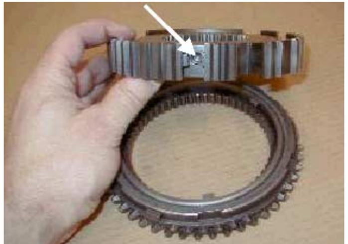
5. Con los orificios del cubo sincronizador en la parte superior.
