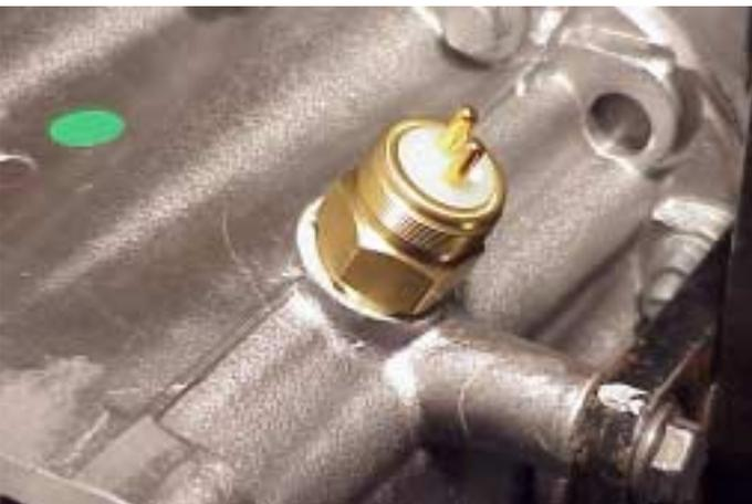
46. Selle e instale el interruptor de la luz de marcha atrás. Ajuste a un par de 16 a 22 Nm.
