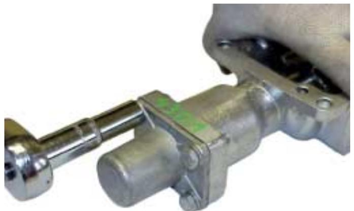
9. Meta una junta nueva y asegure la cubierta final al alojamiento. Ajuste según el par de apriete apropiado (de 20 a 24 Nm). Nota: se ha grabado la palabra Top en la cubierta para identificar el posicionamiento correcto
