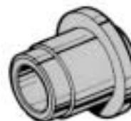
E 109-5 Instalador del casquillo y retén del control del selector.
