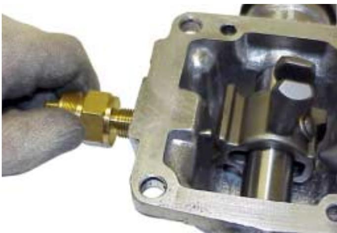
12. Coloque el respirador. Instale el pasador y el interruptor de punto muerto (de 15 a 22 Nm). Selle e instale un nuevo tapón obstructor.
