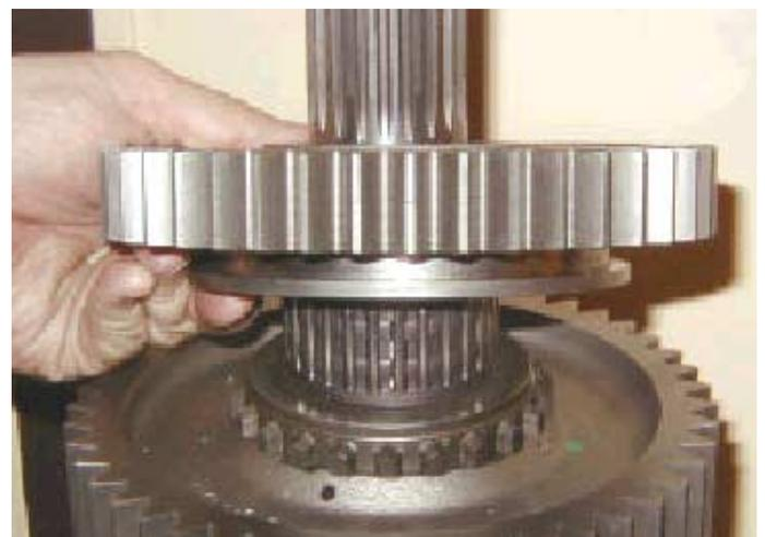
29. Montar el cojinete de rodillos en aguja de la marcha atrás. Lubricarlo y, con el saliente hacia abajo, montar el engranaje de marcha atrás en el eje pral.
