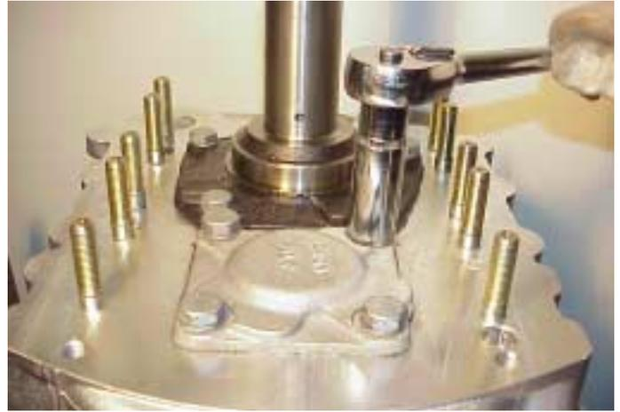
25. Lubrique el cojinete del Eje Secundario e instale el separador graduado con el grosor elegido. Aplique sellabridas e instale la cubierta. Selle y ajuste los tornillos al par correcto (de 69 a 78 Nm).
