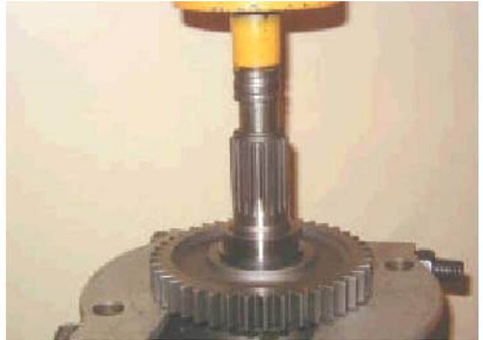
3. Invertir el conjunto del eje pral. Valiéndose de una prensa o extractor apropiado, sacar la caja interior del cojinete del eje pral., el piñón de marcha atrás y el cojinete de rodillos en aguja.
