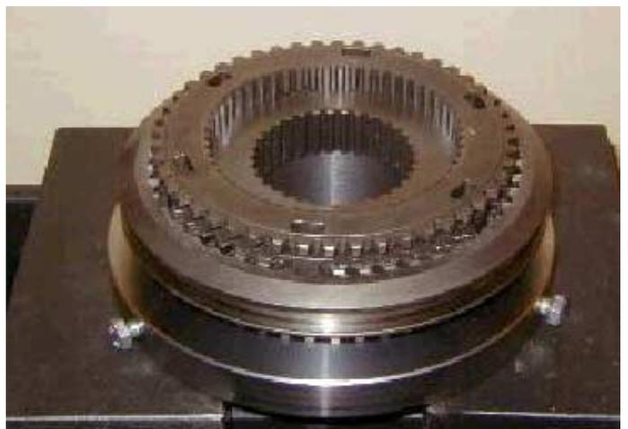
3. Caldear el conjunto a 85° Centígrados, colocando acto seguido la herramienta de sujeción y el conjunto sincronizador sobre la mesa de la prensa.
