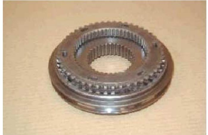
1. Colocar el conjunto sincronizador sobre una superficie plana, con la espiga del manguito sincronizador en la parte superior.
