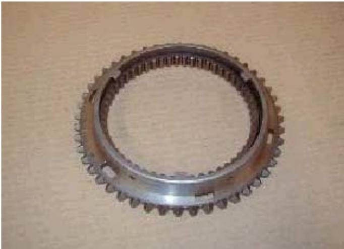
2. Montar el anillo interior del sincronizador en el collarín sincronizador (lengüetas en la parte superior).
