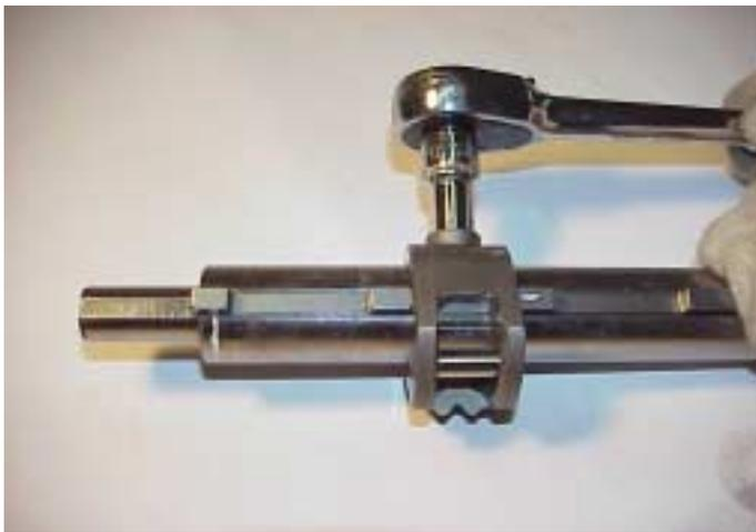
2. Ponga el bloque selector en el eje y ajuste el tornillo de 35 a 39 Nm.
