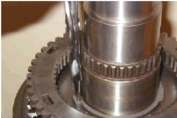
7. Sacar el circlip o resorte circular de retención del conjunto sincronizador.
