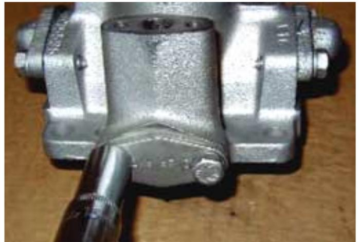
8. Fijar de nuevo el émbolo, muelle(s), cubierta final (aplicar Loctite 5900 a las caras de unión), tornillos y arandelas. Torque screws to 20 to 24Nm.
