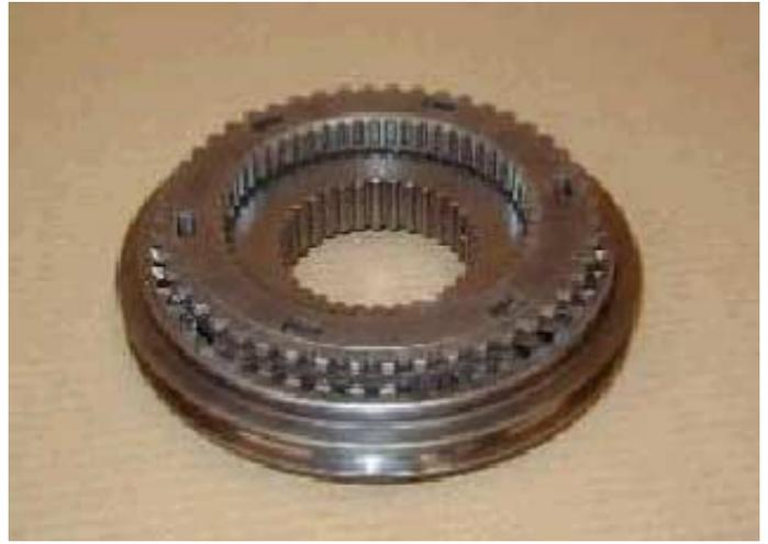
16. Sujetar hacia abajo el conjunto sincronizador y contra el banco, alzando al mismo tiempo el manguito sincronizador para engranar la posición punto muerto.
