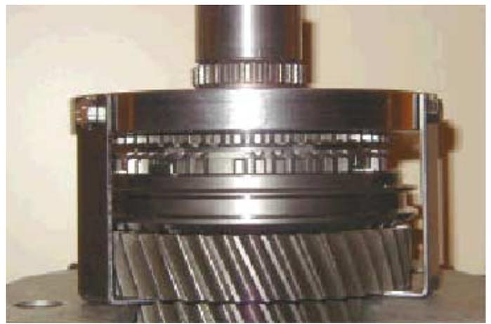
9. Valiéndose de una prensa o herramienta apropiada, sacar el conjunto sincronizador y el engranaje de la 2ª. Sacar el cojinete de rodillos en aguja.
