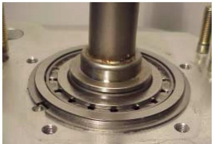
18. Coloque el anillo separador y el anillo elástico interior al Eje Primario. Fijar la arandela a presión del cojinete.
