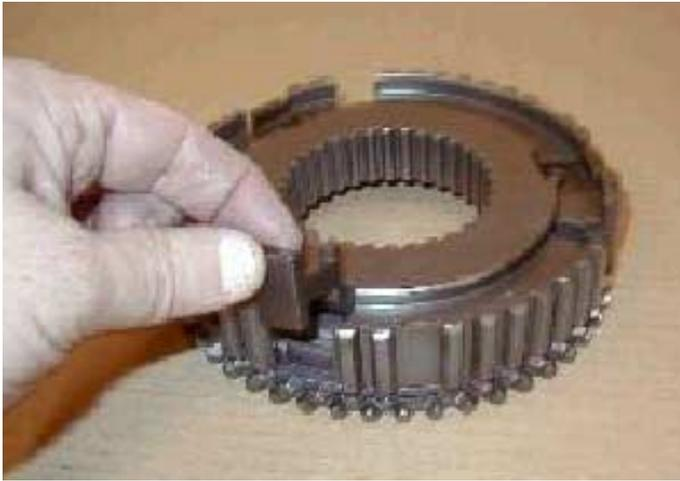
7. Colocar los tres elementos de retención en las concavidades del cubo sincronizador, de forma que las patas de los bloques casen con las lengüetas del anillo interior del sincronizador y las muescas del anillo sincronizador.
