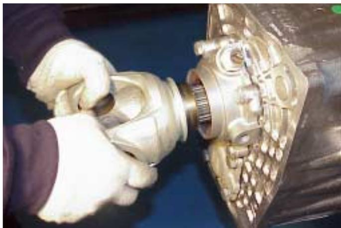
31. Engrase ligeramente con aceite los labios del sello e instale la brida de accionamiento. No pegue con martillo a la brida para que vaya al Eje Principal ya que puede descolocar el separador del cojinete, lo que podría dañar al separador, al cojinete o al eje y/o afectar la holgura final del Eje Principal seriamente.
