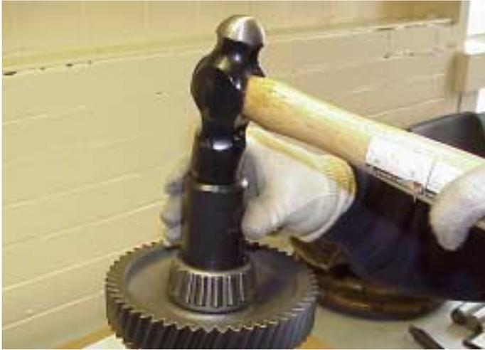
1. Caliente los anillos internos del rodamiento cónico hasta 85°C. Apoye el extremo final delantero del conjunto del eje y coloque el cono interior ya caliente y el conjunto del rodamiento en el eje. Utilice un andrill adecuado para asegurarse de que el rodamiento se encuentra bien posicionado.
