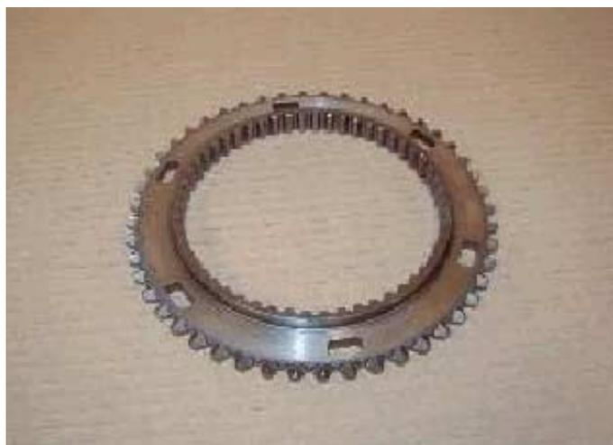
c) Colocar el collarín sincronizador en el banco, con la espiga en la parte superior.
