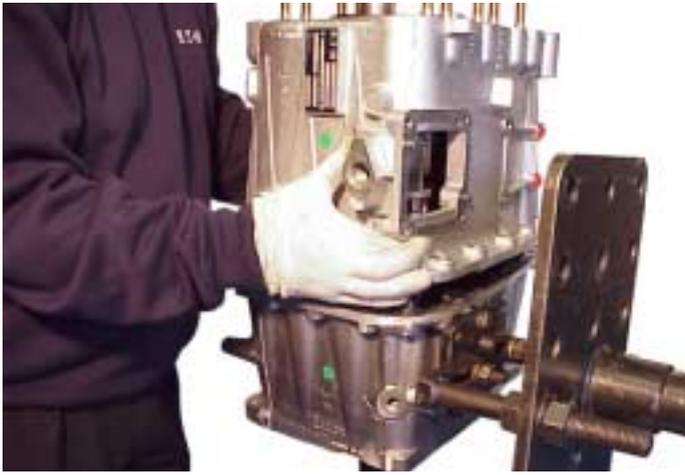
18. Rompa el sellaje con un mazo blando y separe la caja delantera de la trasera. NO UTILICE BARRAS DE INSPECCIÓN NI CINCELES. Levante la caja delantera dejando al Eje Primario y al cojinete en su sitio.
