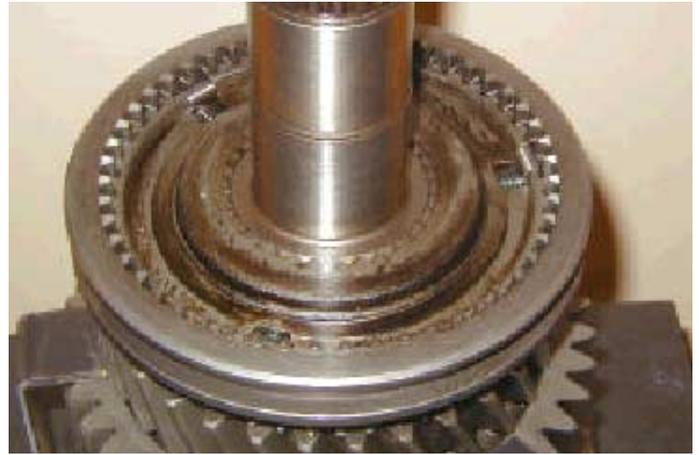
11. Ensamblar los tres muelles y brazos en el cubo sincronizador. Colocar el manguito sincronizador sobre el cubo sincronizador, apoyándolo con la ranura interna justo encima del cubo. Posicionar los tres rodillos como indica el grabado, o sea descansando en la cabeza de los brazos, y oprimiendo hacia abajo sobre el manguito sincronizador. Ello comprime los muelles, permitiendo al manguito sincronizador centralizarse en la posición punto muerto.
