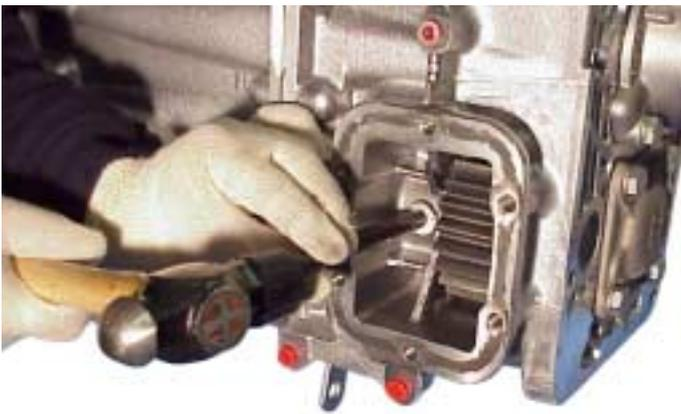
9. Quite la cubierta trasera de la TF. Utilice la herramienta especial o un punzón de 8 mm para meter hacia adentro el pasador amuescado del Eje de Marchas atrás hasta que el final esté a unos 12 mm aproximadamente bajo la cara del agujero. No deje que el pasador "toque fondo" contra el orificio del eje.
