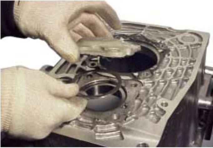
29. IDéle la vuelta a la caja sobre el pie y quite la cubierta del cojinete trasero del Eje Secundario y el separador del cojinete.
