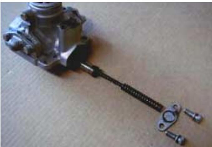
3. Sacar los tornillos, arandelas, la lámina cubierta de retención, muelle(s) y el émbolo.
