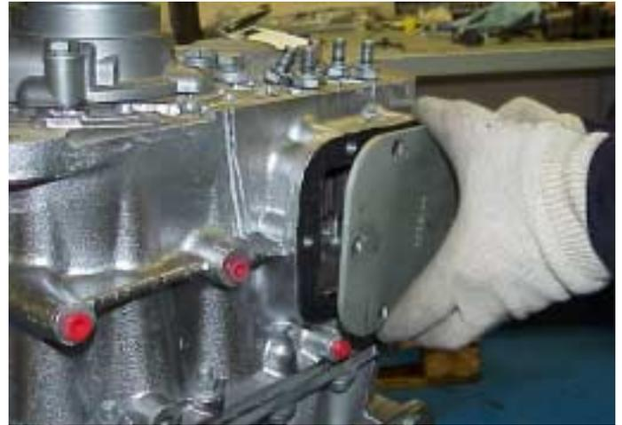
41. Utilice una nueva junta para instalar la cubierta del engranaje inversor MA/TF. Ajuste los tornillos con un par de apriete de 35 a 39 Nm.
