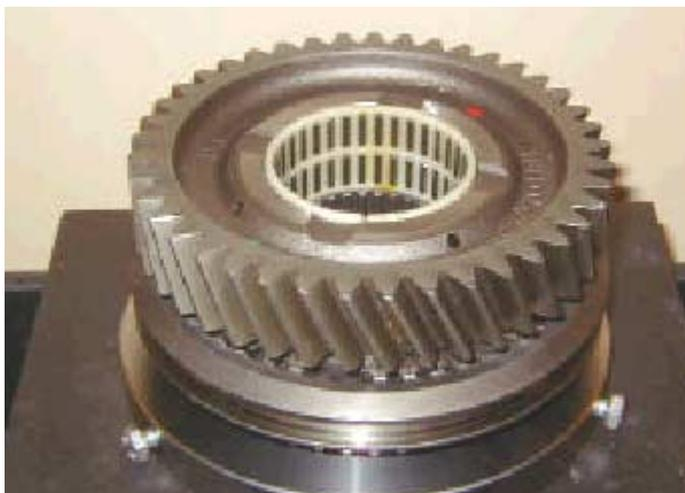
4. Montar el engranaje de la 2ª en el conjunto sincronizador, cerciorándose de que sus estrías engranan debidamente en las del conjunto sincronizador. Montar y lubricar el cojinete de rodillos en aguja.
