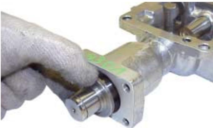
6. Coloque el anillo elástico interno en el eje. Instale el retenemuelles pequeño.
