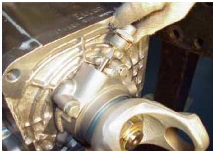
33. Si no ha sido todavía instalada, instalar la unidad emisora o piñón guía y su carcasa usando una nueva arandela de estanqueidad. Apretar al par correcto (20 a 27 Nm).
