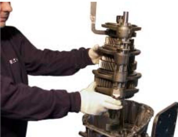
25. Suba el perno elevador y saque el Eje Principal y el selector y horquillas como conjunto entero. Déjelo sobre un banco limpio y extraiga la herramienta especial. Separe el eje selector y las horquillas del Eje Principal.
