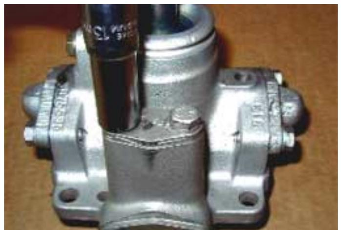
9. Fijar de nuevo el émbolo, muelle, cubierta de retención (aplicar una capa de Loctite 5900), tornillos y arandelas. Pares de apriete de 20 a 24 Nm.
