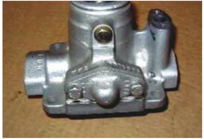
7. Aplicar una ligera capa de grasa a los casquillos en las cubiertas de los extremos. Aplicar Loctite 5900 a las caras de unión. Fijar los tapones de los extremos, tornillos y arandelas. Pares de apriete de 20 a 24 Nm.
