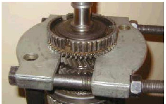
11. Invertir el eje pral. Como quiera que el cubo sincronizador de 5ª/6ª es asimétrico, identificar su orientación. Valiéndose de una prensa o extractor apropiado, sacar el cubo sincronizador de 5ª/6ª, el anillo sincronizador y el conjunto del engranaje de la 5ª. Nota: tener cuidado de asegurarse de que no resultan dañados los dientes del collarín del sincronizador.
