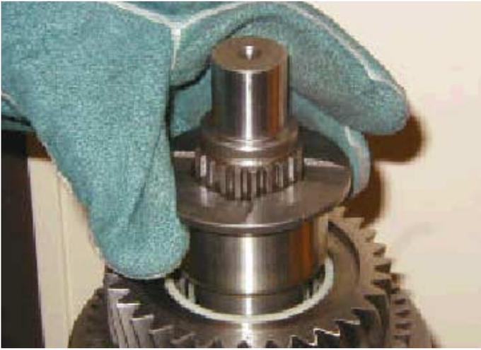
14. Caldear el casquillo de cojinete de la 4ª a 85° Centígrados, colocándolo sobre el eje pral. y dentro del cojinete de rodillos en aguja. Oprimir el casquillo de cojinete, metiéndolo en posición.
