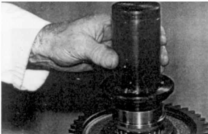
18. Tome el carril interno recalentado del cojinete trasero del Eje Principal y colóquelo sobre el eje, la parte más interna de la brida contra el separador. Utilice un mazo blando o instalador apestañado adecuado en caso de necesidad para asegurarse de que el cubo está totalmente en posición contra el hombro.
