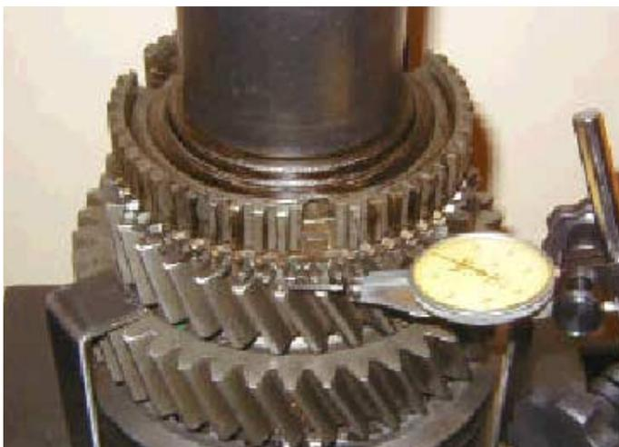
10. Comprobar que el huelgo axial de la 3ª cae dentro de la tolerancia que indica el gráfico.
