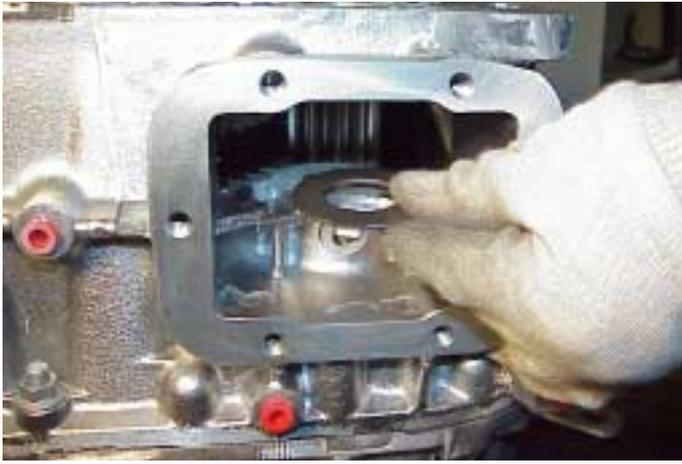
34. Aplique una película de gelatina de petróleo a las arandelas de empuje del engranaje inversor MA y posiciónelas en la Caja de Cambios.
