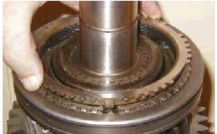
12. Colocar el anillo sincronizador de 4ª en el conjunto sincronizador, asegurándose de que los hombros del anillo sincronizador encajan debidamente en las ranuras del cubo sincronizador. Lubricar el anillo sincronizador.
