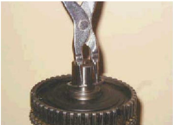
2. Quitar del cubo sincronizador de 5ª/6ª el circlip o resorte circular de retención.
