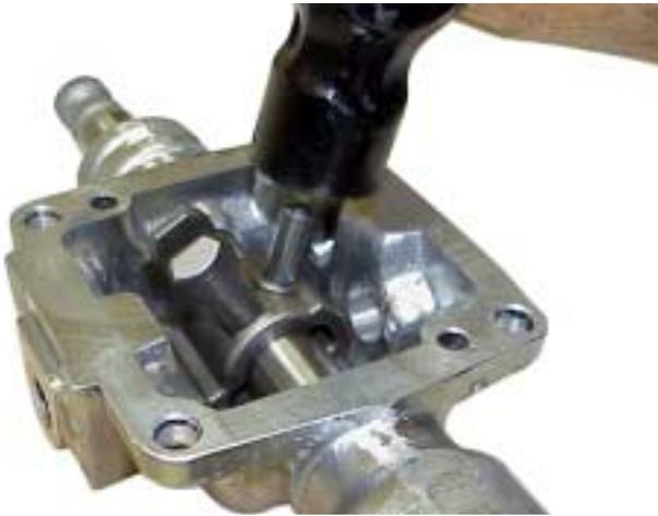
5. Alinear la manivela interior sobre el eje e instalar un nuevo perno surcado. Nota: la manivela interior debería estar apoyada mientras se mueve el perno para evitar que se dañen los casquillos.
