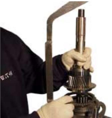
24. Levantamiento del eje de entrada con la brida de la 6ª marcha. Extraer el anillo sincronizador de la 6ª marcha.
