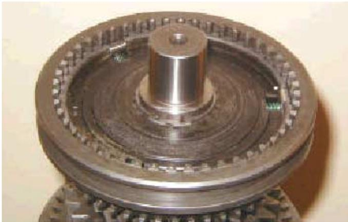
31. Invertir el eje pral. Ensamblar los tres muelles y brazos en el cubo sincronizador, instalando luego el manguito sincronizador y los rodillos tal como describimos en el párrafo once.
