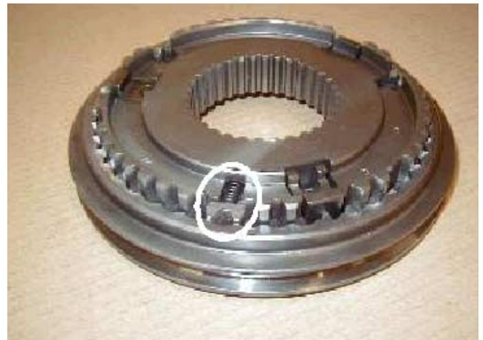
11. Con el muelle comprimido, oprimir hacia abajo la seta de detención en el interior del cubo sincronizador hasta encajar la bola en la ranura de ajuste del manguito. Montar los restantes muelles de detención, bolas y brazos.
