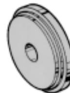
E 109-6 Adaptador del instalador de la copa del cojinete del eje secundario.
