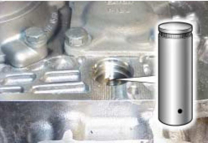
39. Asegurar que las arandelas a presión y el embrague están correctamente posicionados. Llevar el eje a su posición asegurando que el extremo del mismo quede justo por debajo de la superficie de la caja.
