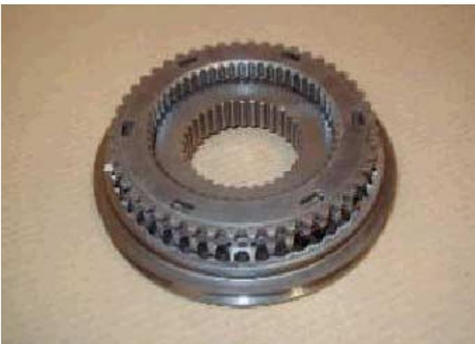
15. Colocar en posición el collarín sincronizador asegurándose de que las ranuras del collarín quedan alineadas con las lengüetas del anillo de rozamiento del sincronizador.
