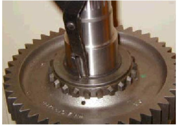
27. De entre la gama de circlips graduados disponibles, escoger el que encaje en la ranura del eje pral. con menor huelgo. Insertar el circlip en la ranura, cuidando de no dañar la superficie del cojinete de rodillos en aguja del eje pral.
