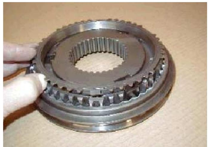
12. Colocar el anillo sincronizador en el cubo sincronizador de forma que los tres salientes encajen en las tres ranuritas del cubo sincronizador.
