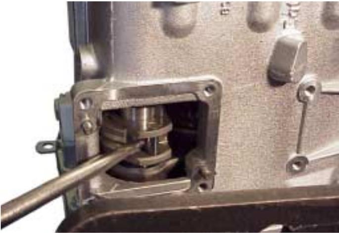
12. Haga girar el Eje Selector de marcha hacia la izquierda (si está montado verticalmente) o hacia la derecha (si está montado horizontalmente) para que la caja no encephe el bloque selector al quitarla.
