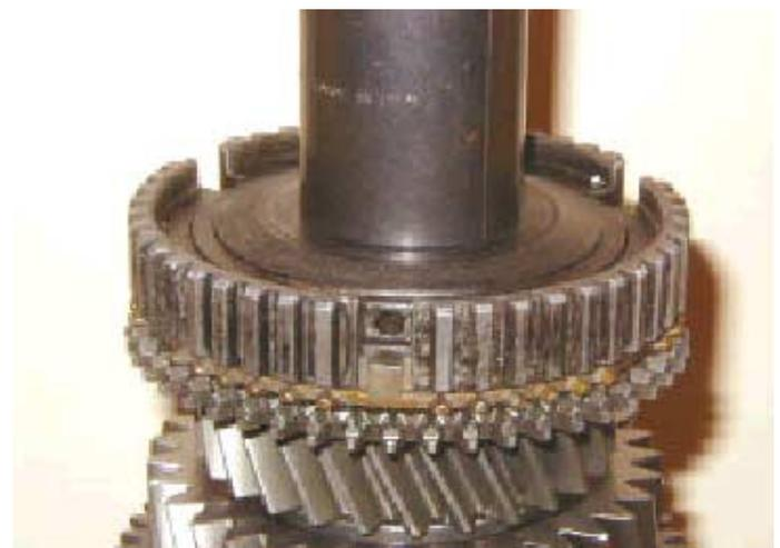
19. Caldear el cubo sincronizador de 5ª/6ª a 85° Centígrados e insertarlo a continuación en el eje pral., con el saliente hacia abajo. Cerciorarse de que las ranuras grandes del cubo quedan alineadas con los hombros grandes del anillo sincronizador. Oprimir a tope el cubo sincronizador hasta comprobar que quedó totalmente a fondo en su asiento.
