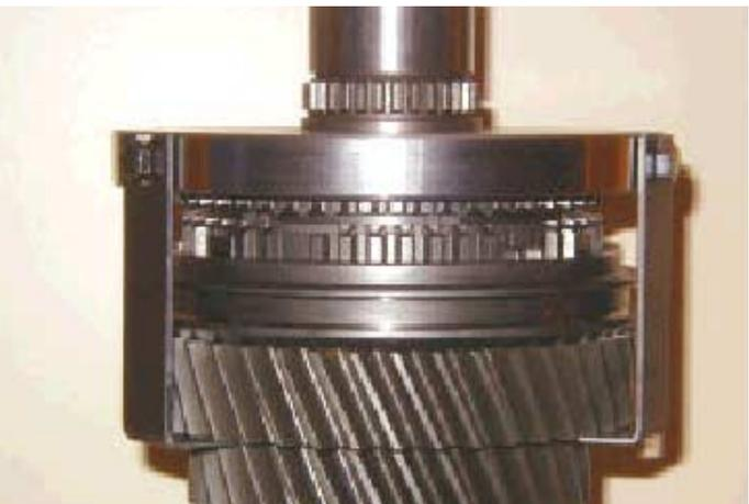
8. Con objeto de impedir que el conjunto sincronizador se desprenda durante la quita, instalar la herramienta de sujeción, que es un útil que encaja en el eje pral., con el saliente hacia abajo; los tres elementos de sujeción aparecen situados debajo del engranaje de la 2ª y el conjunto sincronizador.
