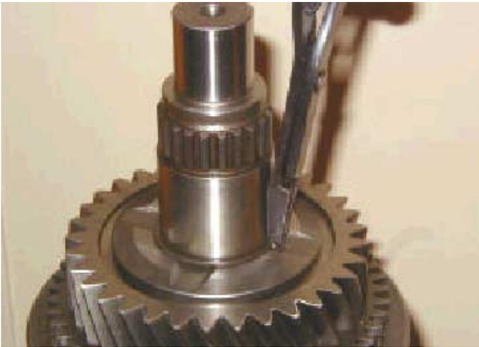
15. Meter una arandela de retención nueva en el eje pral., cuidado de no dañar la superficie de apoyo del eje pral.
