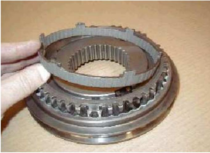
13. Lubricar todas las superficies del anillo de rozamiento del sincronizador. Con las lengüetas en la parte superior, poner el anillo de rozamiento en el cubo sincronizador.
