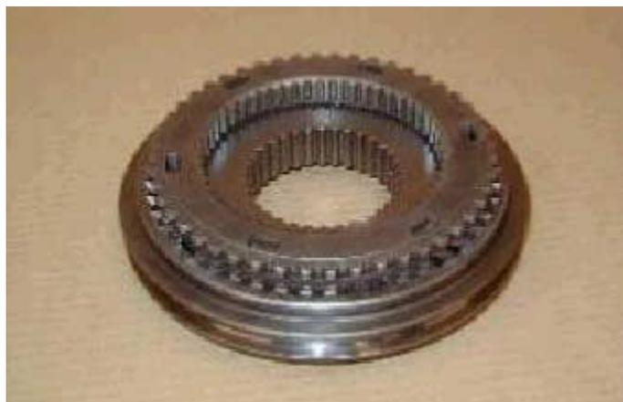
a) Colocar el conjunto sincronizador sobre una superficie plana (cara arriba o cara abajo).
