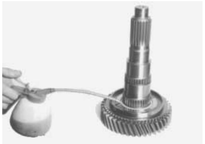
3. Lubrique el cojinete con aceite limpio y coloque la 2a marcha sobre el cojinete.
