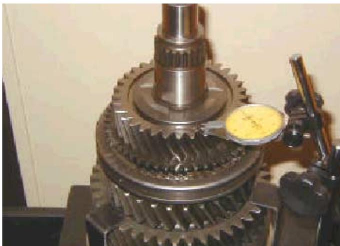
16. Comprobar que el huelgo axial de la 4ª caiga dentro de la tolerancia que indica el gráfico.
