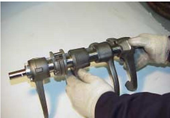
3. Coloque las horquillas en sus posiciones respectivas en el Eje Selector.
