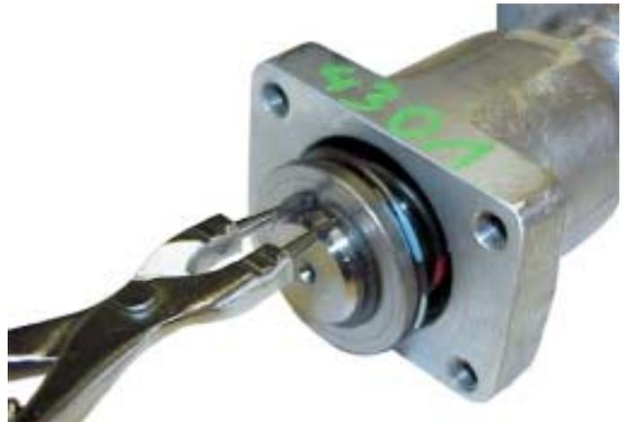
8. Meta el anillo elástico externo en el eje.
