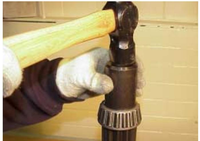
4. Déle la vuelta al conjunto del Eje Secundario y coloque el anillo interior trasero del rodamiento cónico previamente calentado en el eje. Utilice un mandril adecuado para asegurarse de que el rodamiento se encuentra bien posicionado.
