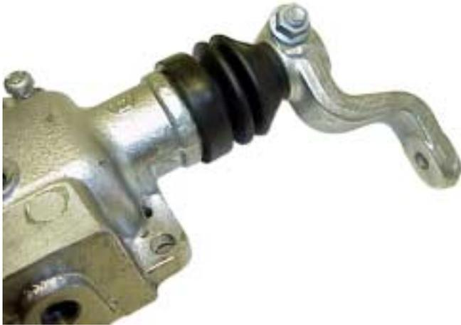
11. Coloque el manillar de caucho en el alojamiento. Alinee la palanca exterior con la marca que hay en el eje. Ajuste con el perno de 35 a 39 Nm.
