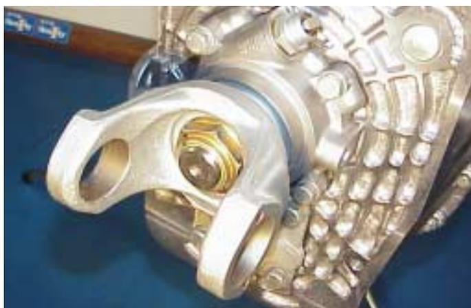
32. Con una llave soporta-bridas, coloque y ajuste la tuerca de cierre retén de la brida con un par de 490 a 588 Nm.
