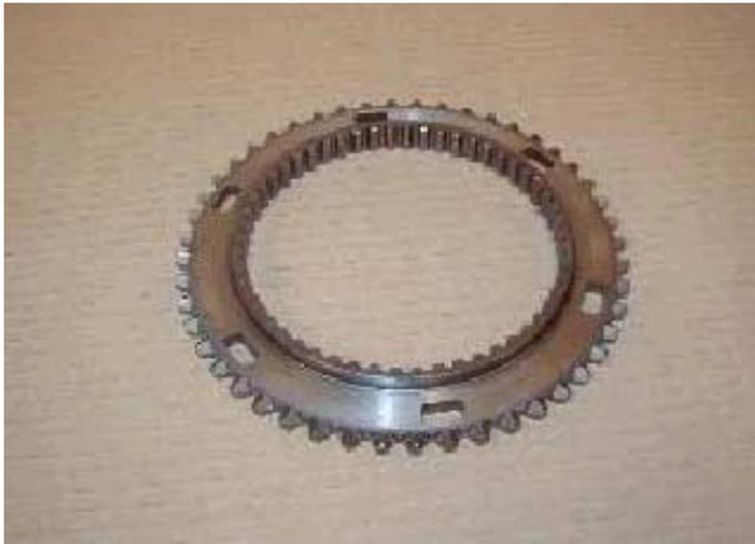
1. Con la espiga en la parte superior, depositar en el banco el collarín sincronizador.
