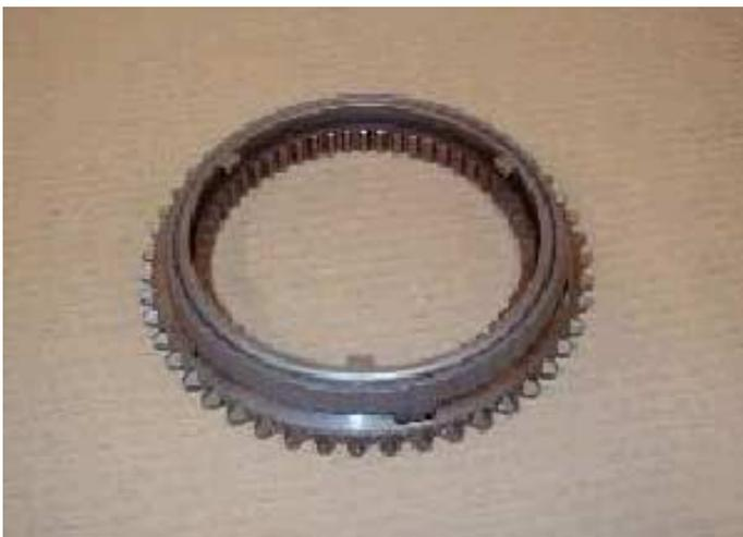
3. Lubricar todas las superficies del anillo de rozamiento del sincronizador. Montarlo cerciorándose de que sus lengüetas encajan en las ranuras o estrías del collarín.
