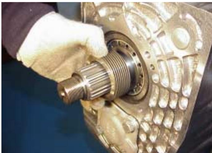
28. Instale el engranaje o rotor accionador del velocímetro en el Eje Principal contra el separador.
