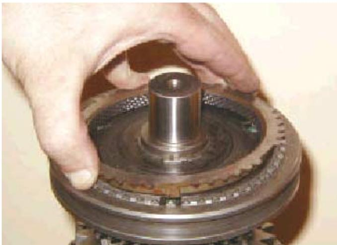
32. Montar el anillo sincronizador cerciorándose de que sus tres salientes encajan coincidentes en las tres ranuras del cubo sincronizador. Lubricar el anillo sincronizador.
