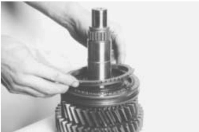
24. Coloque el anillo sincronizador de la 4a marcha en el conjunto del cubo sincronizador.
