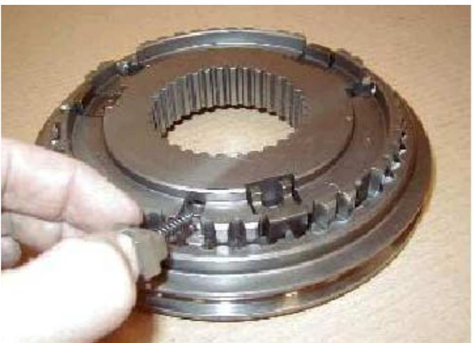
9. Insertar las setas de detención y muelles en los orificios del cubo sincronizador.
