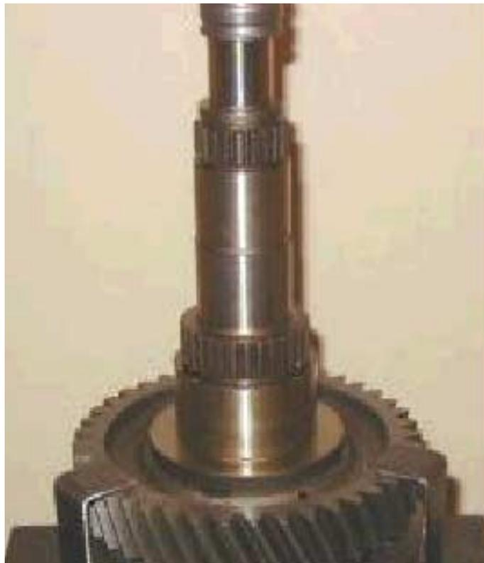
6. Con objeto de impedir que el conjunto sincronizador se desprenda habrá que valerse de los elementos de sujeción, ajustándolos de forma que no haya huelgo o juego libre entre el engranaje de la 2ª y el conjunto sincronizador.
