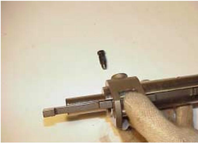
4. Saque el tornillo del bloque selector y deslice el bloque del eje.
