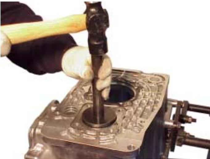
30. Saque el vaso externo del cojinete trasero del Eje Secundario utilizando la herramienta especial.
