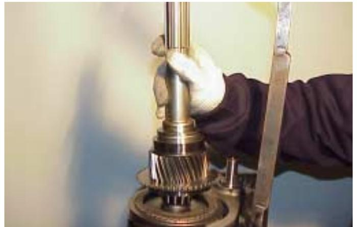
11. Lubrique e instale la espiga en el Eje Principal. Instale el anillo sincronizador e instale el conjunto del Eje Primario.
