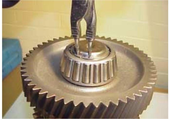
3. Ensamble el anillo utilizando punzones para anillos.
