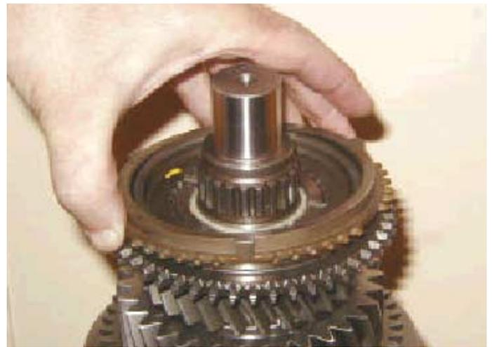
18. Lubricar el collarín de sincronización de la 5ª. Montar el anillo sincronizador.
