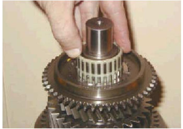
17. Montar el conjunto de la 5ª. Lubricar el cojinete de rodillos en aguja e instalarlo en el engranaje.
