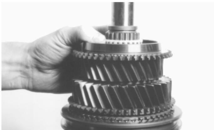
29. Lubrique el cojinete de la 5a marcha e instale el cojinete y el conjunto de la 5a marcha en el eje.
