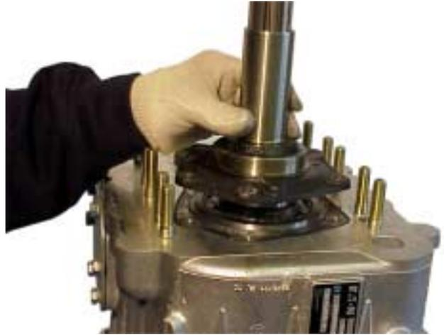
15. Quite los tornillos grandes asegurando la cubierta del Eje Primario y quite la cubierta.
