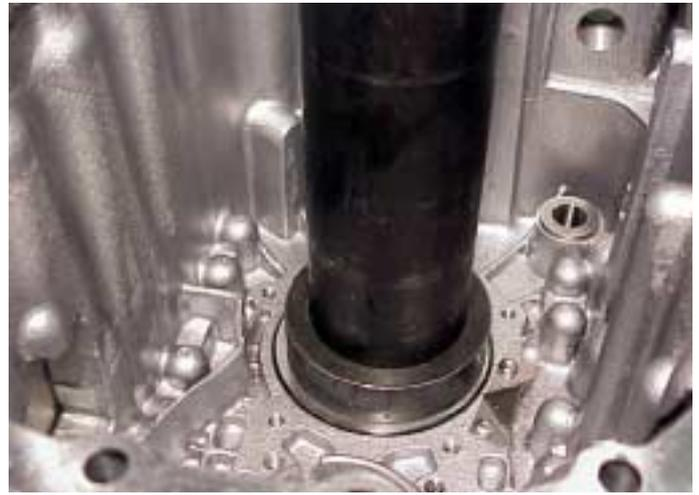
32. Desplazar hacia fuera el extremo del cojinete del eje de posición usando la herramienta especial. Extraer el cojinete del eje de entrada usando la herramienta especial.
