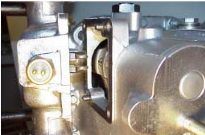
44. Aplique sellabridas e instale el control remoto asegurándose de que la palanca interior cae sobre el bloque selector.
