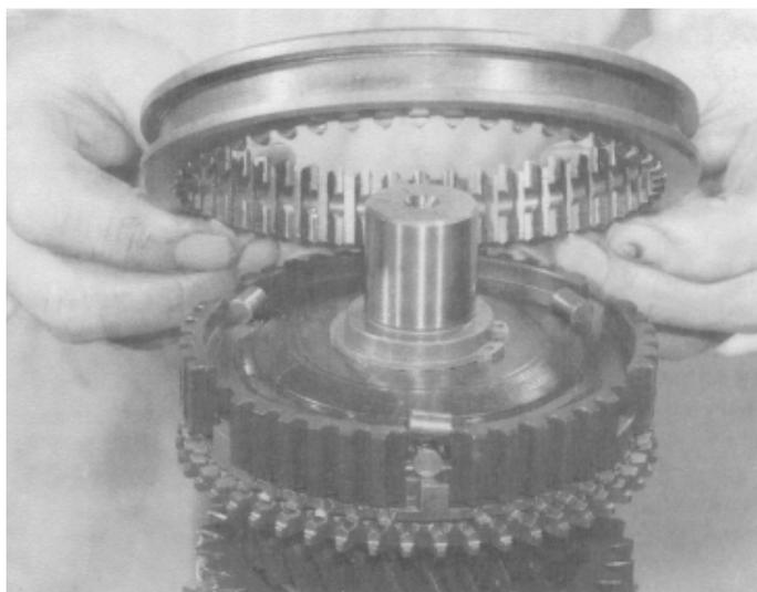
1. Monte el conjunto del eje en un torno de garras suaves. Deslice suavemente hacia afuera la camisa del sincronizador de la 5a/6a marcha hasta que los tres rodillos no se encuentren en contacto con la muesca de la camisa. Quite los rodillos, la camisa y los tres vástagos y muelles del cubo fijo de sincronización.
