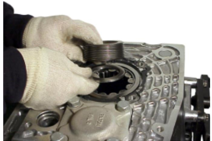
27. Extraer el embrague guía del velocímetro o rotor del tacógrafo y el espaciador del cojinete de apoyo de la mitad posterior de la caja.
