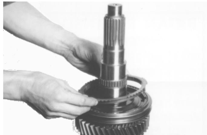
10. Coloque el anillo sincronizador de la 1a marcha en el conjunto del cubo sincronizador.
