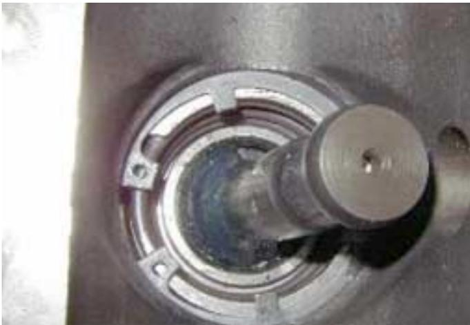
5. Asegurando que el diámetro menor del muelle reposa sobre el soporte fijar de nuevo el muelle y el clip circular de retención.
