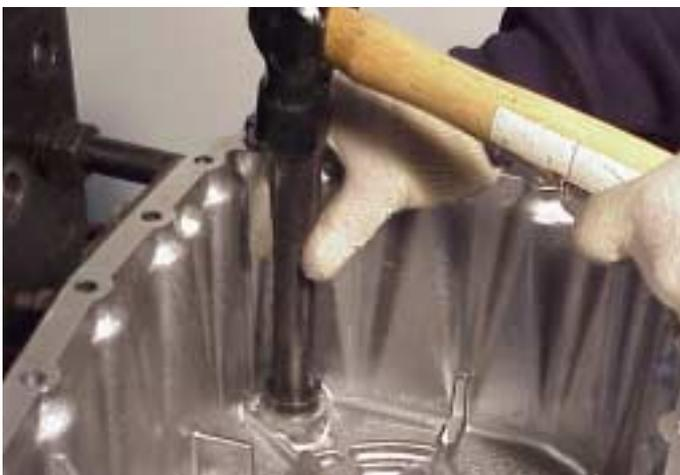
3. Usando la herramienta especial instalar los casquillos del eje selector en las cajas. Guiarlo hasta que este totalmente en su posición.
