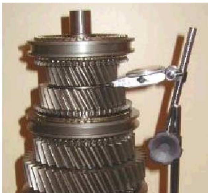
1. El huelgo axial también cabe comprobarlo con el eje principal montado, valiéndose como muestra el grabado de una galga de cuadrante, o de galgas para huelgos. Para ello hay que colocar el conjunto del eje principal sobre un soporte apropiado, colocando la galga sobre el piñón o engranaje y poniendo la galga a Cero. Alzar el engranaje y apuntar la lectura.
