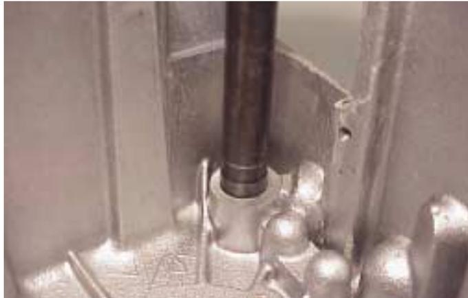
2. Aplicar el sellante loctite 518 si ha sido eliminado e instalar nuevos enchufes de expansión para el eje selector, con la cara rebajada enfrentada por dentro a las cajas interiores.
