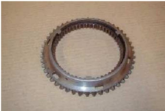
e) Montar el anillo interior del sincronizador en el collarín sincronizador (lengüetas en la parte superior).
