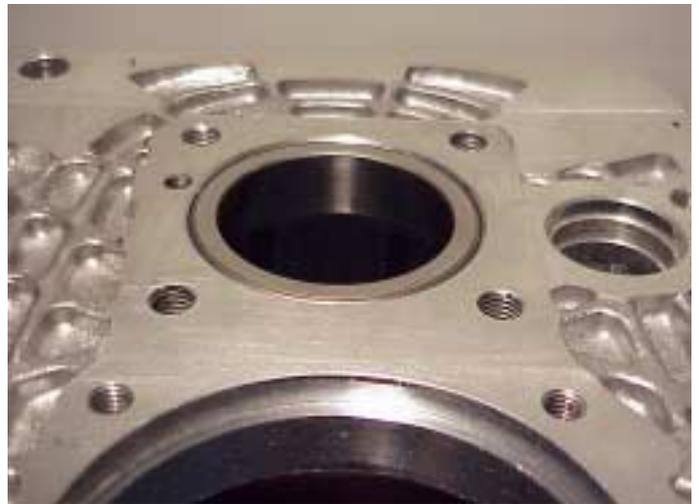
5. Usando la herramienta especial instalar el extremo del cojinete trasero del eje de posición dentro de la caja trasera, desplazarlo hacia dentro hasta que quede justo por debajo de la cara trasera de la caja.
