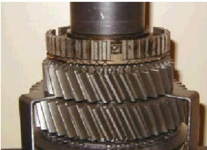
9. Caldear el cubo sincronizador de 3ª/4ª a 85° Centígrados. Montar el cubo sincronizador en las estrías del eje pral., cerciorándose de que las ranuras grandes del cubo quedan alineadas con los hombros grandes del anillo sincronizador. Oprimir a tope hasta el fondo el cubo sincronizador.
