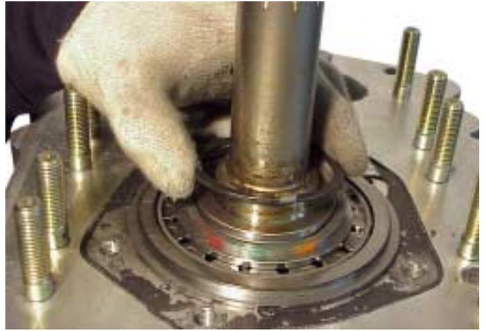
16. Extraer el clip circular exterior del cojinete del eje de entrada.
