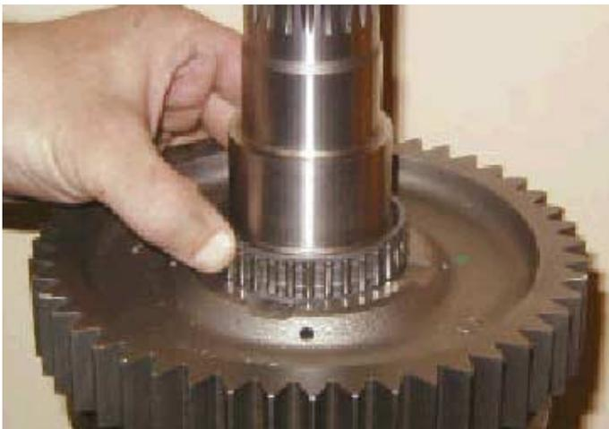
25. Montar y lubricar el cojinete de rodillos en aguja. Montar el engranaje de la 1ª, cerciorándose de que sus estrías engranan como es debido en las del collarín sincronizador.
