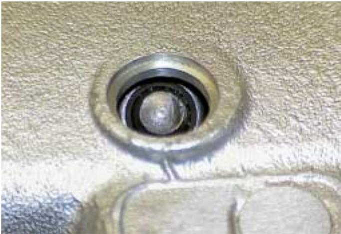
8. Invertir la carcasa, alinear el pin con el surco en la palanca con el orificio del enchufe de expansión.
