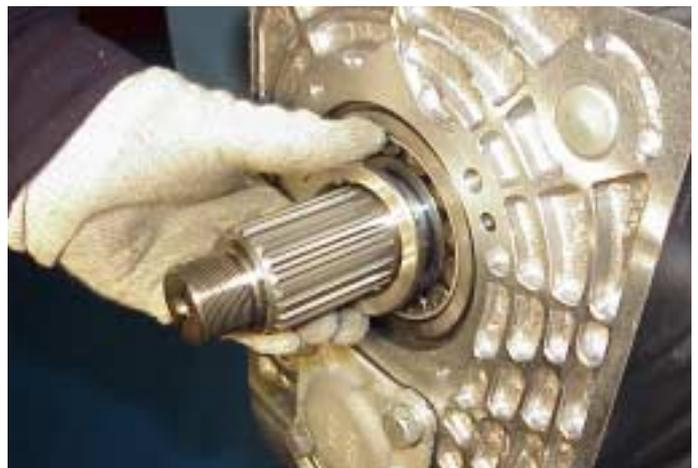
27. Colocar la galga de separación del cojinete a presión en el eje principal por encima del reborde frente al cojinete trasero. Asegurarse de que el surco de aceite queda enfrenteado con los rodillos.
