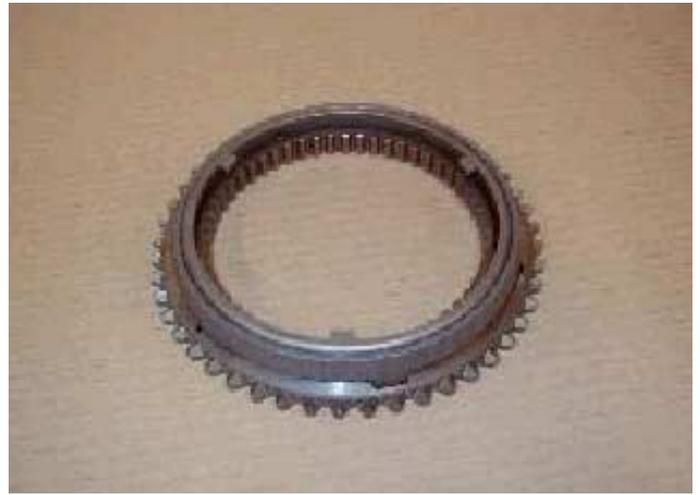
g) Montar el anillo de rozamiento del sincronizador en el collarín de sincronización cerciorándose de que las lengüetas del anillo de rozamiento encajan en las ranuras o estrías del collarín.
