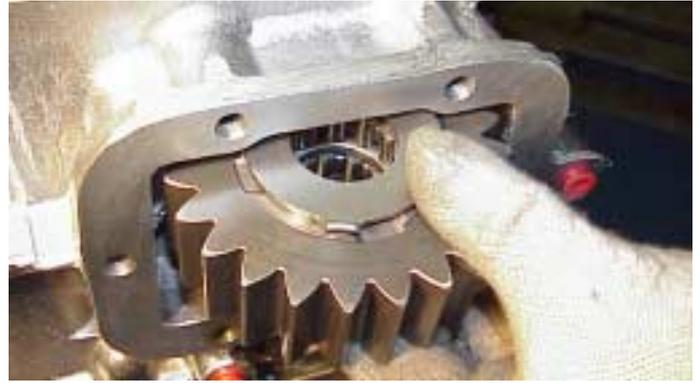
35. Instale los cojinetes y el separador del cojinete en el engranaje inversor MA y posicione el engranaje ensamblado entre las arandelas de empuje y engranado con el engranaje inverso del Eje Secundario y el Primario.
