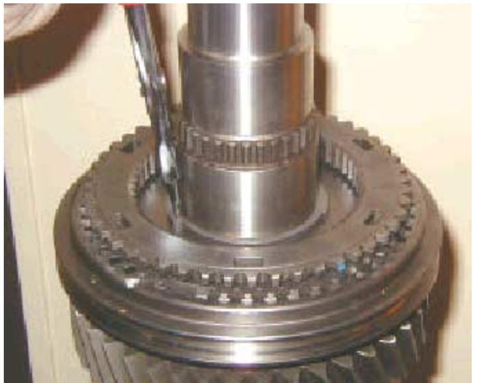
23. Instalar el circlip en la ranura del eje pral., cuidando de no dañar la superficie de apoyo del eje pral.
