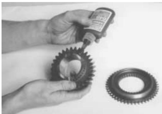
2. Aplique una capa de Loctite 648 a la espina de los dientes del engranaje. Apriete la brida de sincronización para asegurarse de que la brida está, sin duda, en posición. Seque la crema sobrante con un trapito.
