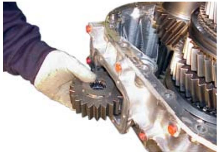
21. Saque el engranaje inversor de la marcha atrás y las arandelas de empuje. Extraiga los cojinetes y el separador del engranaje y la junta tórica del eje - viejo diseño.
