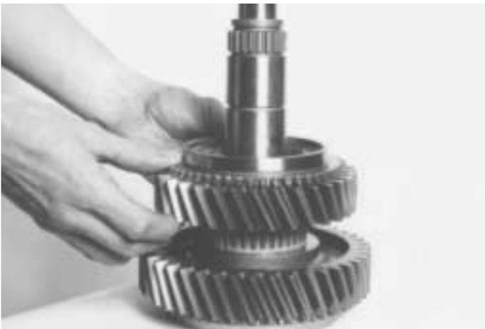
19. Déle la vuelta al eje en el torno. Lubrique e instale el cojinete de la 3a marcha y el conjunto de esta última.
