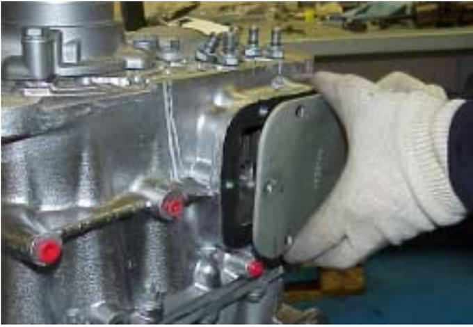
38. Colocar el embrague del engranaje opuesto / placa cubierta de PTO. Apretar los tornillos de cabeza al par correcto (35 a 39 Nm). Aplicar sellante al enchufe de expansión en el taladro del engranaje intermedio opuesto. Fijar el enchufe de expansión.
