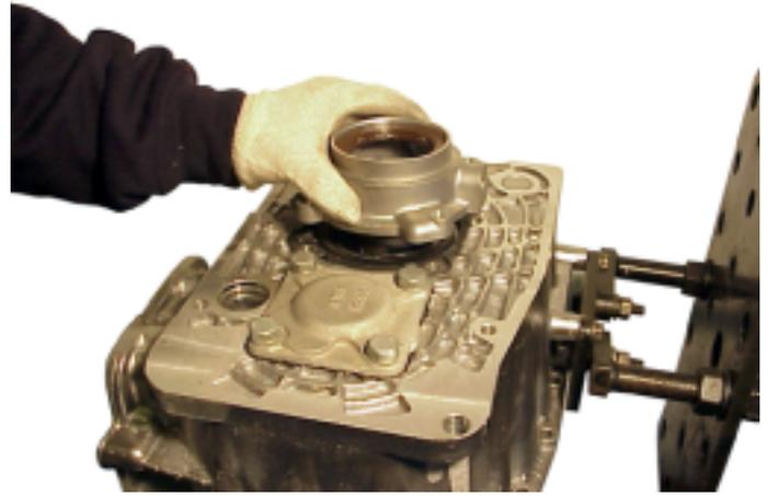
26. Invertir la caja trasera sobre el soporte y extraer los tornillos asegurando la carcasa del velocímetro. Anotar las posiciones de los distintos tornillos de cabeza longitudinal. Extraer la carcasa. En caso necesario sacar la junta para el aceite.
