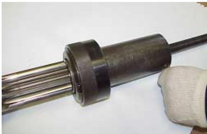
3. Déle la vuelta al eje y saque el rodamiento cónico trasero.
