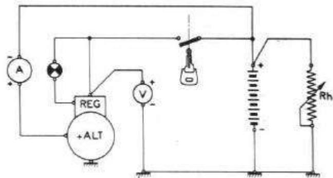
Regulación: Regular el régimen de motor y actuar sobre el reóstato para hacer aumentar la carga.
