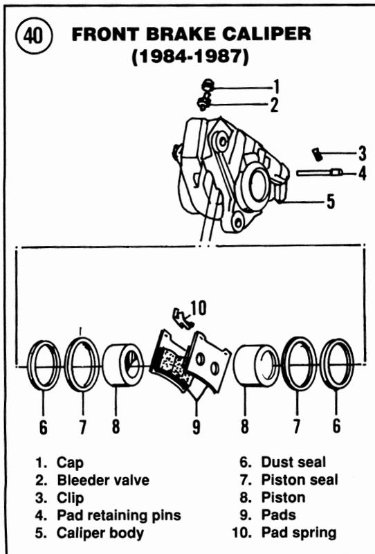
**BRAKE CALIPERS****Front Caliper
